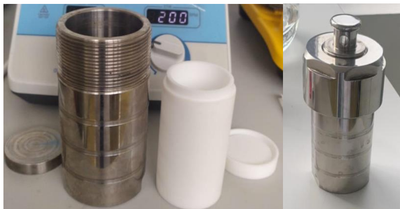
Figura 4. Autoclave solvotérmico de acero inoxidable y recipiente de reacción.
