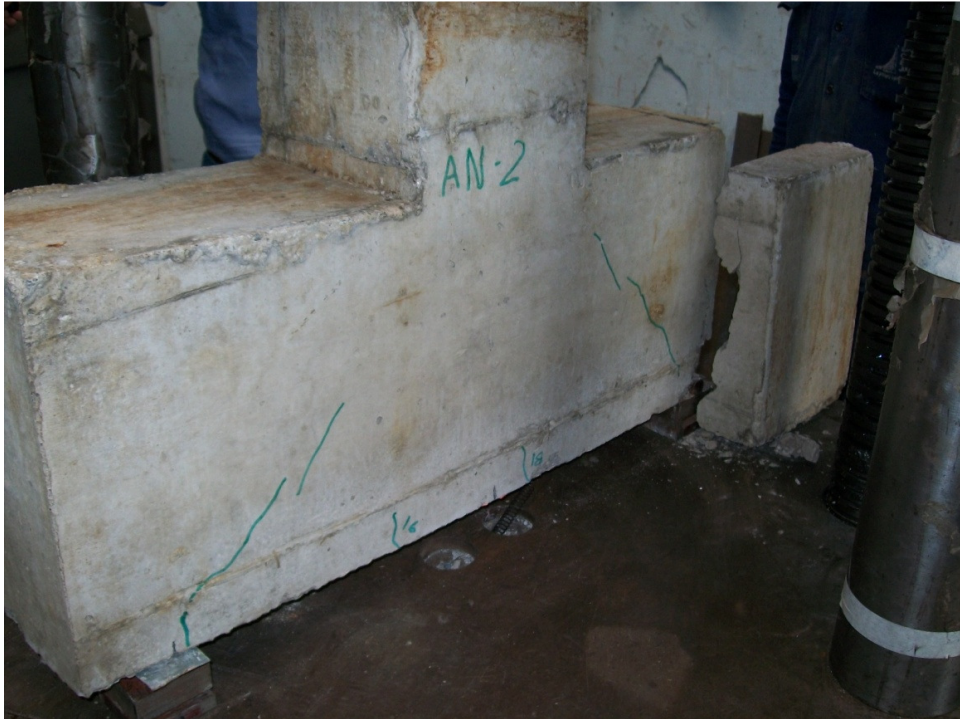
Mecanismo de falla cara 1
