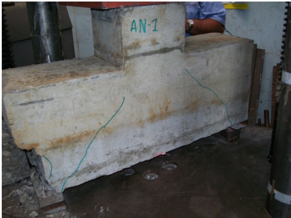
Mecanismo de falla cara 1
