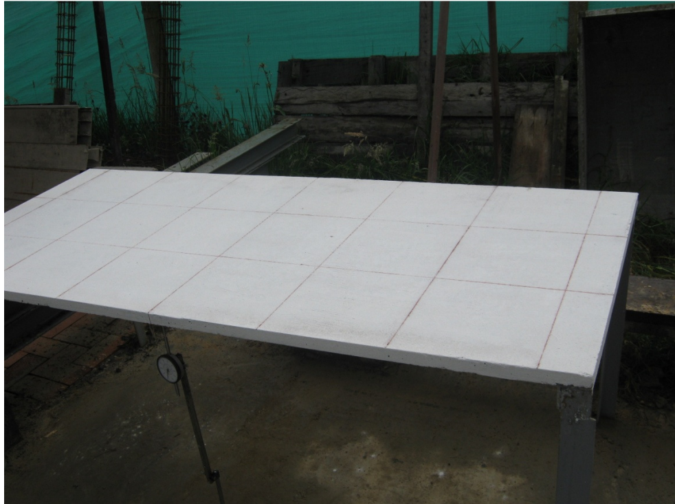
Dibujo de retícula e instalación de deformímetro mecánico
