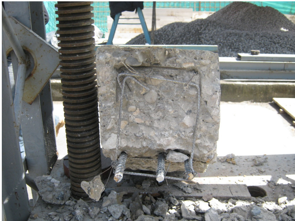
Sección en el apoyo central
