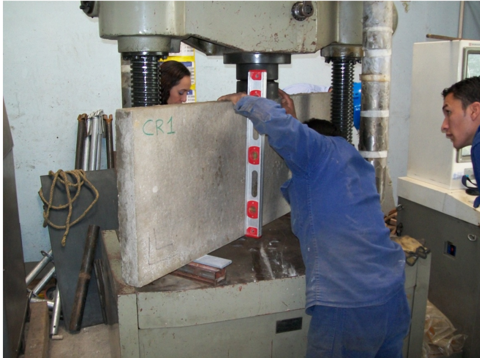
Nivelación de la viga
