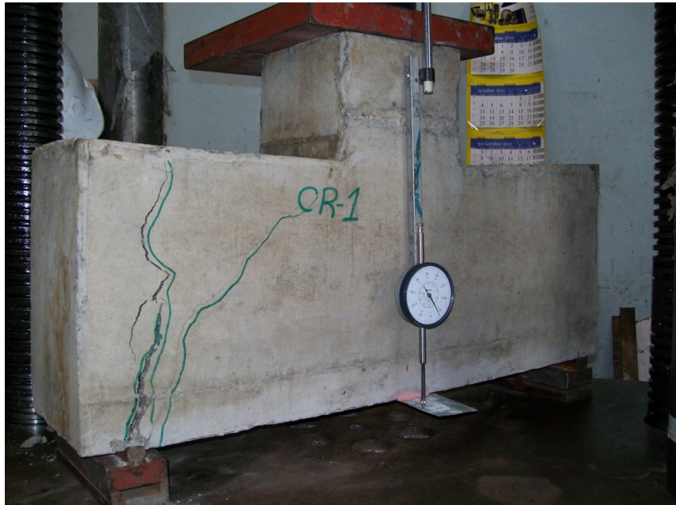
Mecanismo de falla cara 1
