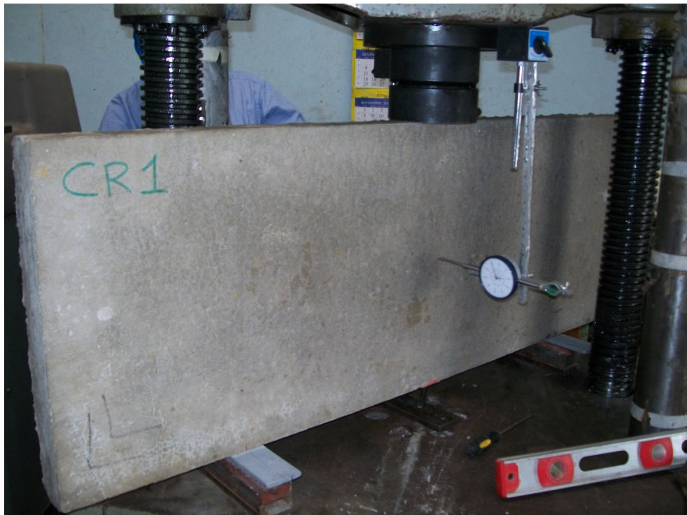
Instalación de deformímetro vertical
