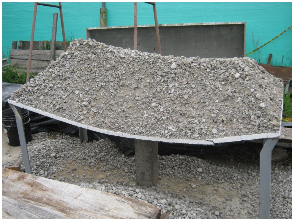
Deformación final de la placa
