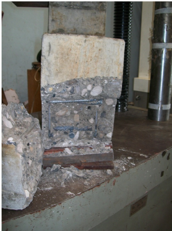
Verificación acero de refuerzo
