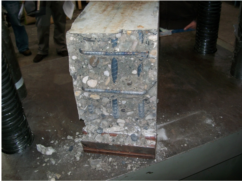
Verificación acero de refuerzo
