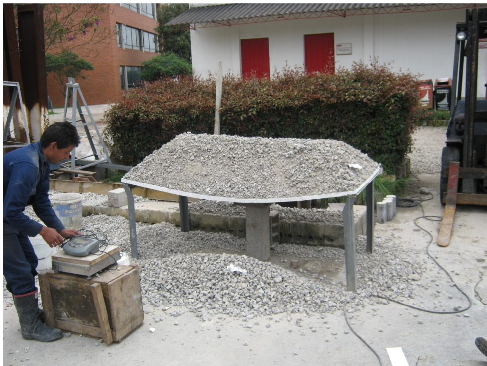
Deformación final de la placa
