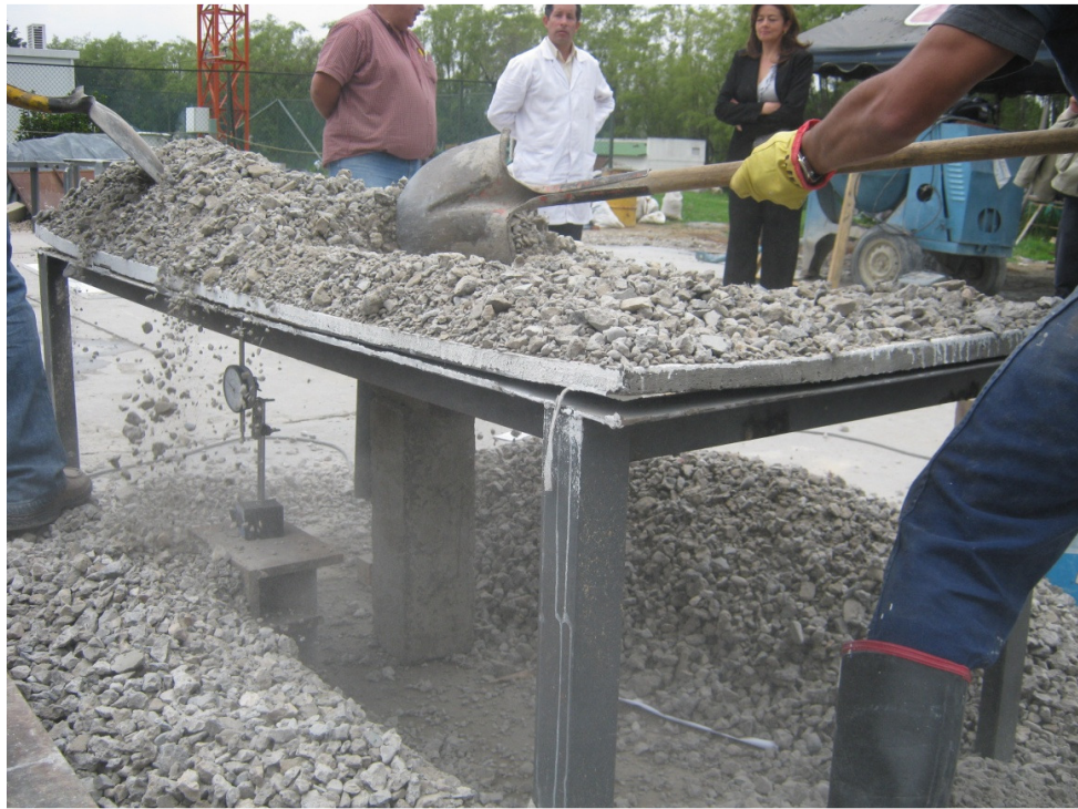
Levantamiento esquina y vista deformímetro apoyo longitudinal
