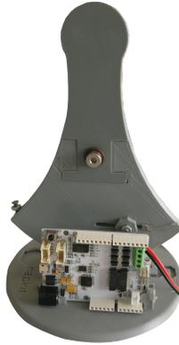
Figura 3.1: Hapkit: Un grado de libertad háptica: Es el canal de interacción física y cognitiva, cuenta con 3 grados de libertad de traducción (DOF).
