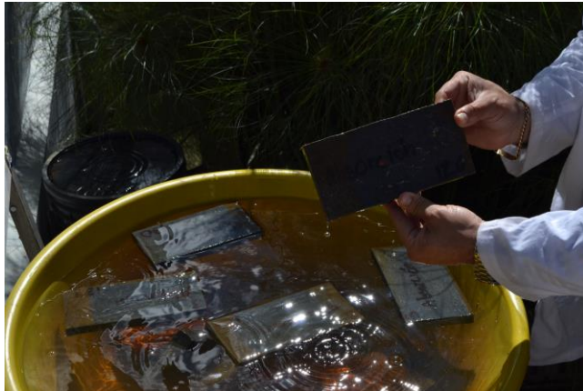
Figura 17 Ensayo de Absorción en sumersión de H2O
