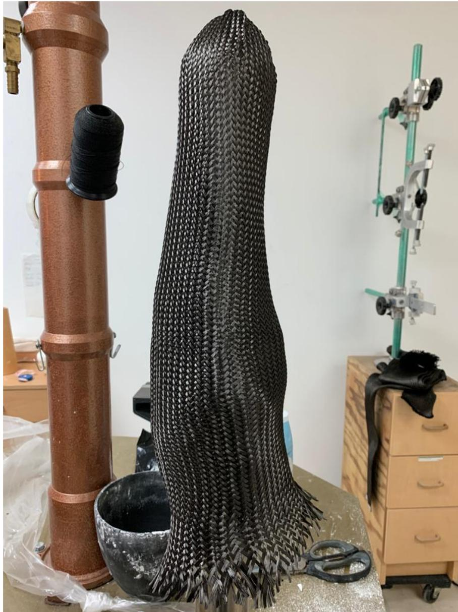
Anexo 2. Colocación de la fibra de carbono sobre la prótesis.
