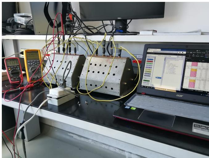
**Figura 5-8:** Disposición de equipos y carga para proceso de calibración.
