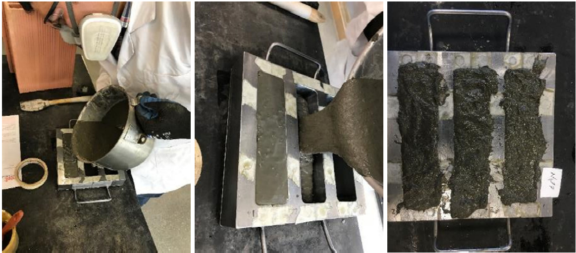
Figura 4-20. Vaciado del UHPFRC en los moldes. Fuente: El autor.
