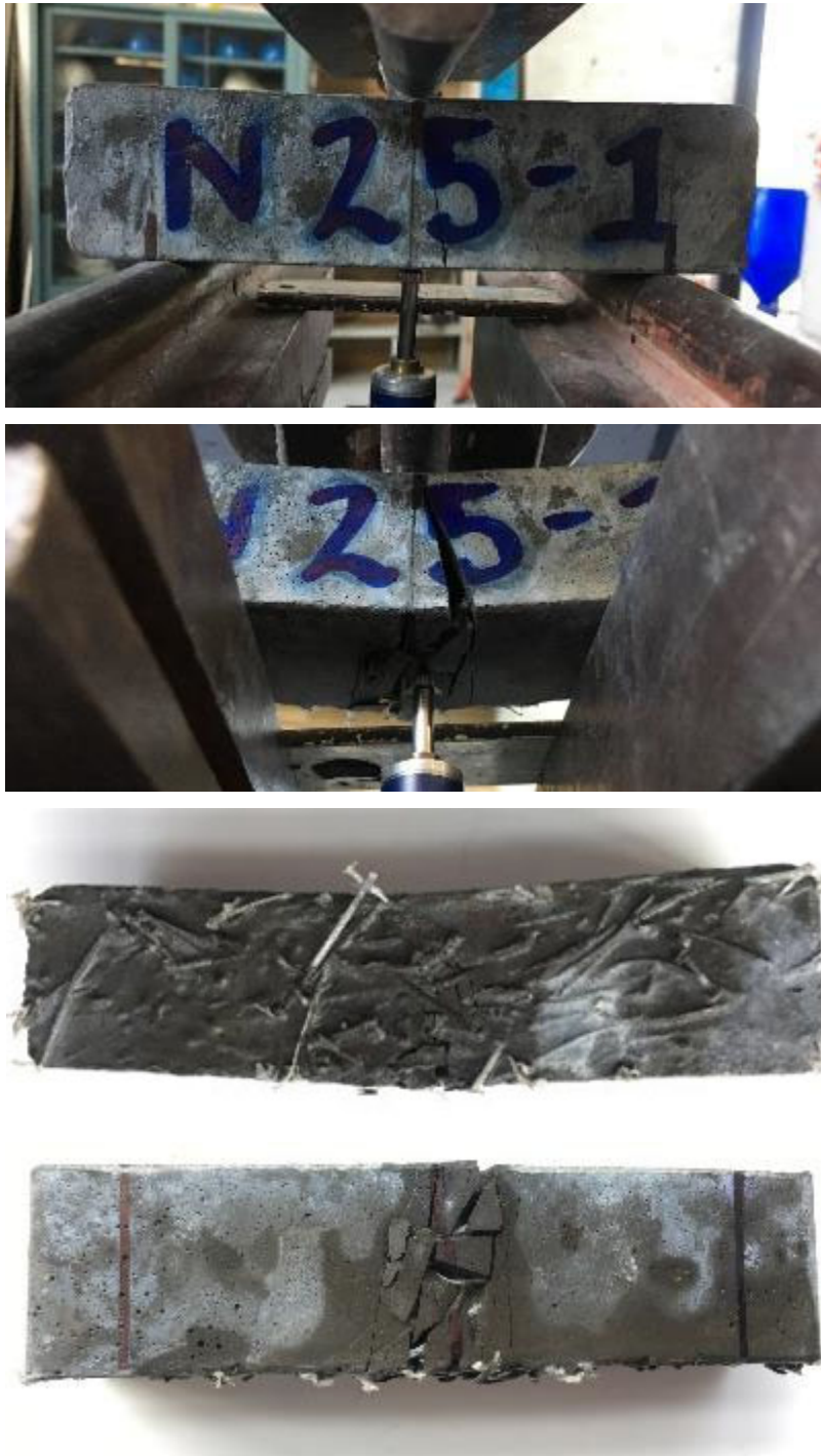
Figura 5-7. Probeta de UHPFRC reforzada con 0.5% de micro-fibras de nylon y 1.5% de macro-fibras de polipropileno en volumen. Probeta con endurecimiento por deflexión y con múltiple fisuración. Fuente: El autor.
