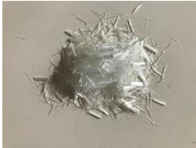
Figura 4-8. Micro-fibra polimérica de polivinilo de alcohol (PVA). Fuente: El autor.
