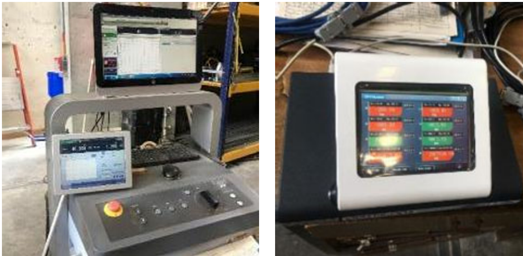
Figura 5-6. Dispositivo de control y registro de la maquina universal y LVDT. Fuente: El autor.
