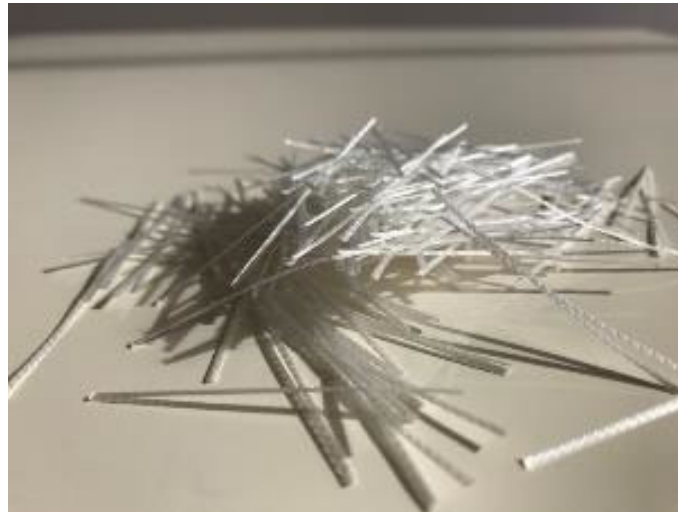
Figura 4-10. Macro-fibra polimérica de polipropileno (PP). Fuente: El autor.
