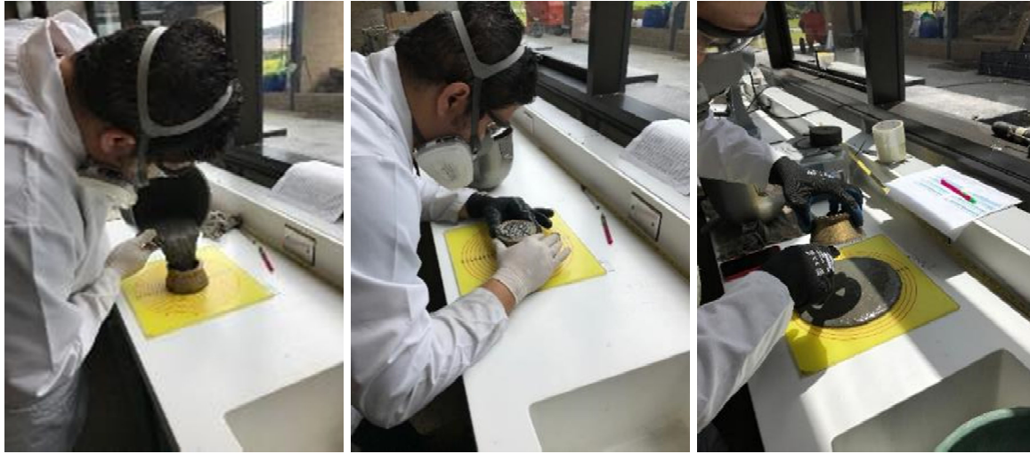
Figura 4-19. Toma del flujo estático mezcla de UHPFRC. Fuente: El autor.
