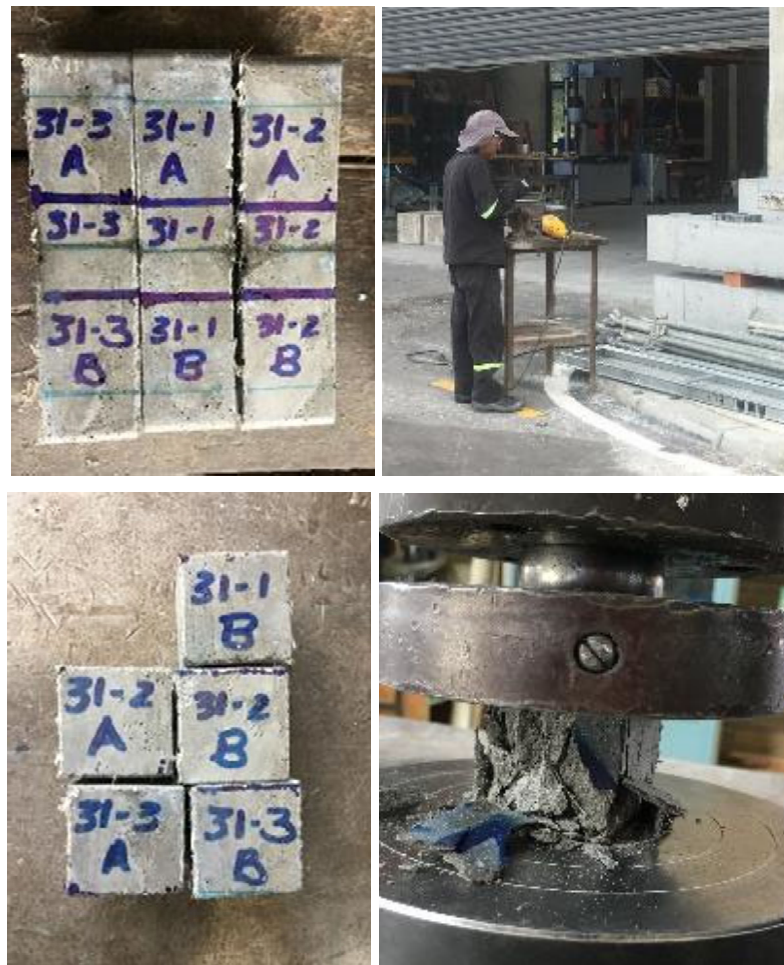
Figura 5-8. Rotulado y corte de probeta de UHPFRC para ensayo a compresión. Fuente: El autor.
