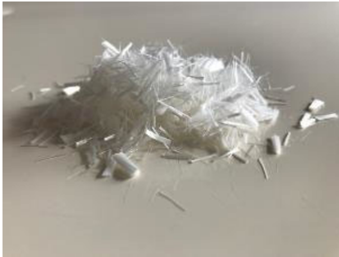
Figura 4-7. Micro-fibra polimérica de Nylon. Fuente: El autor.
