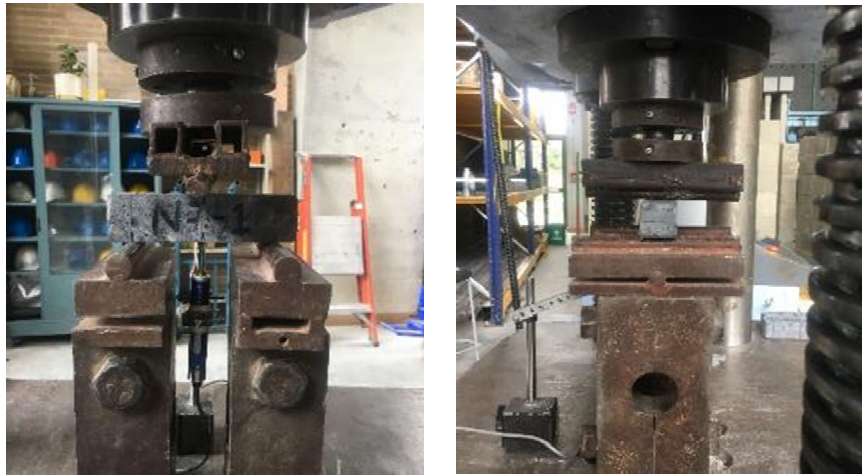
Figura 4-22. Montaje de dispositivo de carga para ensayo a flexión en tres puntos. Fuente: El autor.
