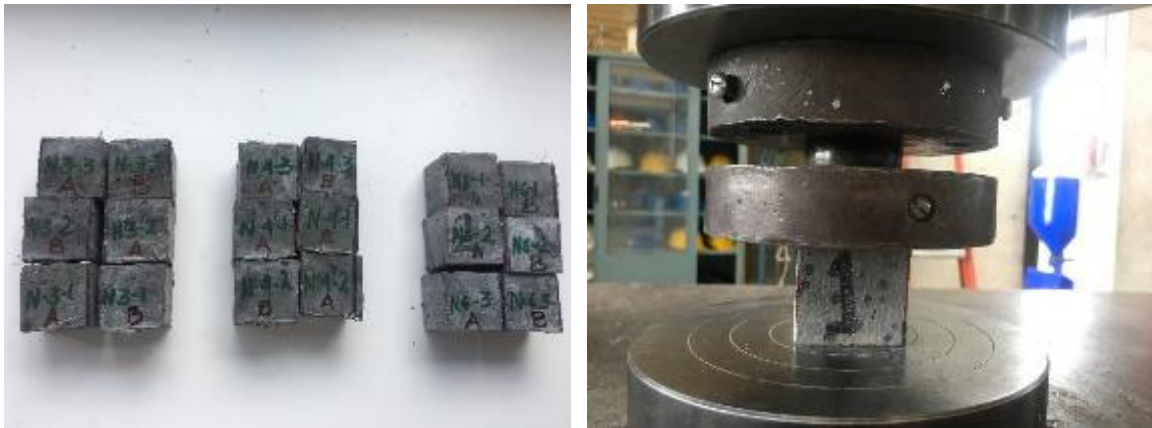
Figura 4-24. Resistencia a compresión. A la izquierda muestra de cubos de UHPFRC y a la derecha montaje del dispositivo de carga para el ensayo a compresión. Fuente: El autor.
