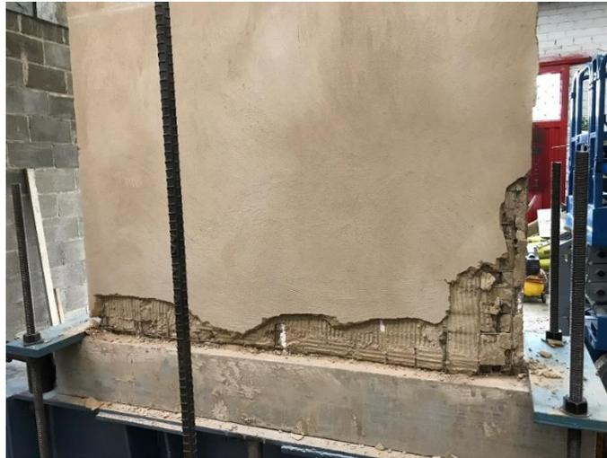
*(b) Detalle de las fisuras en la base del panel*
