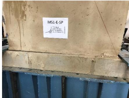
*(a) Detalle falla tensión-compresión cara frontal del panel*
