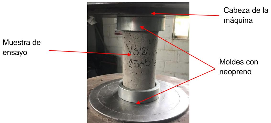
*Fotografía 5-7 Montaje del ensayo de resistencia a la compresión en cilindros de concreto.*
