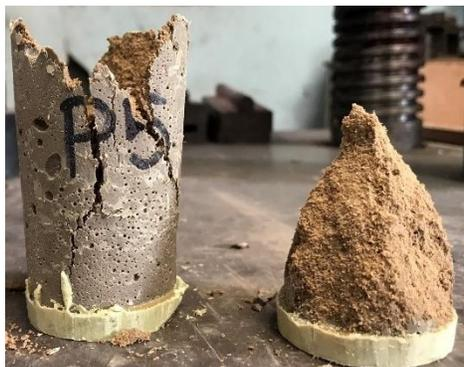
*Fotografía 6-1 Falla de los cilindros de mortero durante el ensayo de compresión.*
