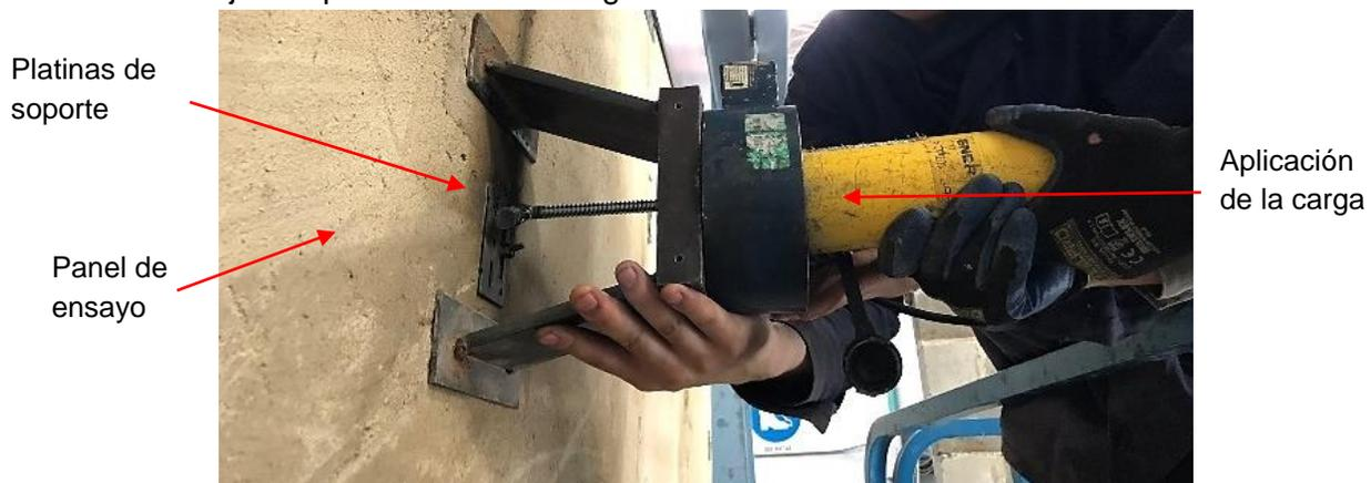
**Fotografía 6-10** Montaje de ensayo de extracción de anclajes mecánico
