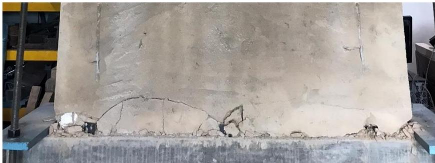
*(b) Fractura en la zona de compresión-tensión*
