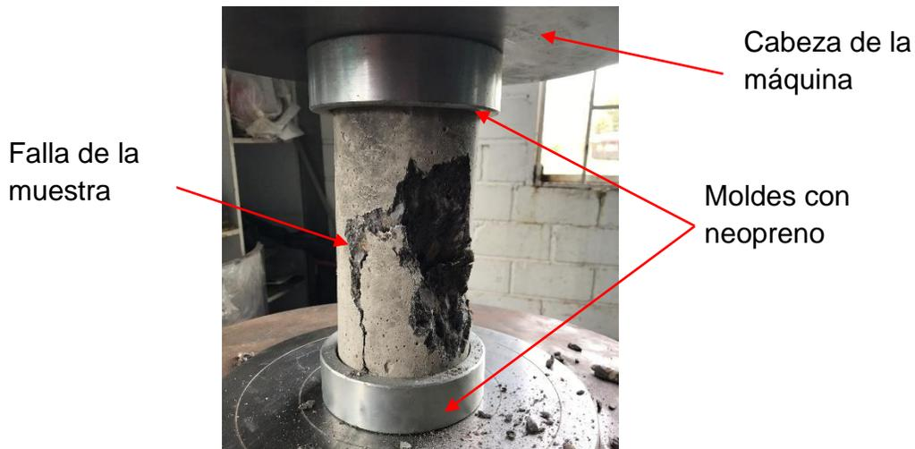
*Fotografía 6-2 Falla de los cilindros de concreto durante el ensayo de compresión.*
