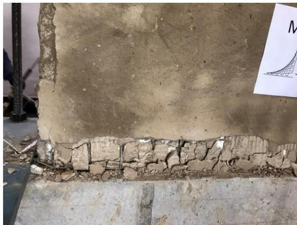
(b) Aplastamiento del mortero en la zona de compresión
