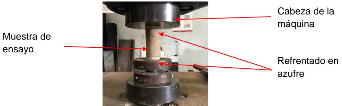
*Fotografía 5-6 Montaje del ensayo de resistencia a compresión en cilindros de mortero.*
