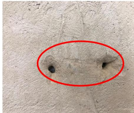
(d) Extracción de anclaje de dos puntos
