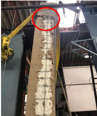
(c) Agrietamiento del panel contra la viga de borde
