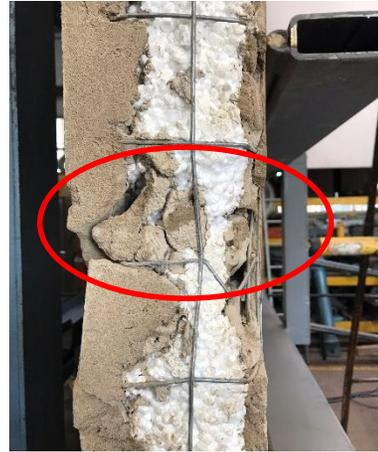
(f) *Espesores de mortero variable*
