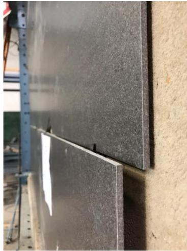
*(a) Fisuras en la base del panel*
