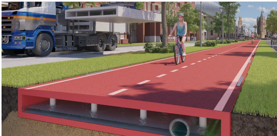
Figura 59. Vías recicladas PlasticRoad
