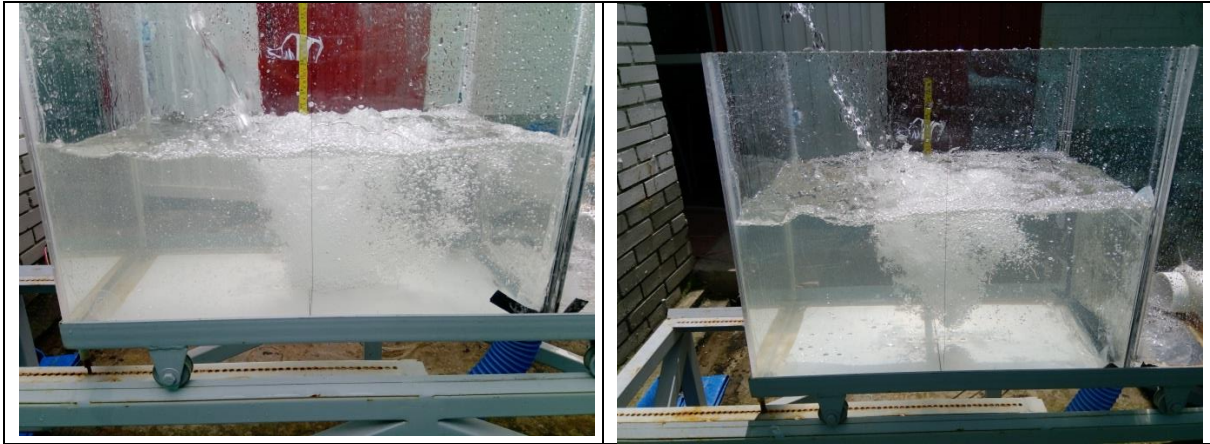
Figura 104.: Inmersión de chorros tipo 8, inmersión para 216mm (Vista Lateral), inmersión para 300mm (Vista Lateral).
