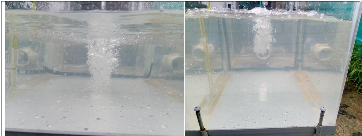
Figura 82: Inmersión de chorros tipo 1, inmersión para 125mm (Vista Posterior), inmersión frontal para 300mm (Vista Posterior).
