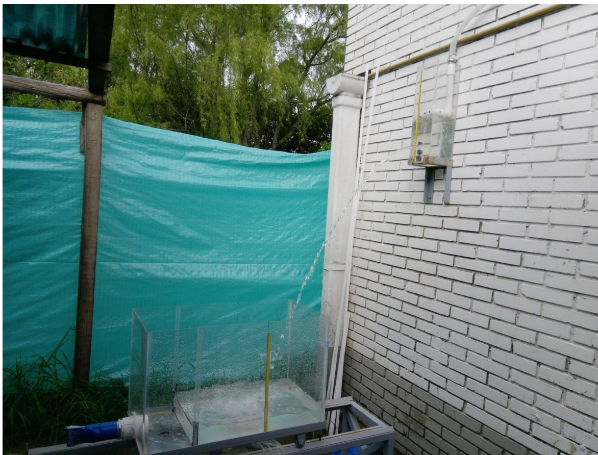
Figura 75: Trayectoria Chorro \phi 0.75'' , 0.25\text{l/s} < Q < 0.35\text{l/s} para colchón de 80mm.
