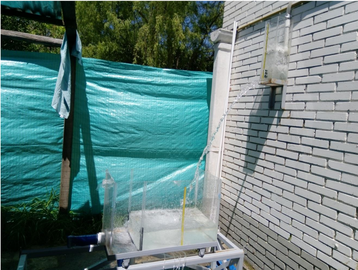
Figura 79: Trayectoria Chorro \phi 1.25'' , 0.68\text{l/s} < Q < 0.89\text{l/s} para colchón de 137mm.
