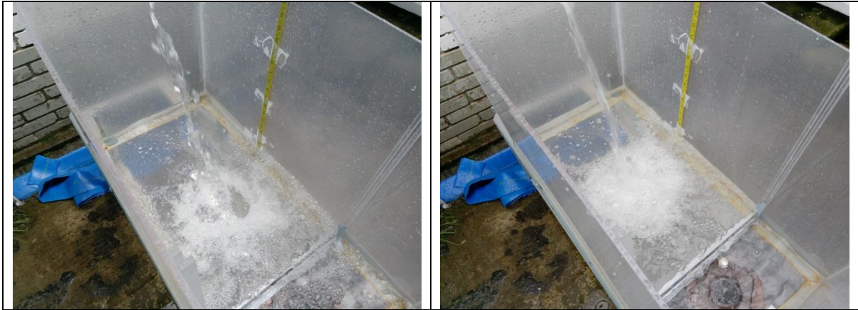
Figura 99: Inmersión de chorros tipo 7, inmersión para 30mm (Vista Superior), inmersión para 40mm (Vista Superior).
