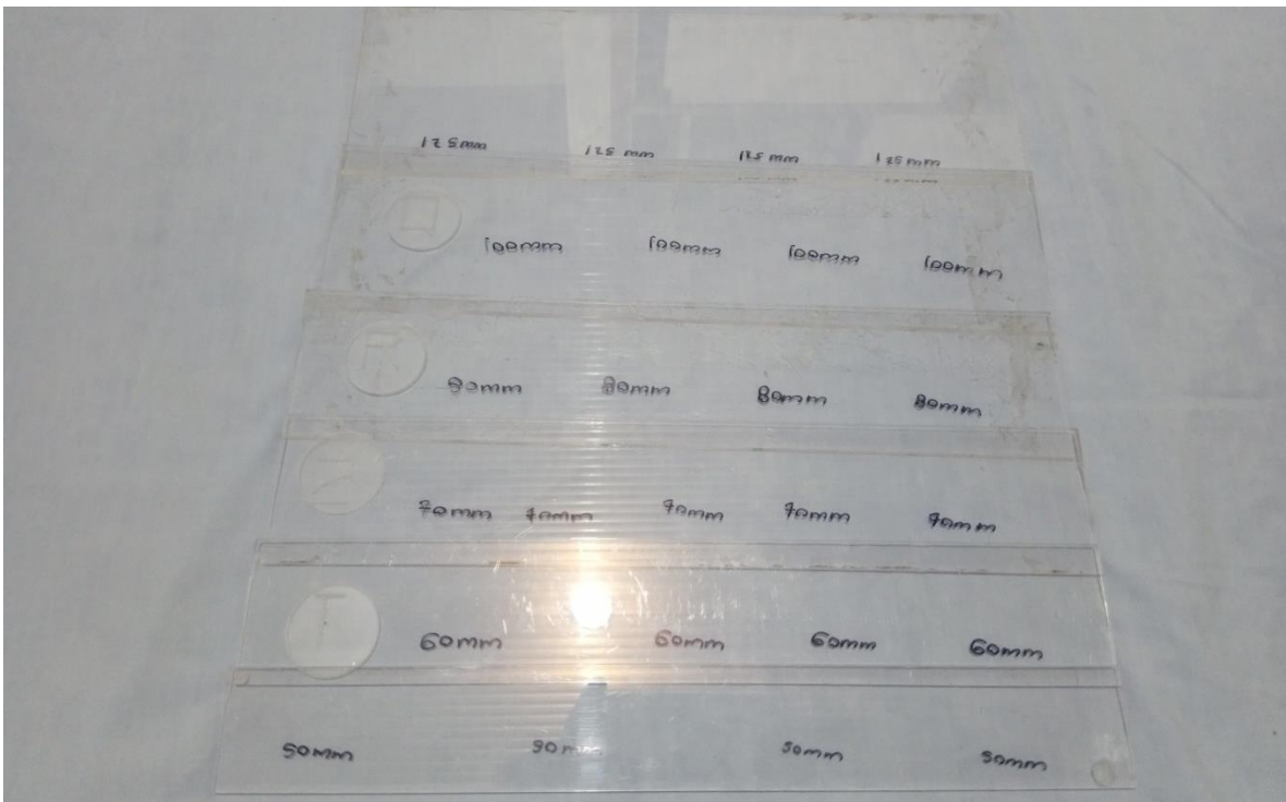
Figura 58: Láminas en acrílico entre los 50mm y los 125 mm para elaborar los colchones de agua.
