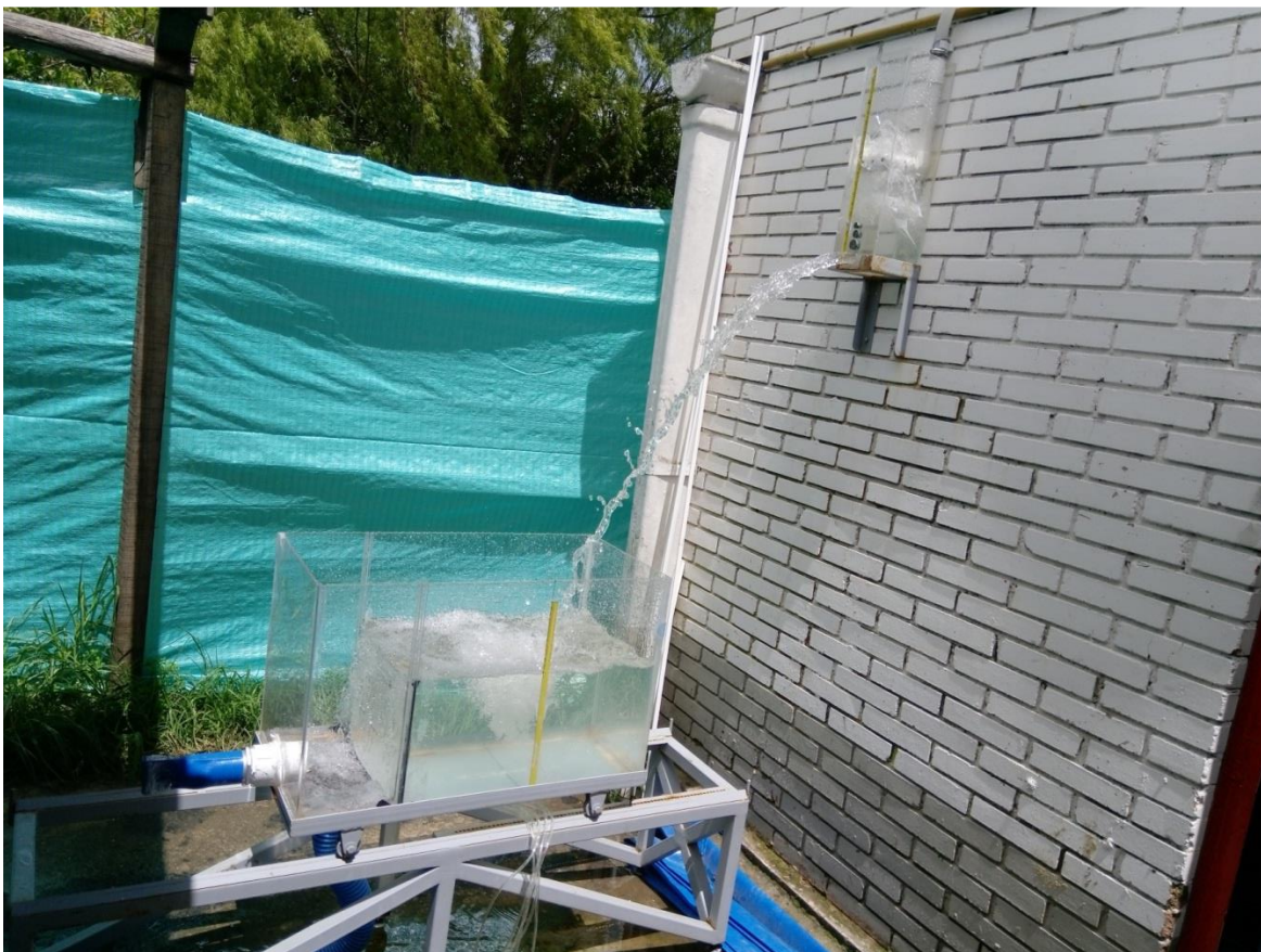
Figura 80: Trayectoria Chorro \phi 1.25", 0.87\text{l/s} < Q < 0.97\text{l/s} para colchón de 280mm
