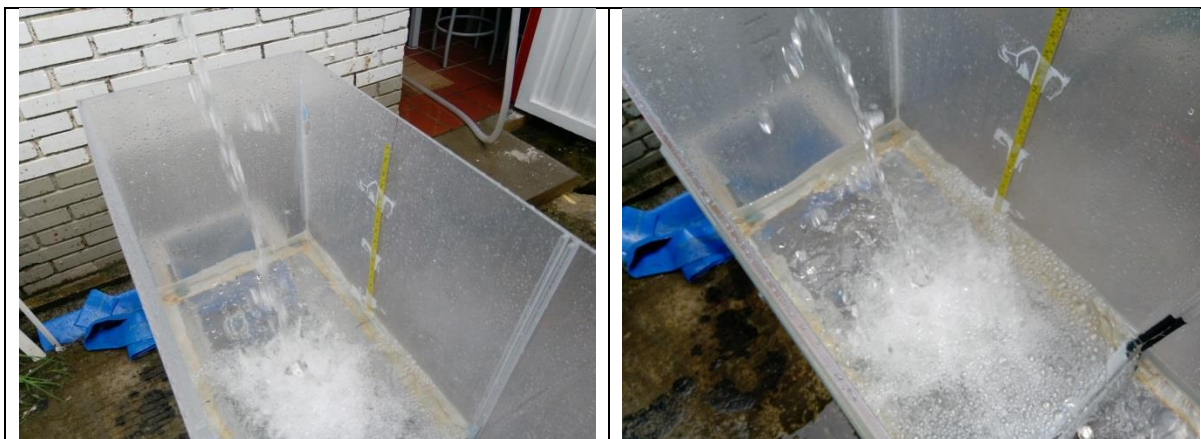
Figura 102: inmersión de chorros tipo 8, inmersión para 40mm (Vista Superior), inmersión para 50mm (Vista Superior).
