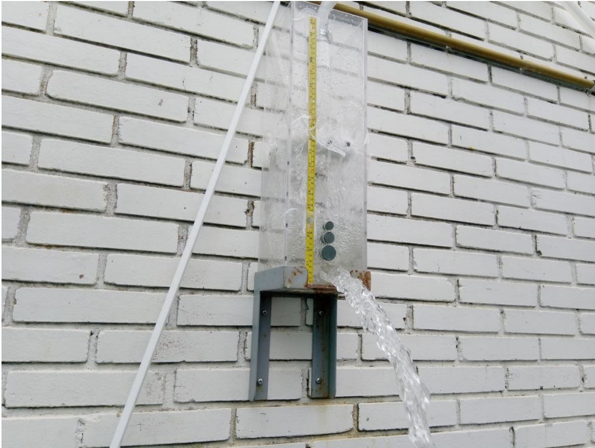
Figura 71: Chorro \phi 1.25'' , 0.68l/s < Q < 0.89l/s para colchón de 125mm.
