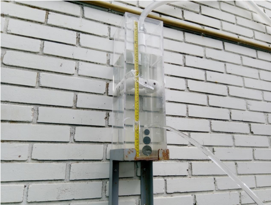
Figura 66: Chorro \phi 0.5'' , 0.16\text{ l/s} < Q < 0.21\text{ l/s} para colchón de 250mm
