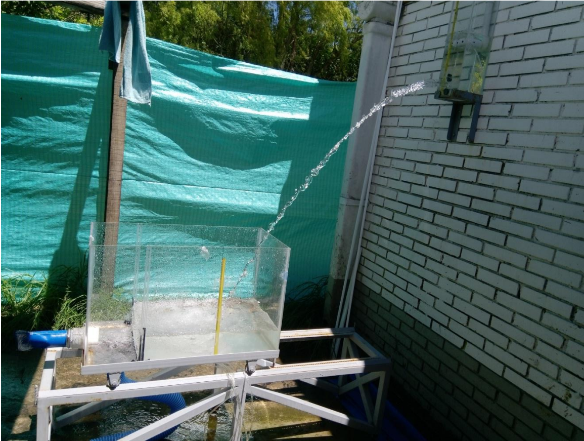
Figura 78: Trayectoria Chorro \phi 1", 0.60\text{l/s} < Q < 0.83\text{l/s} para colchón de 112mm.
