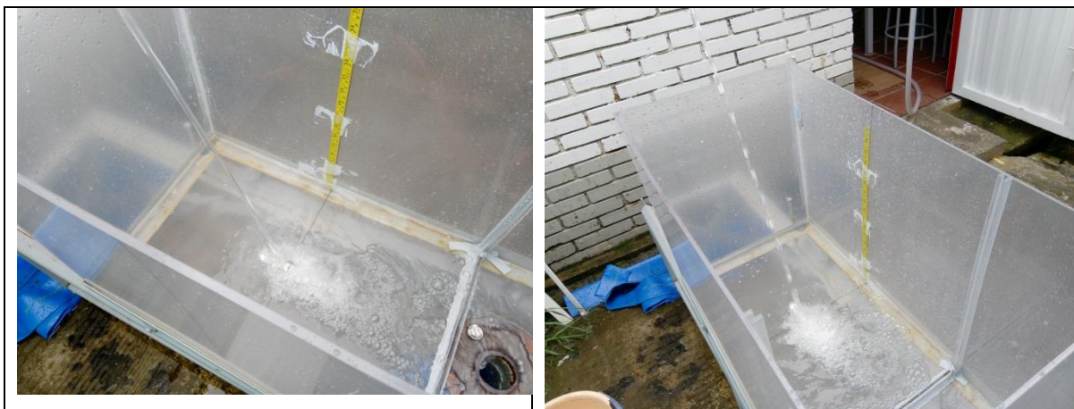
Figura 81: Inmersión de chorros tipo 1, inmersión para 25mm (Vista Superior), inmersión para 30mm (Vista Superior).
