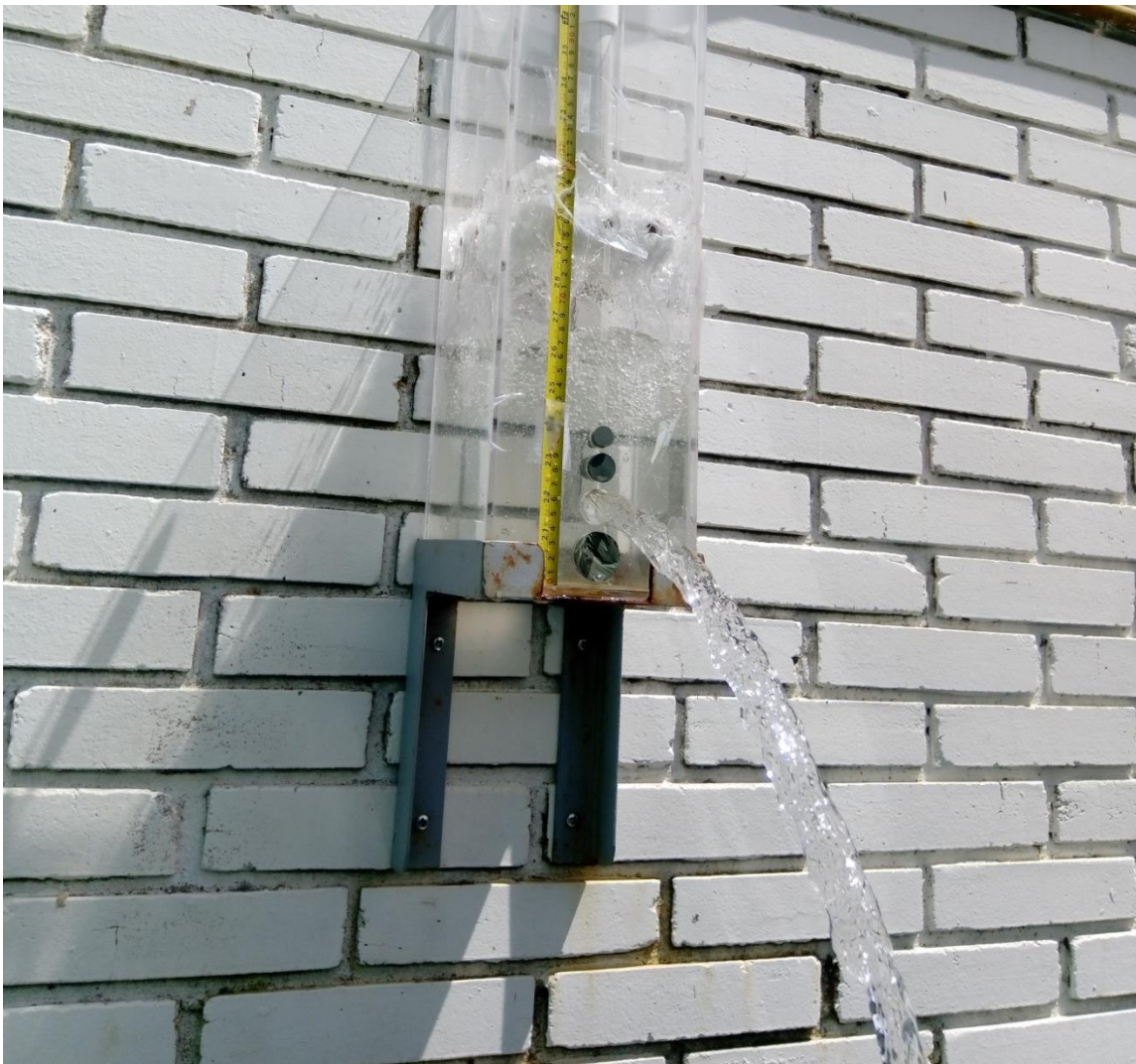
Figura 69: Chorro \phi 1'' , 0.48\text{l/s} < Q < 0.69\text{l/s} para colchón de 87mm.
