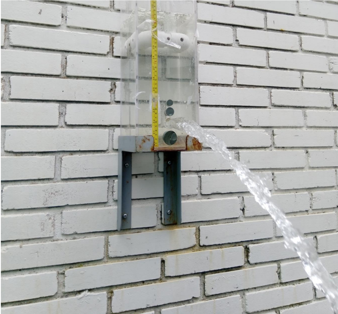
Figura 70: Chorro \phi 1", 0.60\text{l/s} < Q < 0.83\text{l/s} para colchón de 112mm.
