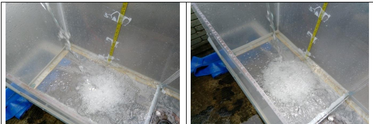
Figura 93: Inmersión de chorros tipo 5, inmersión para 30mm (Vista Superior), Inmersión para 40mm (Vista Superior)
