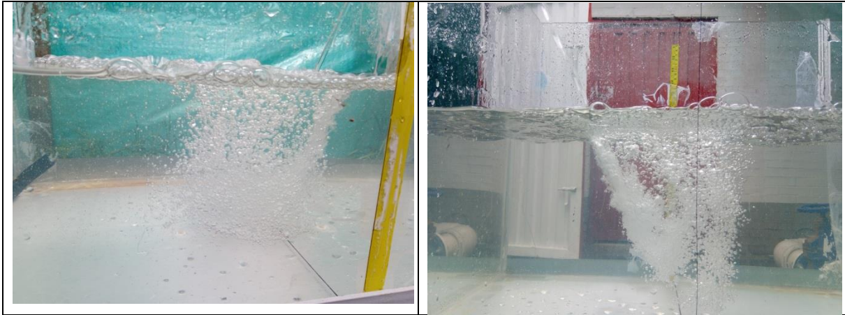
Figura 86 Inmersión de chorros tipo 2, inmersión para 150mm (Vista Lateral), Inmersión para 230mm (Vista Lateral).
