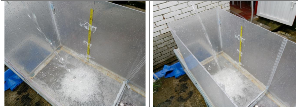
Figura 96: inmersión de chorros tipo 6, inmersión para 30mm (Vista Superior), inmersión para 40mm (Vista Superior).
