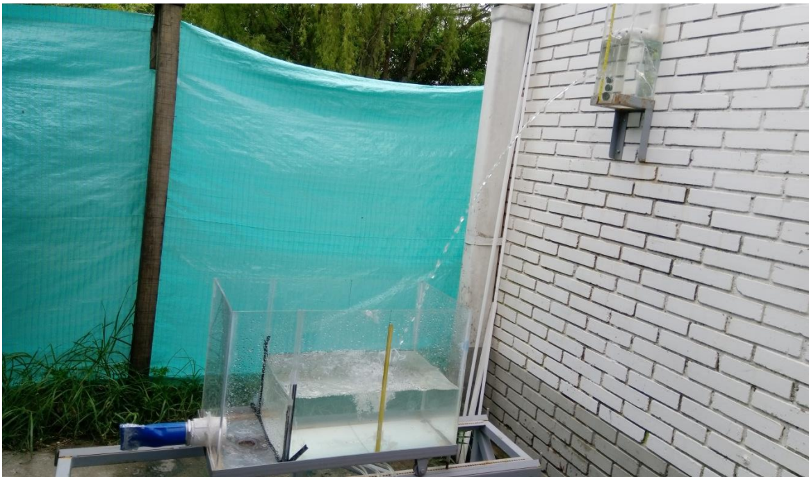
Figura 73: Trayectoria Chorro \varnothing 0.5'' , 0.11\text{l/s} < Q < 0.15\text{l/s} para colchón de 216mm.
