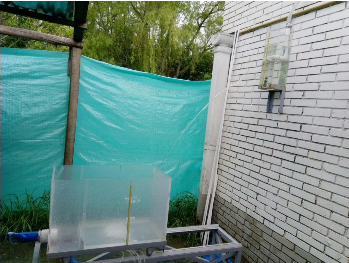
Figura 74: Trayectoria Chorro \phi 0.5", 0.16\text{l/s} < Q < 0.21\text{l/s} para colchón de 40mm.
