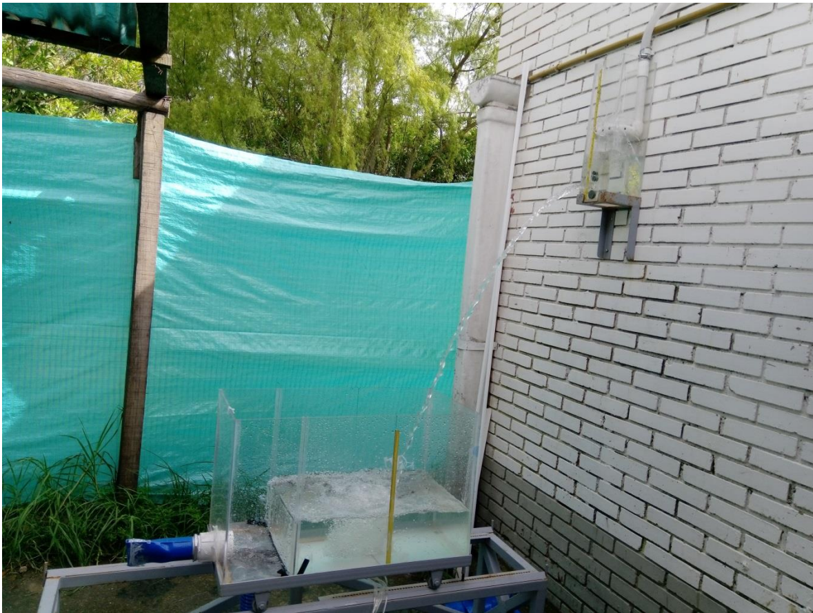
Figura 77: Trayectoria Chorro \phi 1'' , 0.48\text{l/s} < Q < 0.69\text{l/s} para colchón de 175mm.
