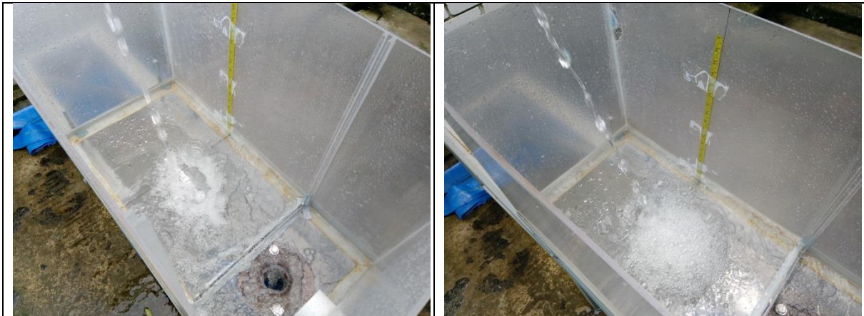
Figura 90: Inmersión de chorros tipo 4, inmersión para 30mm (Vista Superior), inmersión para 40mm (Vista Superior)
