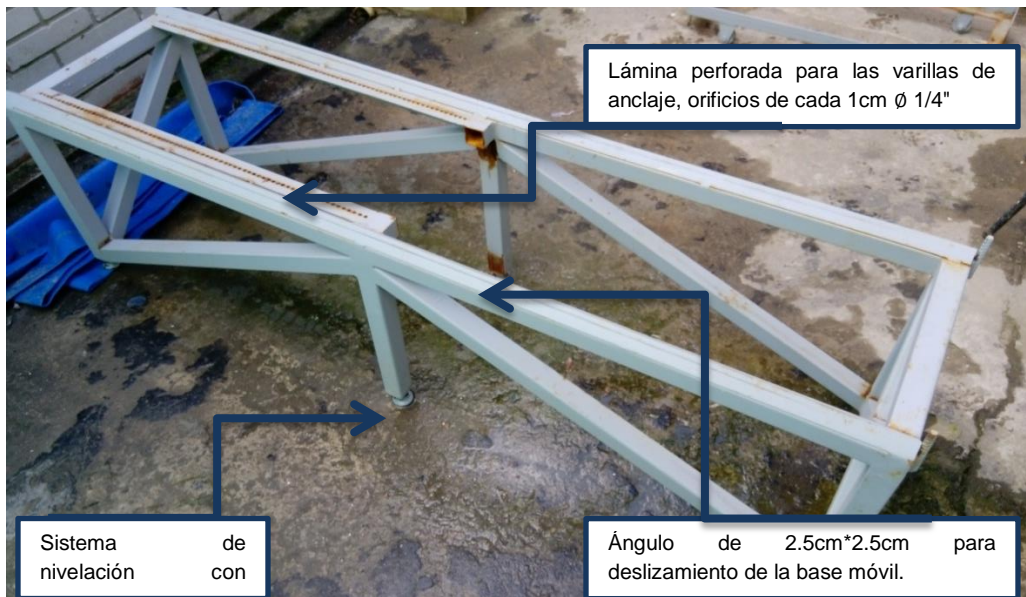
Figura 52: Estructura estática de soporte para la caja en acrílico.
