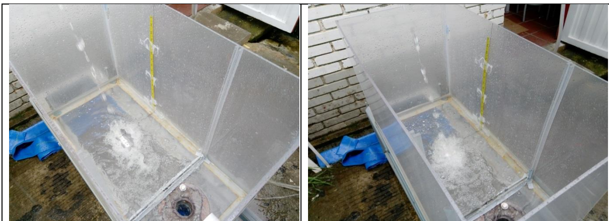
Figura 87: Inmersión de chorros tipo 3, inmersión para 25mm (vista superior), inmersión para 30mm (Vista superior).
