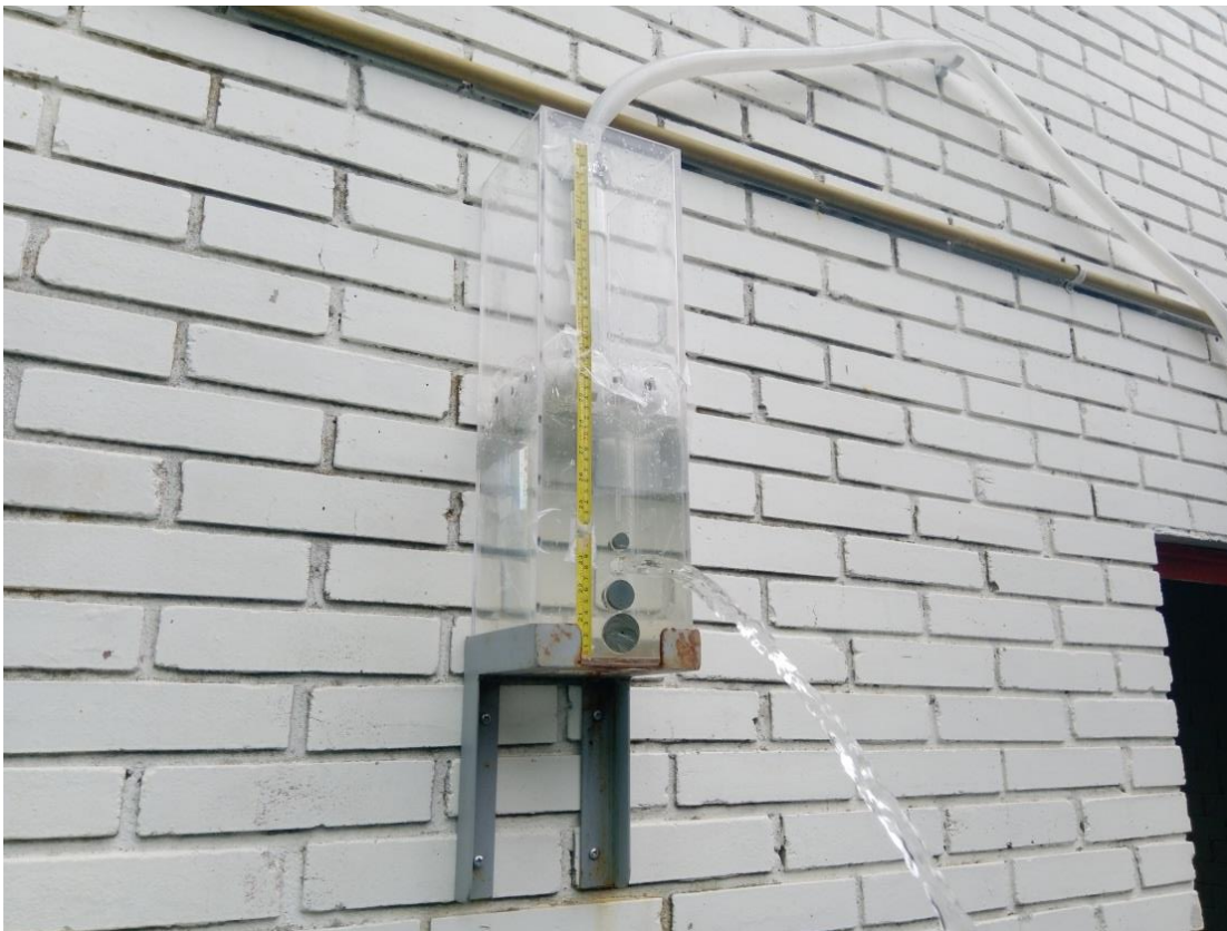
Figura 67: Chorro \phi 0.75'' , 0.25\text{l/s} < Q < 0.35\text{l/s} para colchón de 300mm
