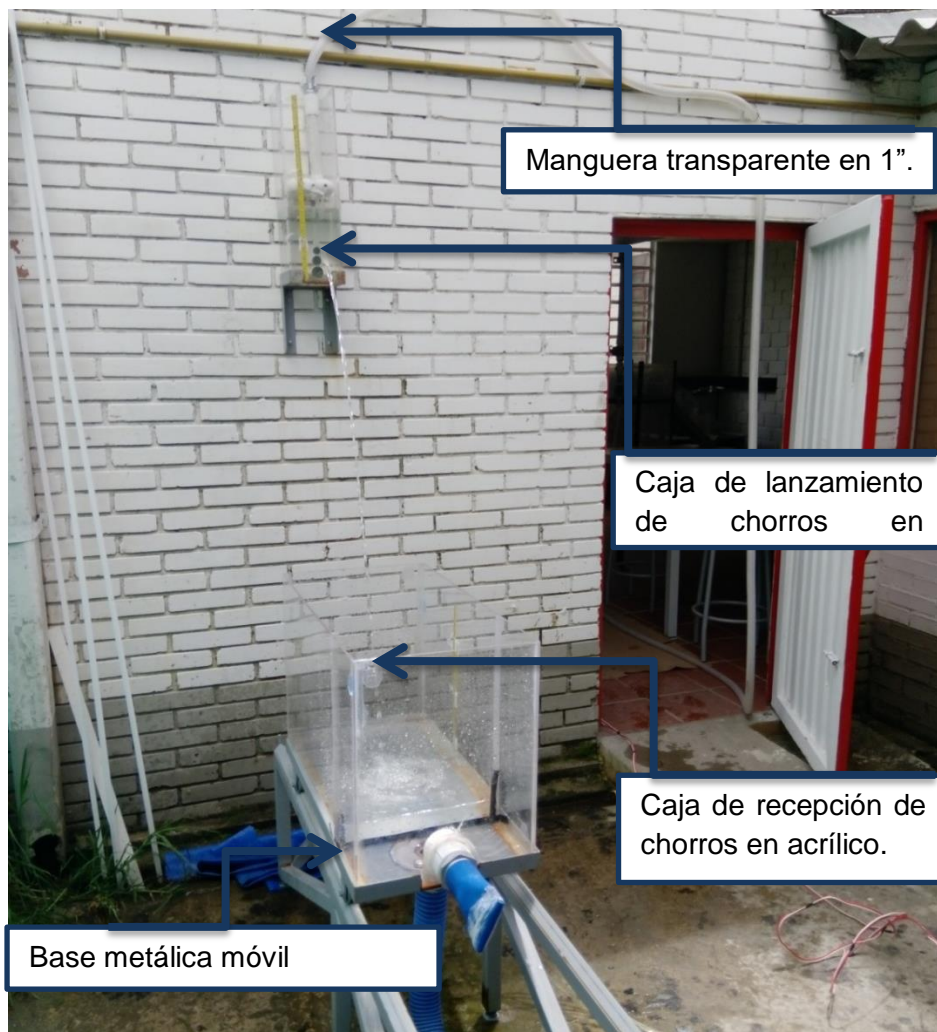
Figura 45: Montaje experimental de abastecimiento e impacto de chorros
