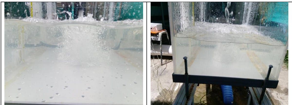
Figura 97: Inmersión de chorros tipo 6, inmersión para 125mm (Vista Posterior), inmersión para 166mm (Vista Posterior)
