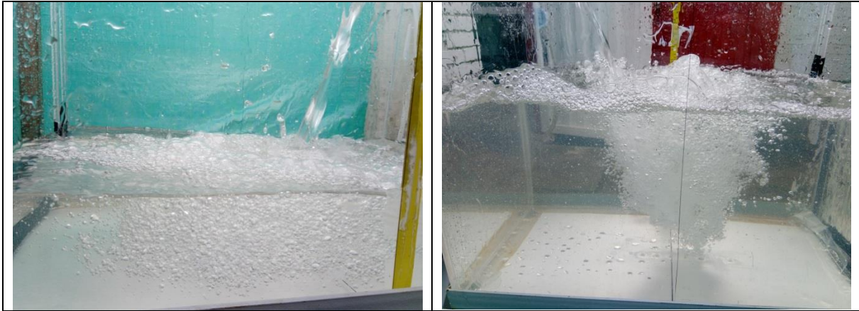
Figura 101: Inmersión de chorros tipo 7, inmersión para 80mm (Vista Lateral), inmersión para 266mm (Vista Lateral).
