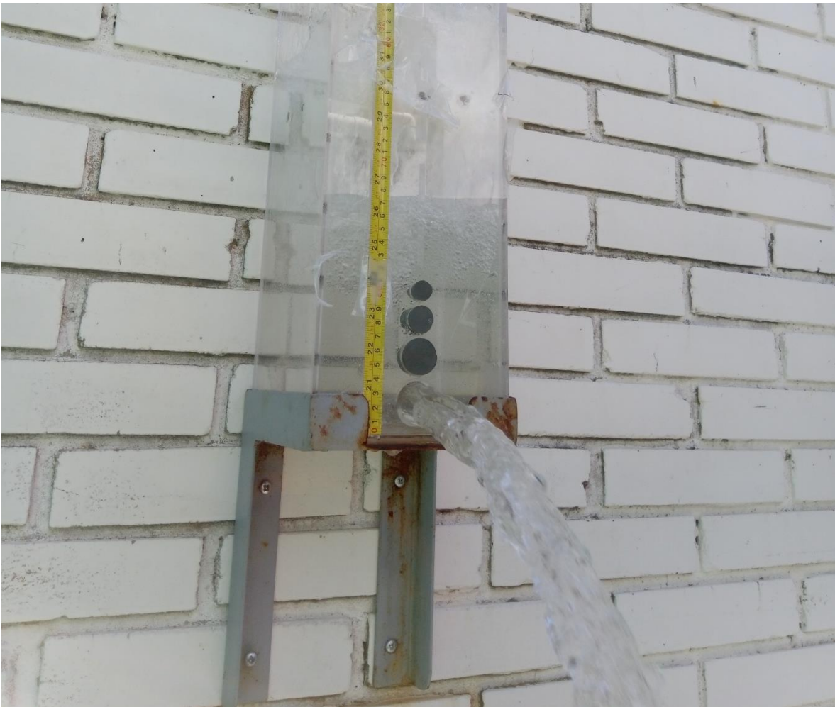
Figura 72: Chorro \phi 1.25", 0.87\text{l/s} < Q < 0.97\text{l/s} para colchón de 125mm.
