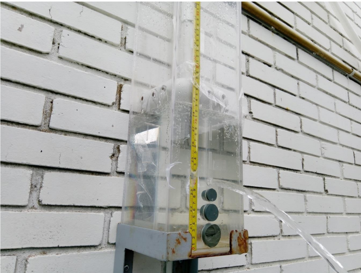
Figura 65: Chorro \phi 0.5'' , 0.11\text{l/s} < Q < 0.15\text{l/s} para colchón de 100 mm
