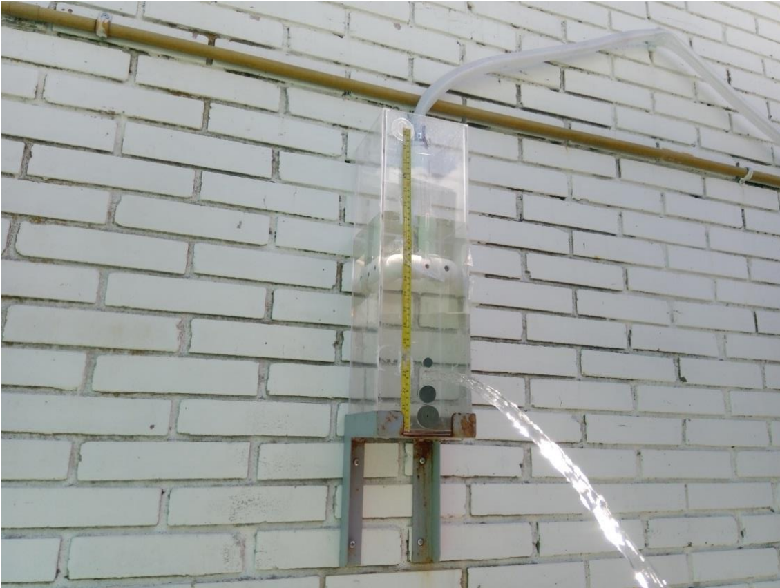
Figura 68: Chorro \phi 0.75'' , 0.39\text{l/s} < Q < 0.46\text{l/s} para colchón de 112mm.
