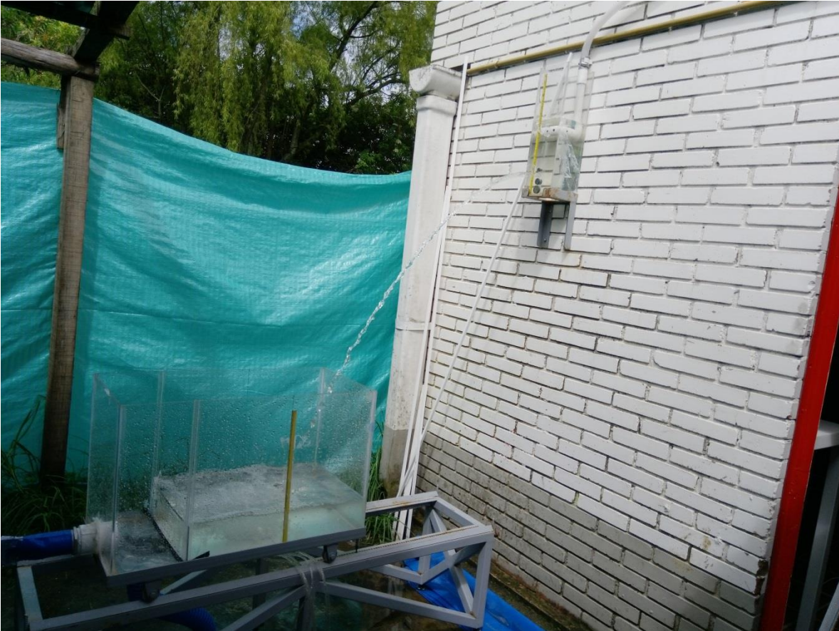
Figura 76: Trayectoria Chorro \phi 0.75", 0.39\text{l/s} < Q < 0.46\text{l/s} para colchón de 125mm.
