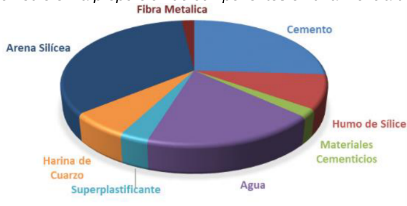
Figura 5: Promedio en la proporción de componentes en una mezcla de UHFRC
