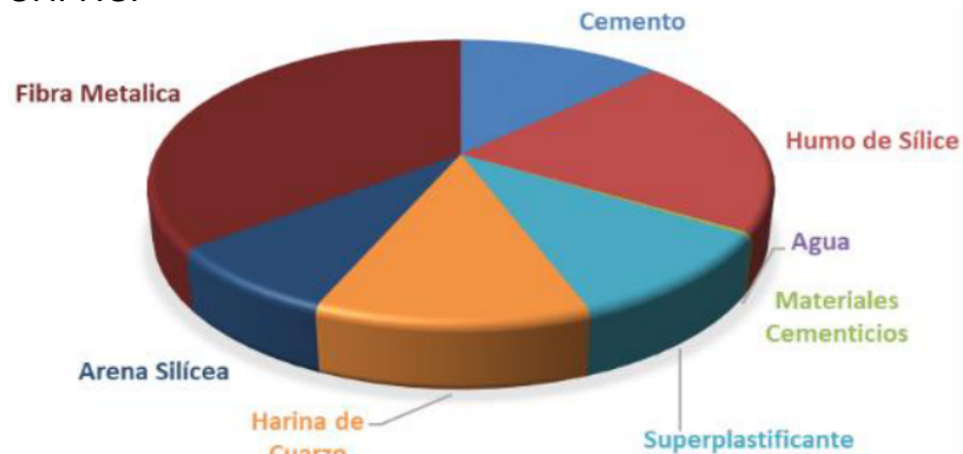
Figura 6: Participación del costo de los componentes en el valor total de una mezcla de UHFRC.
