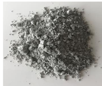
Escoria Arco Eléctrico
