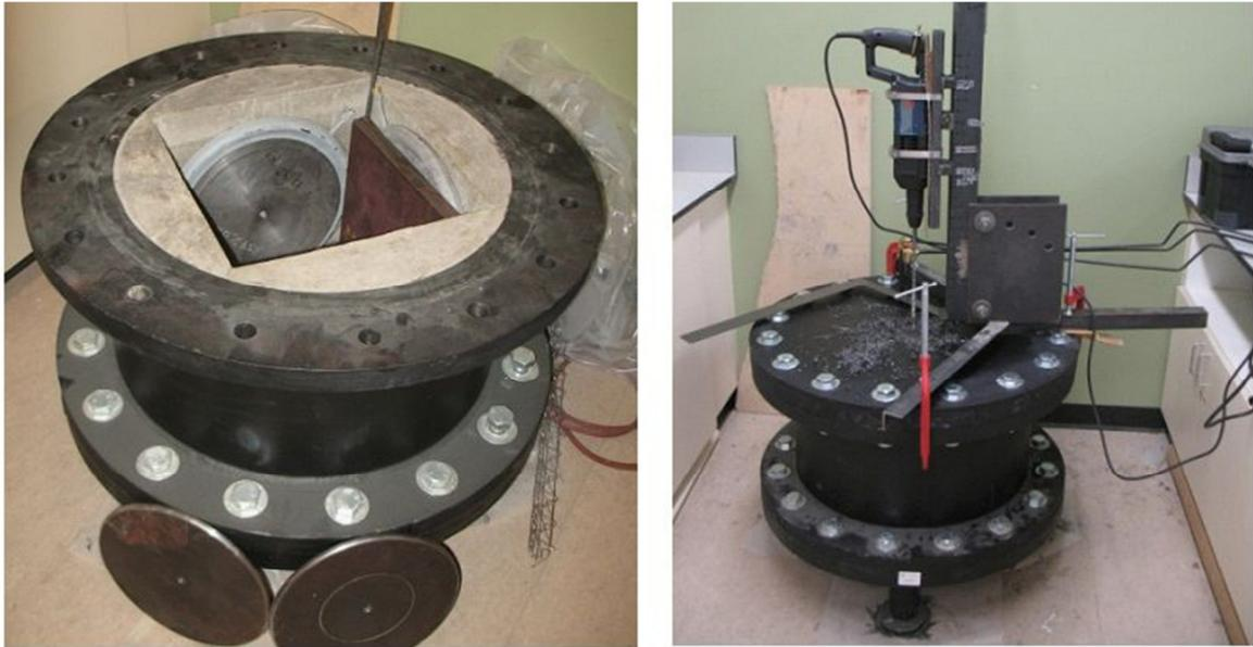
**Figura 5-53. Fotografía de la cámara triaxial auténtica.**
