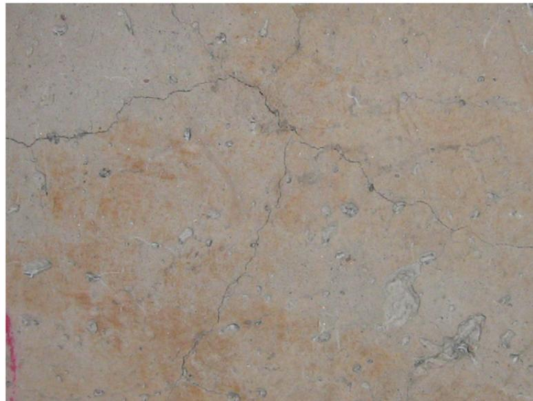
**Figura 5-67. Fracturas naturales aleatorias en la superficie del bloque después de calentarlo y dejarlo ventilar.**
