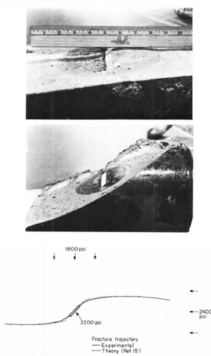
Figura 5-83. Crecimiento de la fractura en el campo de esfuerzos sesgados. a) superficies de fracturas típicas. b) Comparación entre las trayectorias teóricas y experimentales.
