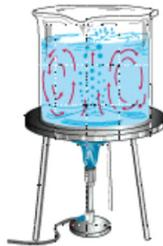
**Figura 3-11. Corrientes de convección dentro de un recipiente de agua.**
