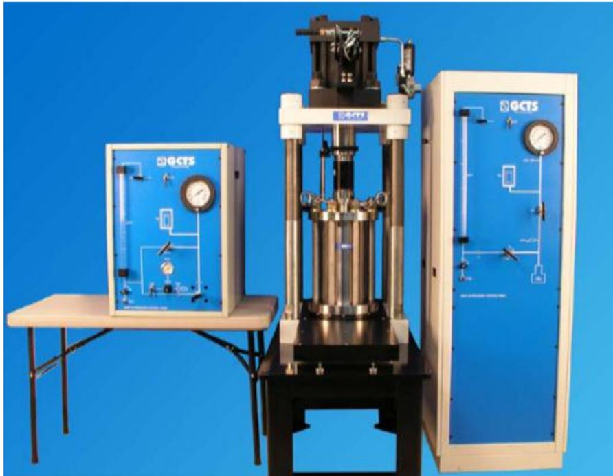
**Figura 6-19. Fotografía del aparato triaxial que también funciona para el ensayo de fracturamiento hidráulico RTX-1000.**
