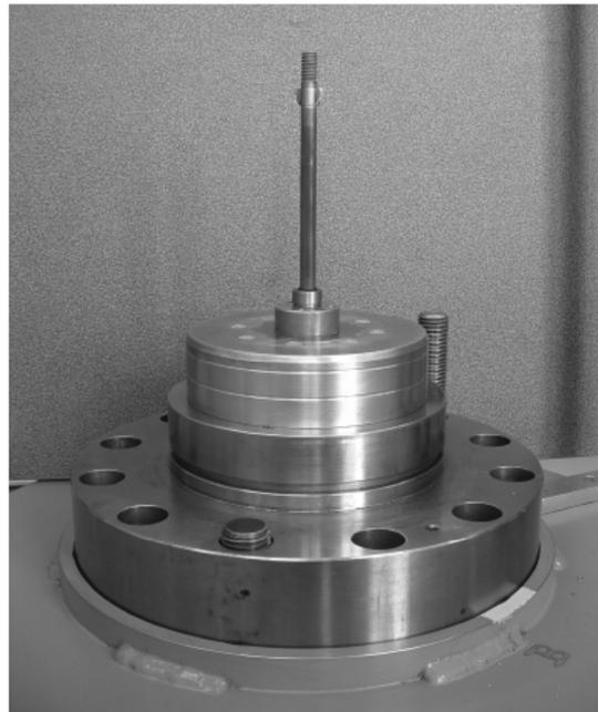
**Figura 5-4. Fotografía del tubo de perforación, la pieza inferior y el pedestal de base.**
