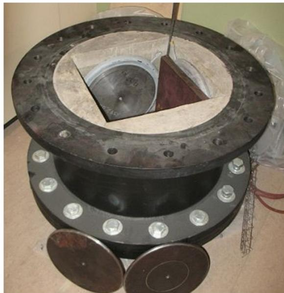
Figura 6-5. Fotografía del aparato de esfuerzos poliaxiales, tipo bloque de concreto envuelto en un anillo de acero de alta resistencia.
