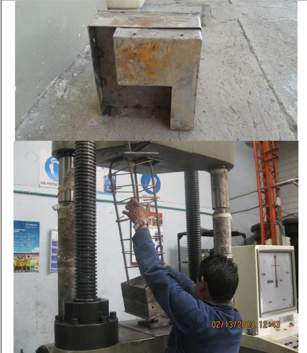
La prueba se realizó para uno de los dos modelos iniciales, sin embargo al realizar el ensayo, como se observa en las figuras 18 a 21, la falla se presentó en la soldadura entre las láminas.
