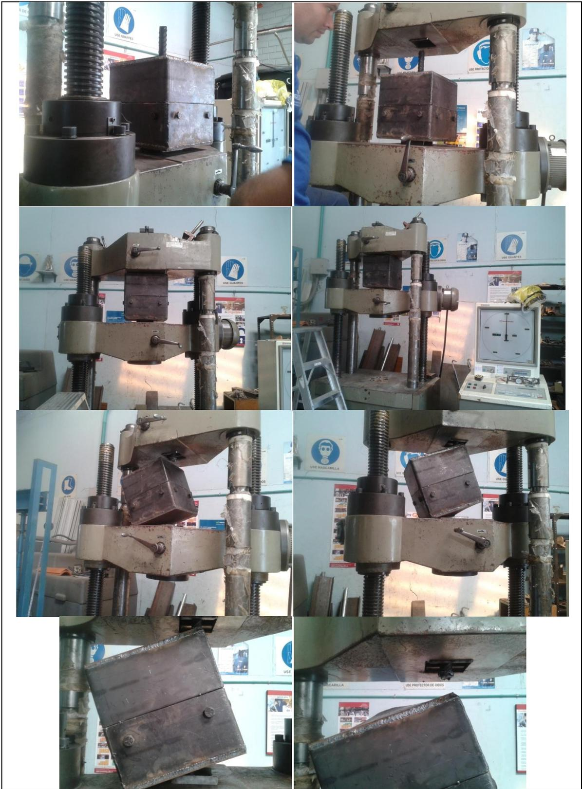
**MONTAJE EN LA MAQUINA ENSAYO A TENSION Y FALLA**
