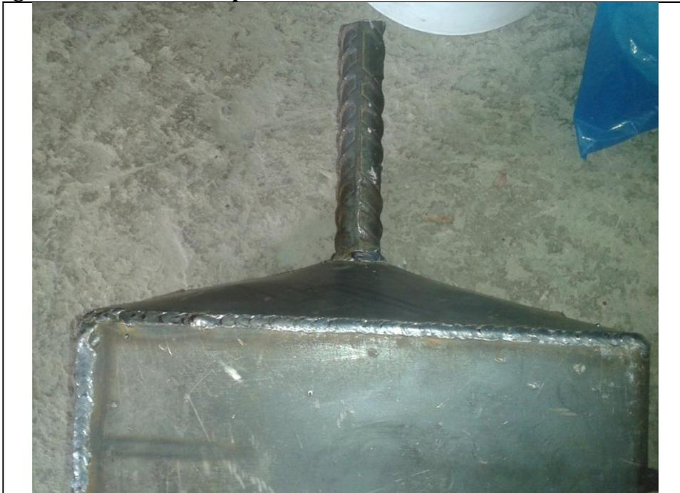
**Imagen 27. Desgarramiento de la platina en el otro extremo**
