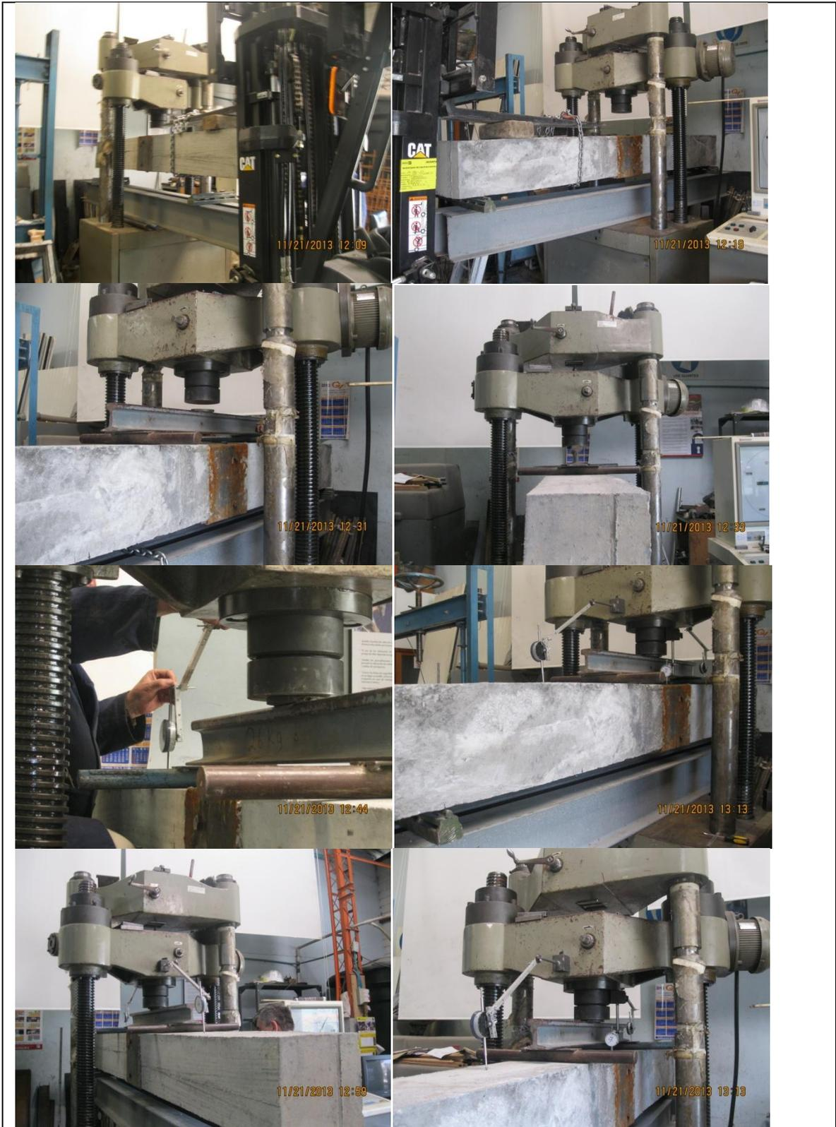
**MONTAJE PARA ENSAYO A FLEXIÓN**
