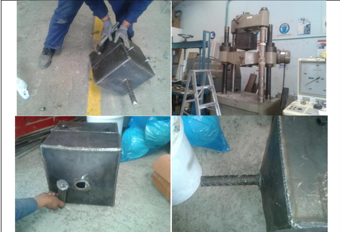
**MONTAJE EN EL LABORATORIO-ENSAYO A TENSIÓN Y FALLA**
