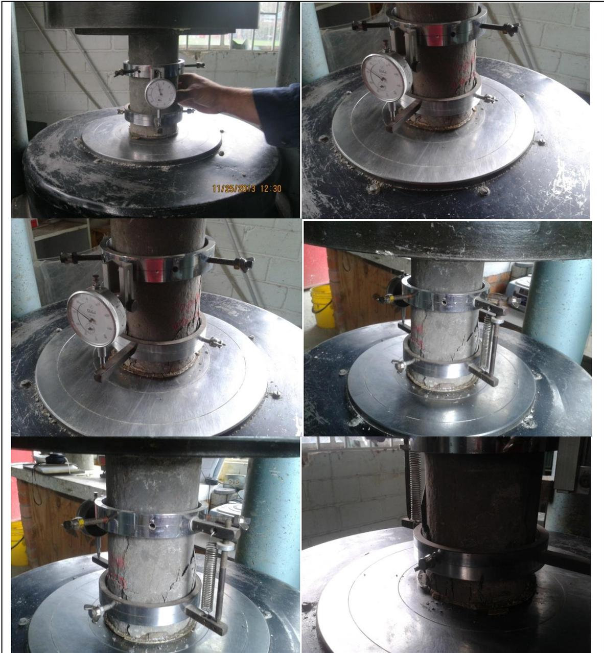
**SEGUNDO ENSAYO PARA MODULO DE ELASTICIDAD**
