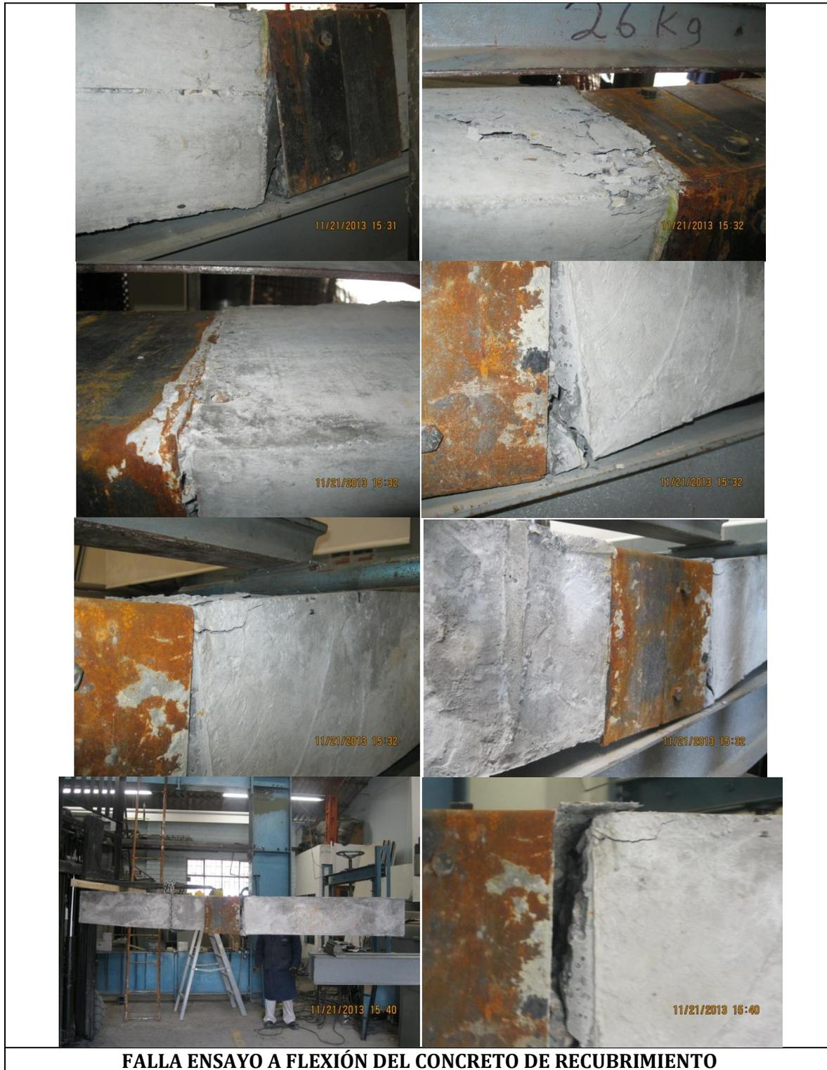
**FALLA ENSAYO A FLEXIÓN DEL CONCRETO DE RECUBRIMIENTO**
