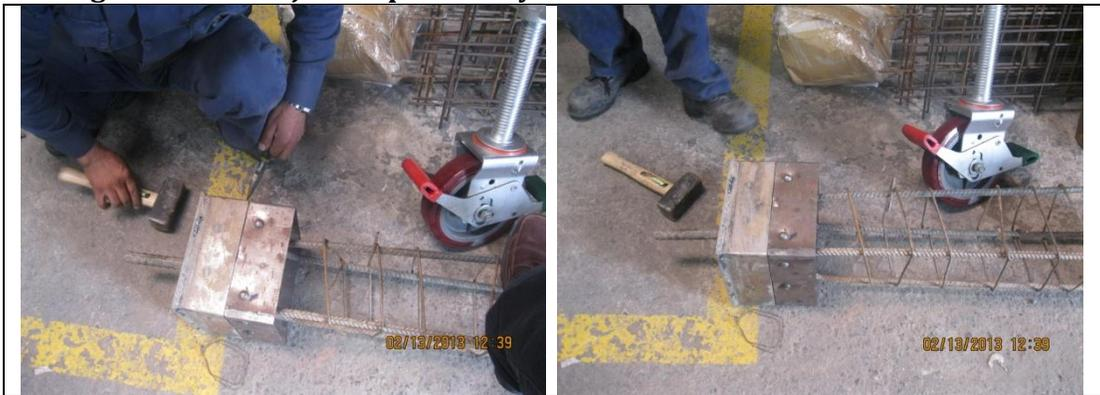
**Figura 18. Inicio de ensayo a preliminar a tensión**
