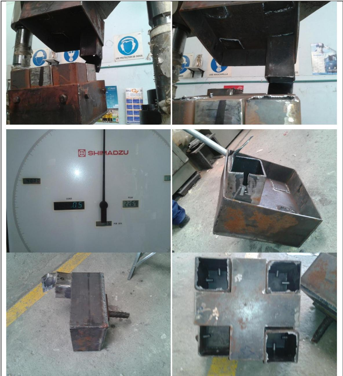
**FALLA A TENSION DEL TERCER MODELO**
