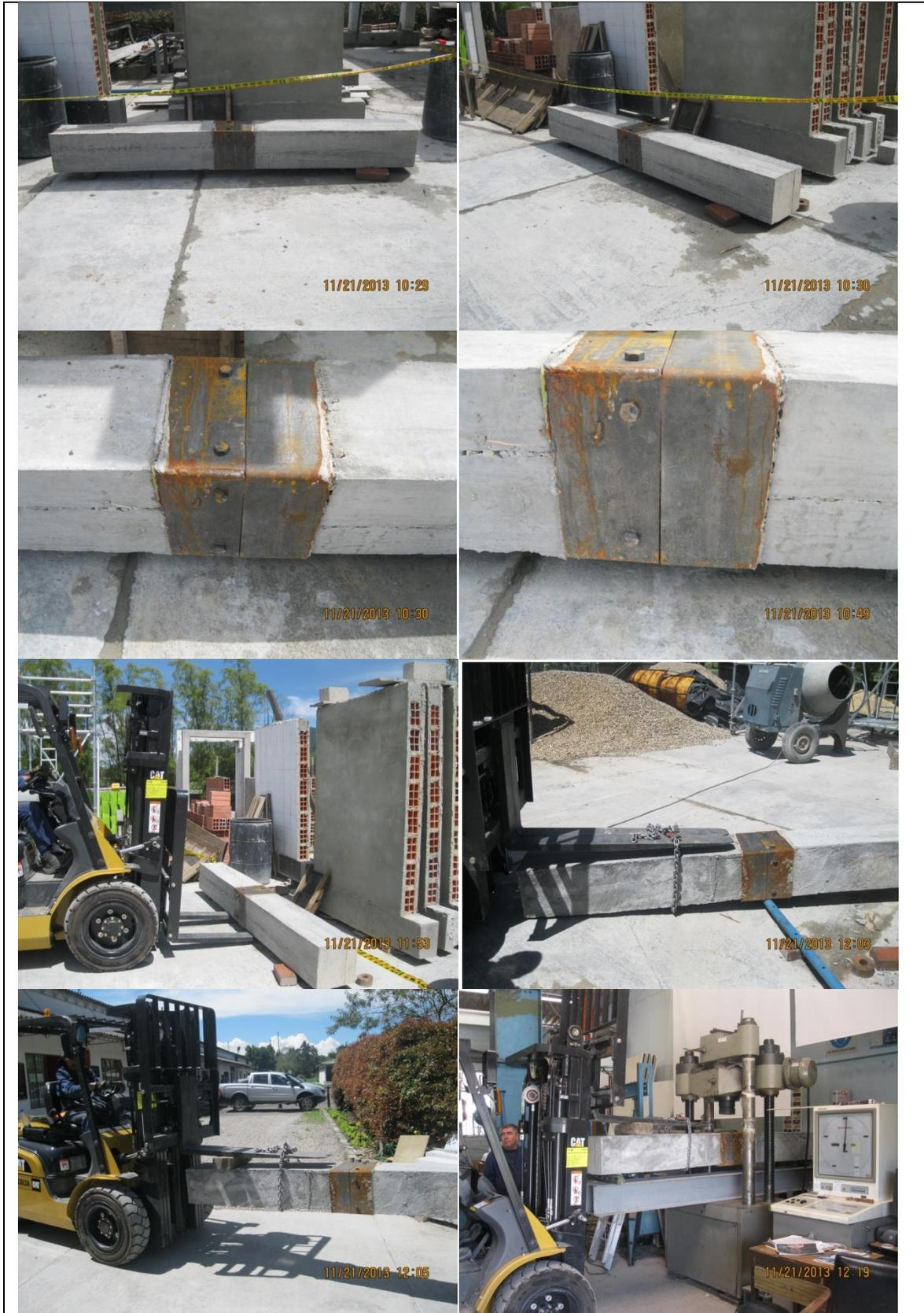
**MODELO Y TRANSPORTE PARA ENSAYO A FLEXIÓN**
