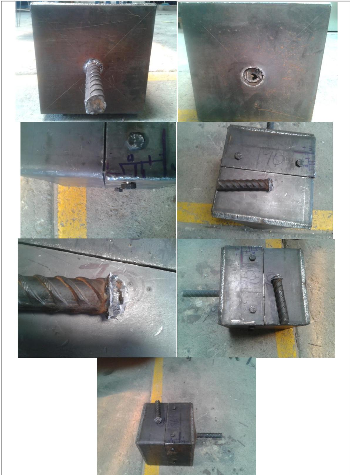
**FALLA POR DESGARRAMIENTO DE LA SOLDADURA**
