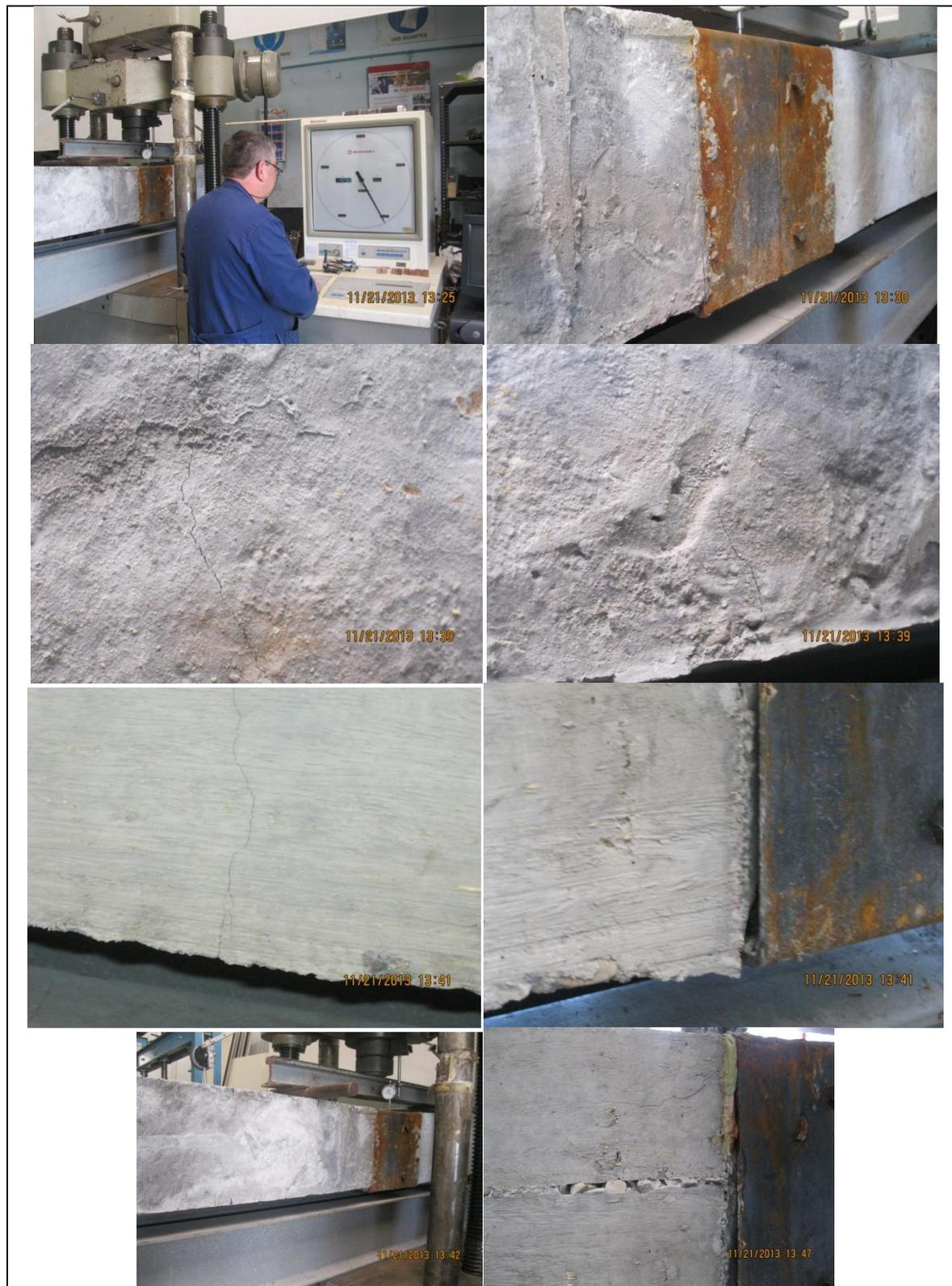
**ENSAYO A FLEXIÓN. INICIO DE FISURAS EN EL CONCRETO Y DE LA FALLA**
