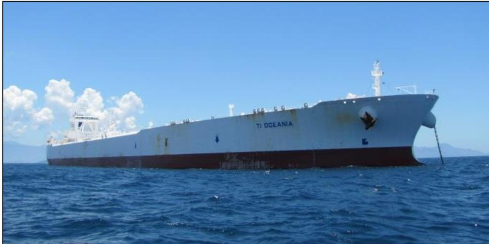
**Figura 4. Buque Petrolero OCEANIA con capacidad de 441.558 toneladas de peso muerto.**
