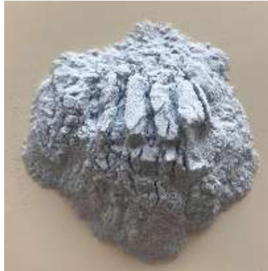
Imagen 4.10 - Fotografía del polvo de vidrio reciclado utilizado. (Fuente: Joaquín Abellán)
