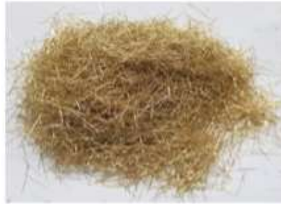
Imagen 4.12 - Fotografía de las fibras de acero rectas utilizadas en el concreto UHPFRC.
