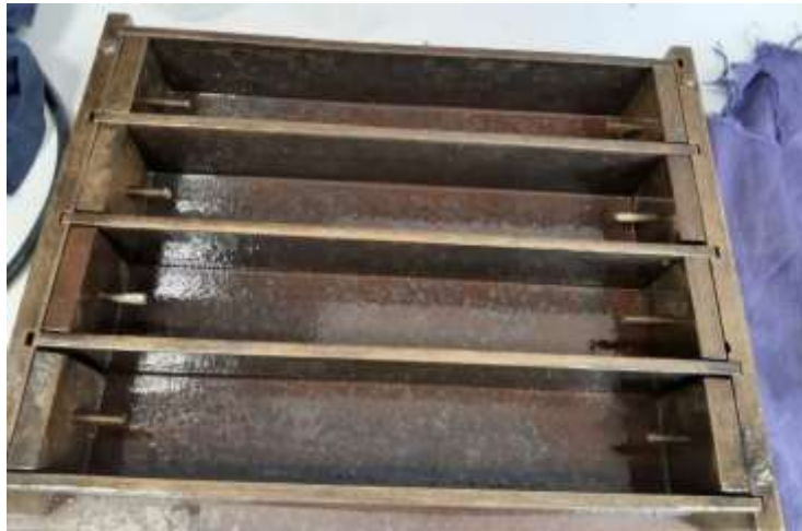
Imagen 4.13 - Moldes utilizados según norma ASTM C596-18 para los especímenes de concreto (fuente propia)
