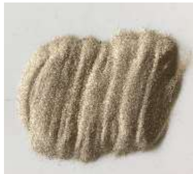
Imagen 4.11 - Fotografía del polvo de la arena de sílice utilizada. (Fuente: Joaquín Abellán)
