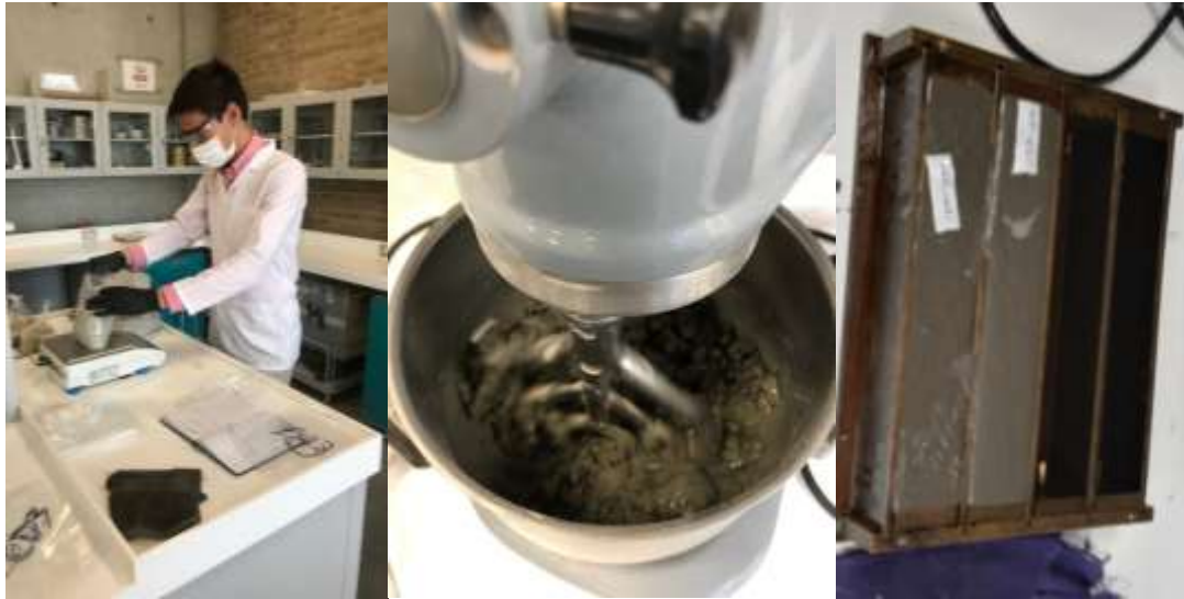
Imagen 4.15 - Procedimiento de pesado de material y mezclado de concreto UHPC y UHPFRC (fuente propia)
