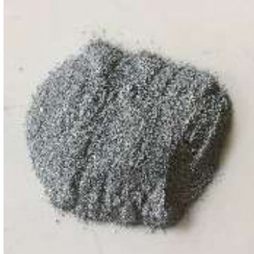
Imagen 4.8 - Fotografía del Humo de sílice utilizado.
