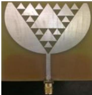
**Figura 7:** Antena SWB con elementos semicirculares [5]
