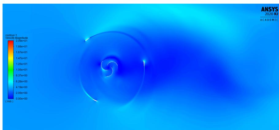
Figure 4.6: Interaccion del fluido con la turbina hibrida con una TSR de 3,5.
