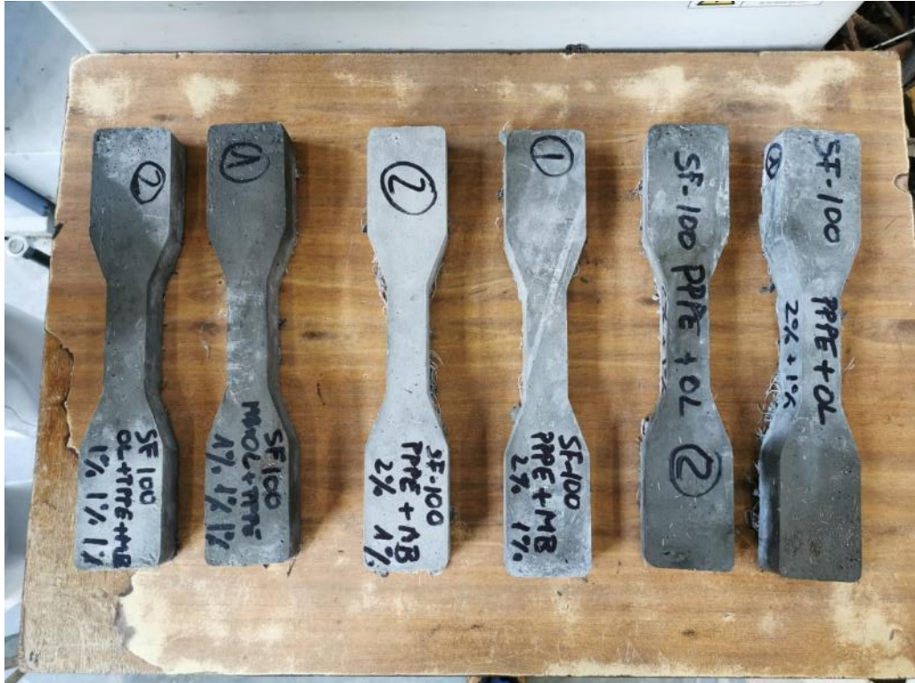
Figura 19 Especímenes de dogbone bajo las recomendaciones de la JSCE-08
