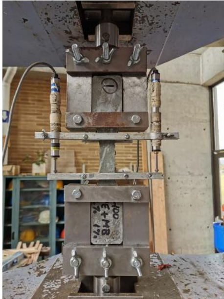
Figura 20 Configuración del ensayo a tracción directa según lo establecido en la JSCE-08
