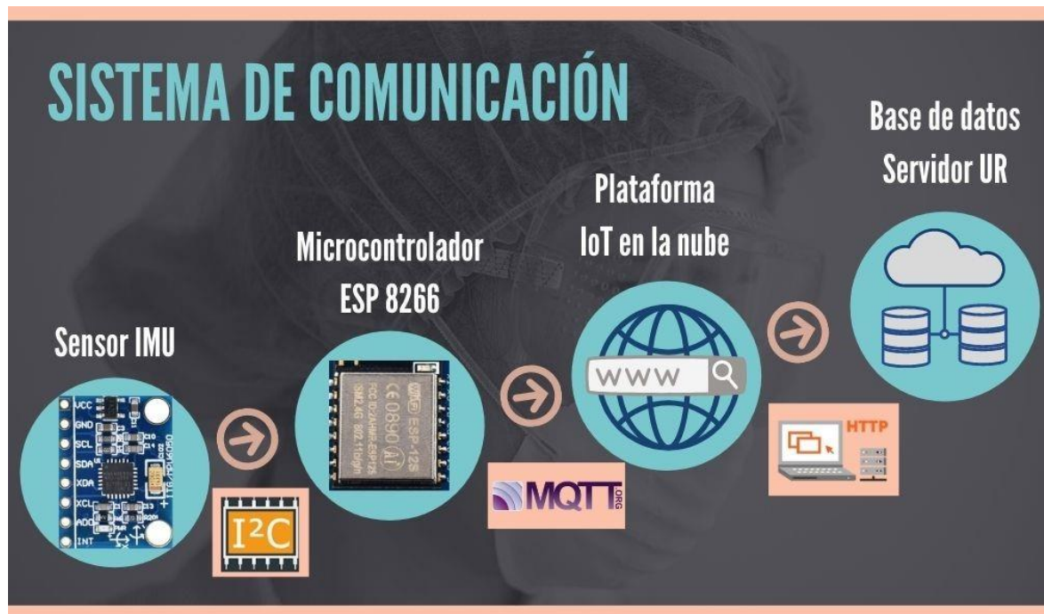
Figura 15, Sistema de comunicación general del dispositivo.
