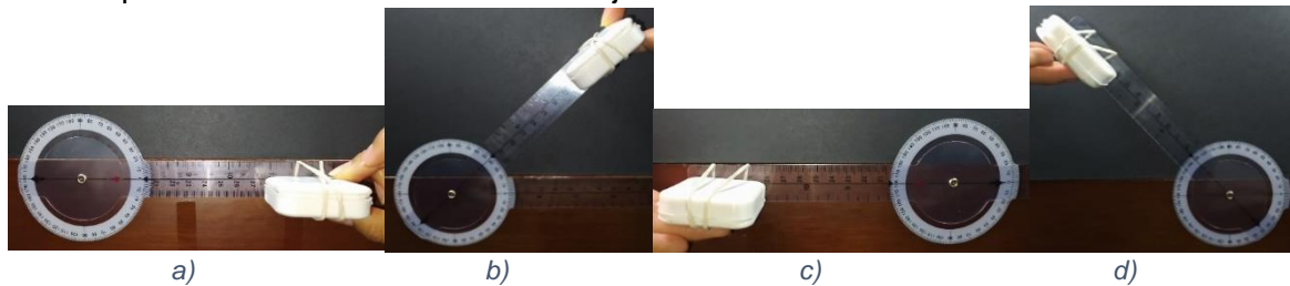
Figura 11, Prueba de sensibilidad con goniómetro, a) 0^\circ decúbito supino, b) 45^\circ lateral derecha, c) decúbito supino, d) -45^\circ lateral izquierda.
