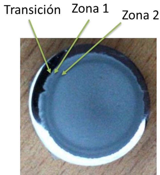
Figura 4.3 Estado superficial posterior al ensayo de erosión.
