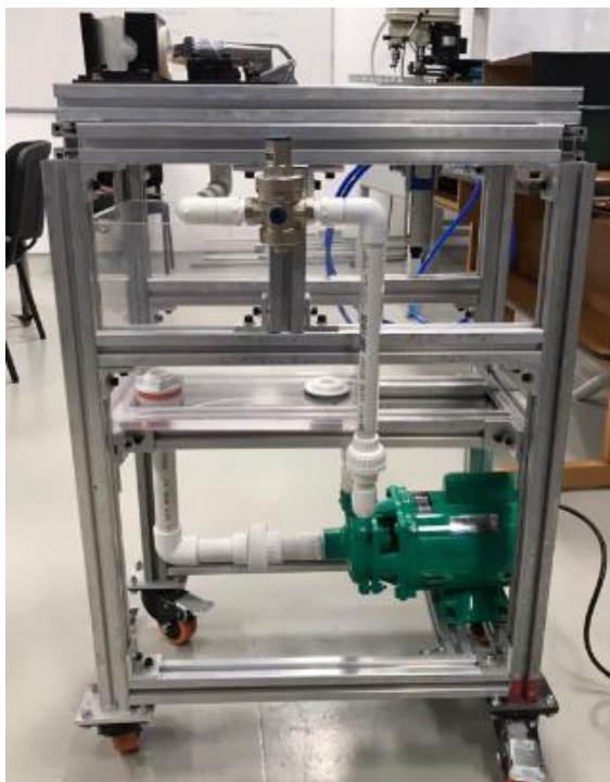
Ilustración 6: Equipo de corrosión-erosión
