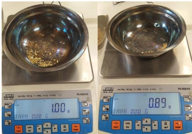
**Figura 4-18:** Imagen de ensayos de pérdidas por calcinación agregados piroclásticos.
