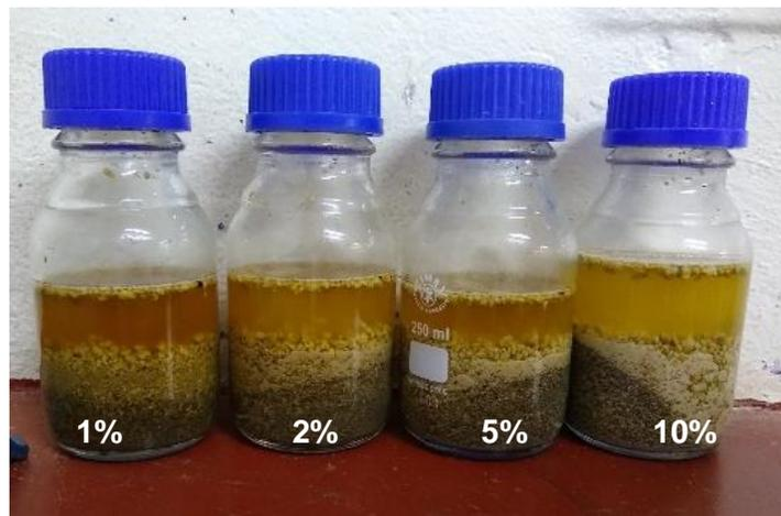
**Figura 4-12:** Ensayo de Colorimetría con adición de cal hidratada el 1%, 2%, 5% y 10% respectivamente de izquierda a derecha.
