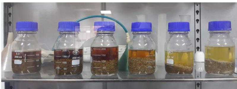
**Observaciones:** De la muestra original se obtienen un numero de placa N° 5 de color negro no aceptable para muestras de concreto, con el tratamiento de cal reemplazando el 1 y 2% en peso de la muestra se obtiene color de placa N° 5, con reemplazo al 5% de color N° 3, con el reemplazo del 10% color de placa N° 2 y por ultimo con reemplazo del 20% color de placa N° 1.
