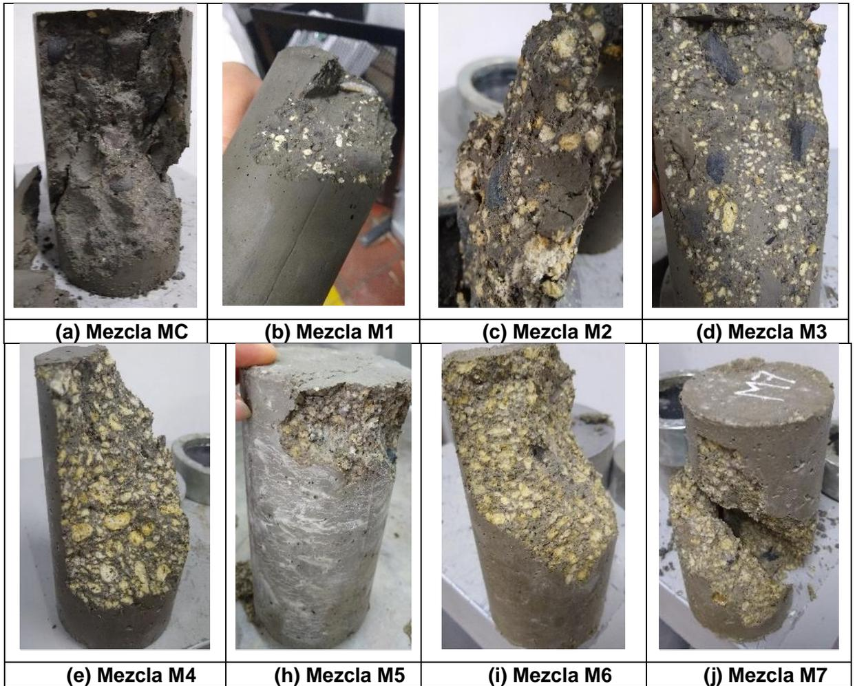
**Figura 6-14:** Ensayo de compresión, para las siguientes mezclas: MC, M1, M2, M3, M4, M4, M6 y M7.
