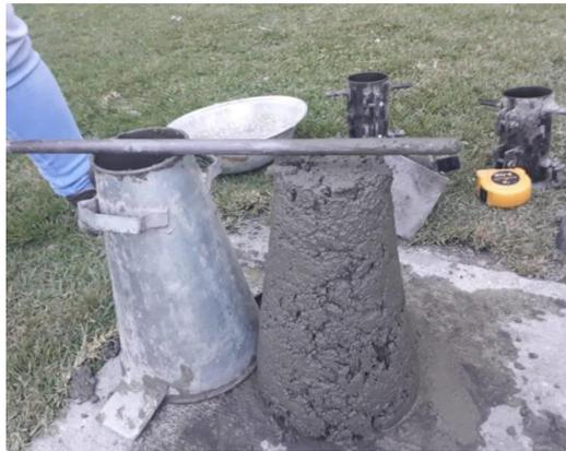
**Figura 6-6:** Imagen del ensayo de asentamiento realizado para la mezcla 4.
