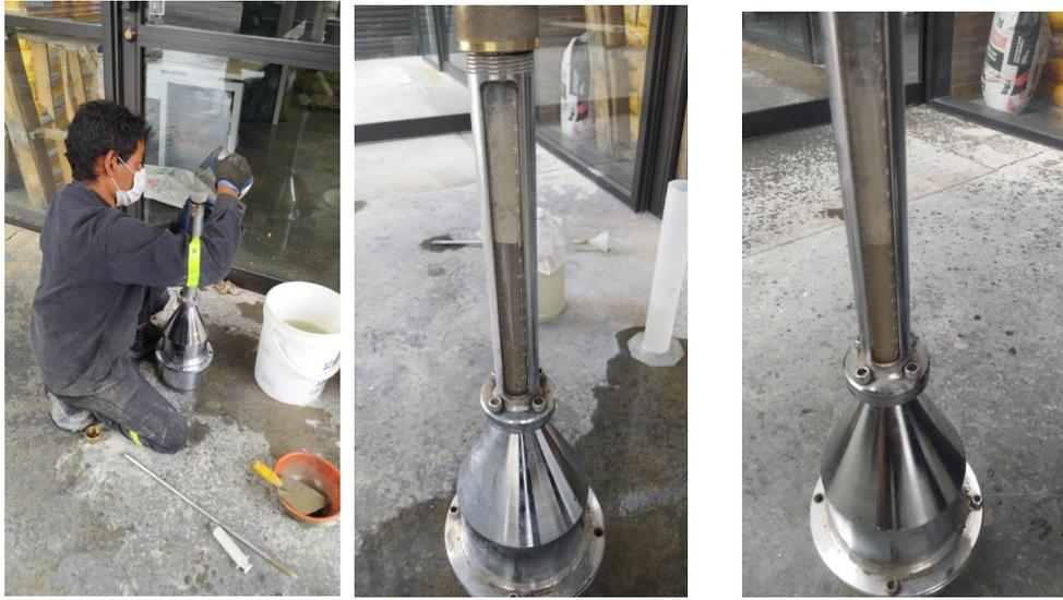
**Figura 6-11:** Ensayo de contenido de aire por método volumétrico mezcla M11 y M13.
