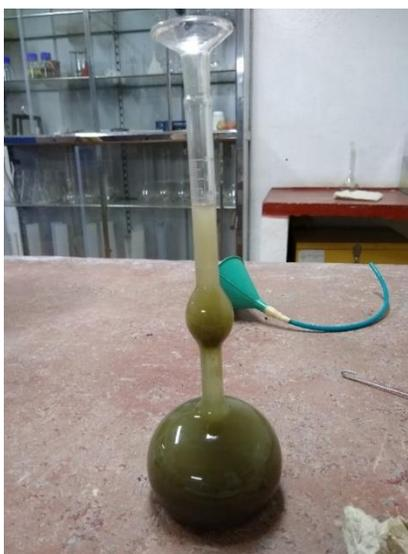
**Figura 4-19:** Imagen de ensayo de densidad del cemento hidráulico.
