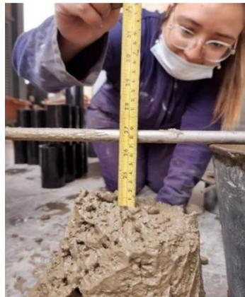
**Figura 6-7:** Imagen del ensayo de asentamiento MC-1.
