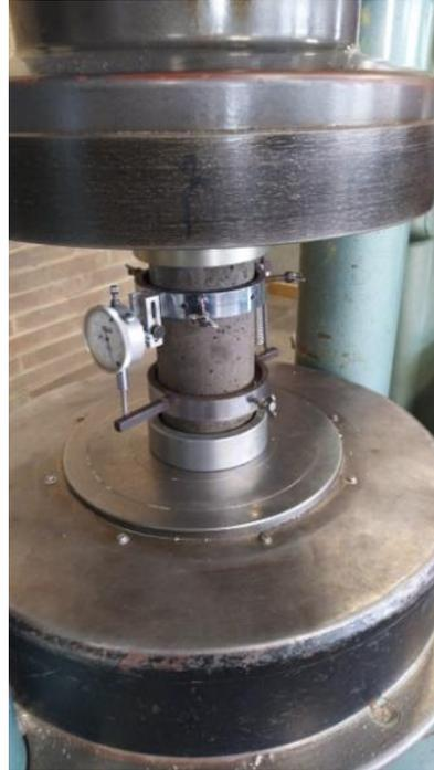
Figura 6-22: Ensayo de módulo elástico, mezcla M9.
