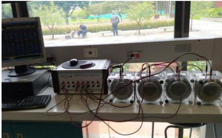
**Figura 6-34:** Montaje ensayo de penetración del ión cloruro
