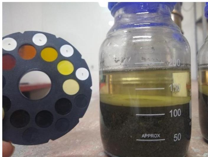
**Figura 4-10:** Ensayo colorimetría arena de río.
