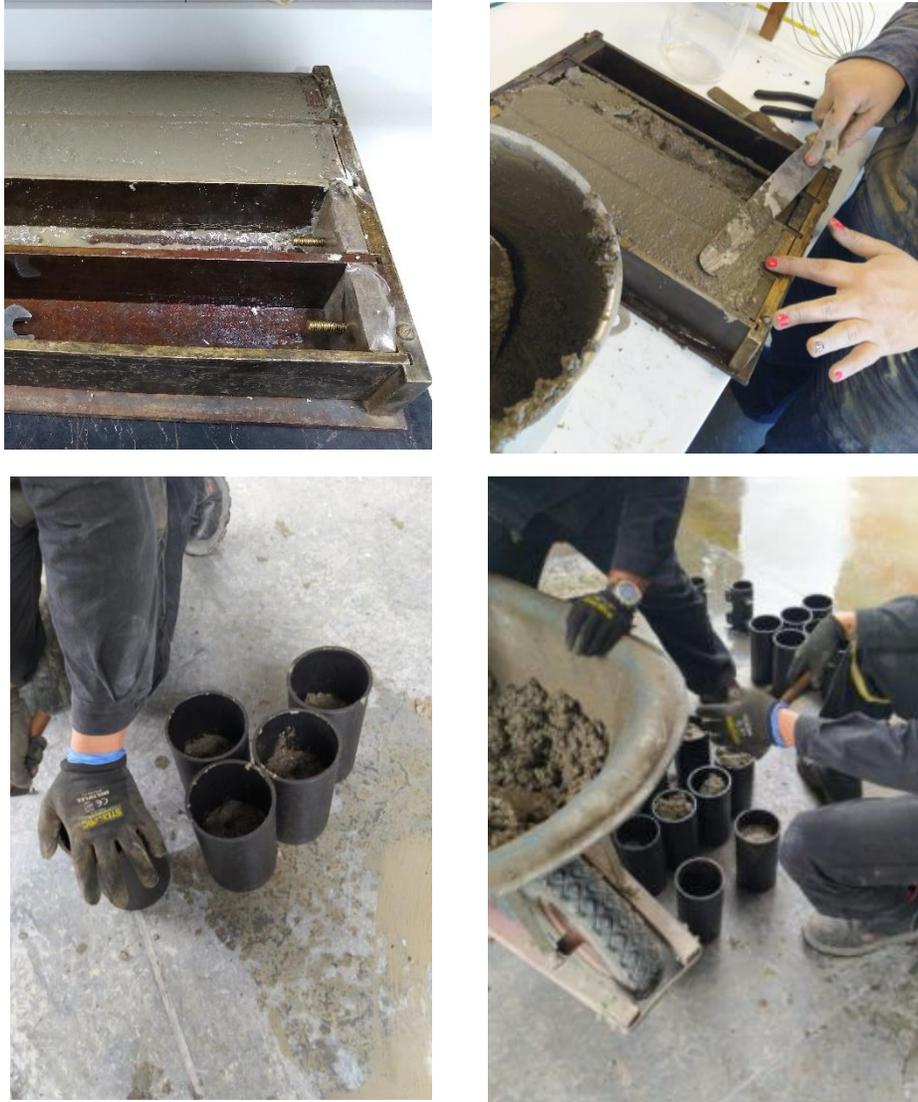
**Figura 6-1:** Elaboración de especímenes para ensayos de concreto.
