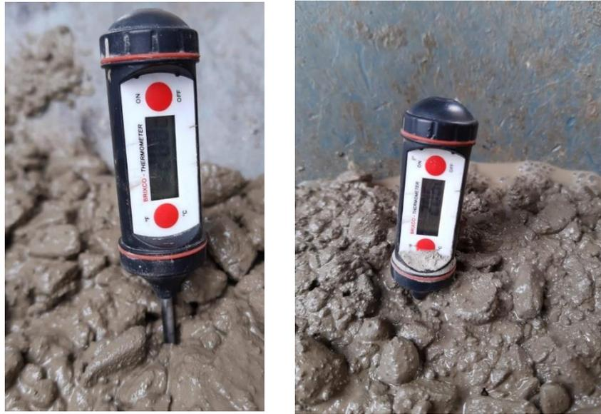
**Figura 6-4:** Ensayo de toma de temperatura mezclas M12 y MC-1
