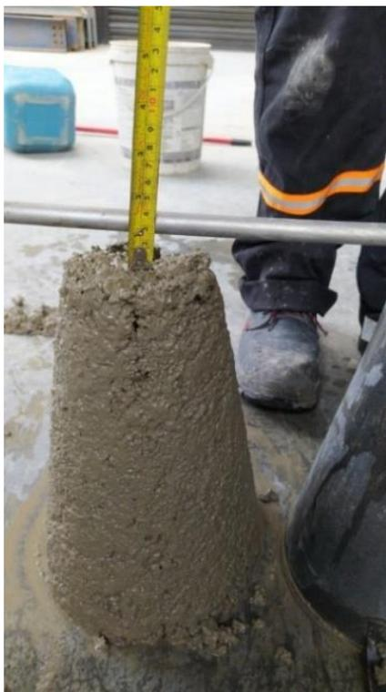
**Figura 6-9:** Ensayo de asentamiento mezcla M11.
