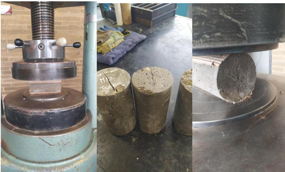
**Figura 6-28:** Ensayo de tensión indirecta, fase dos.
