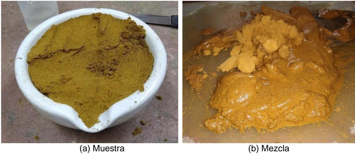
**Figura 4-9:** Limite plástico en agregado lapilli.
