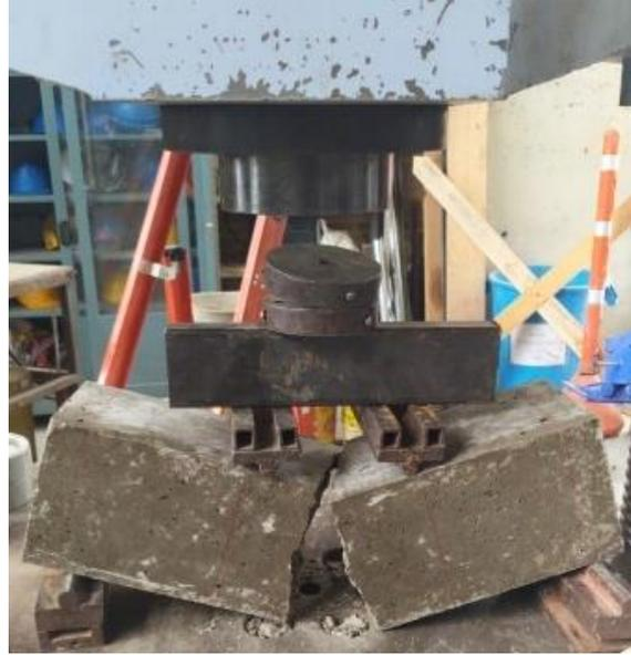
**Figura 6-18:** Ensayo de flexión en los tercios medios, mezcla M9.
