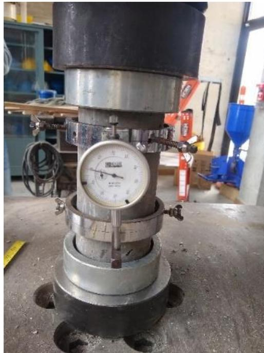
**Figura 6-20:** Ensayo del módulo elástico, para la mezcla M1.
