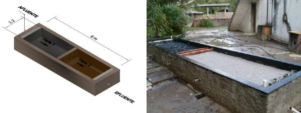
Figura 17 Humedal artificial de tratamiento de aguas grises Fuente: Adaptado y tomado de Monteiro, 2009, pp. 43–52
