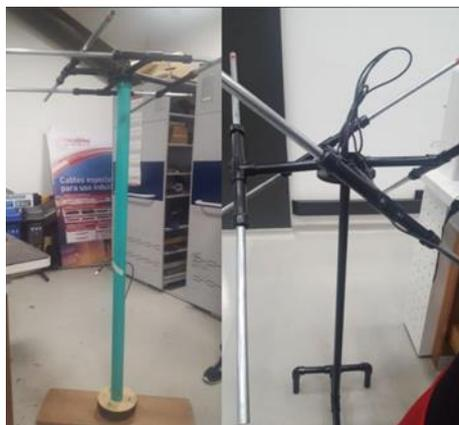
Fig. 2: Construcción física y configuración de los elementos de la ADC
