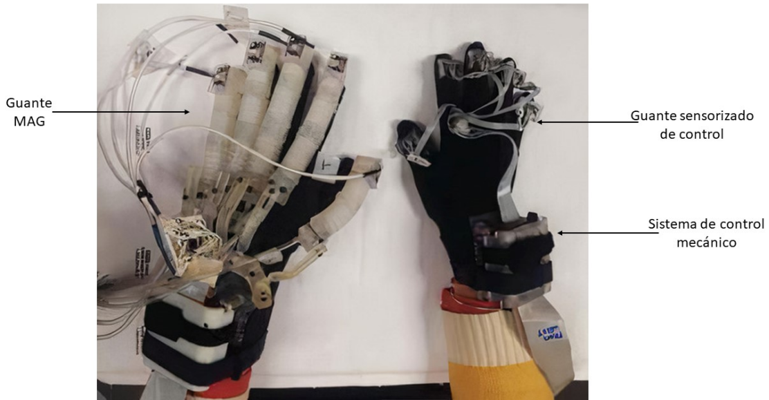
Figura 2.4: Exoesqueleto MAG con guante de comando de movimientos para el control de actuación [45].
