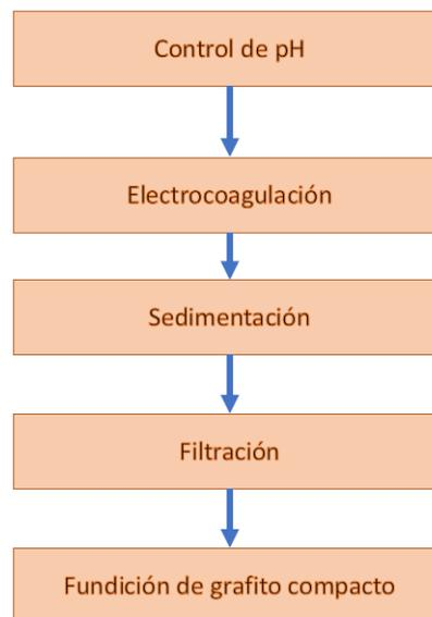
Figura 15. Proceso de electrocoagulación [31].
