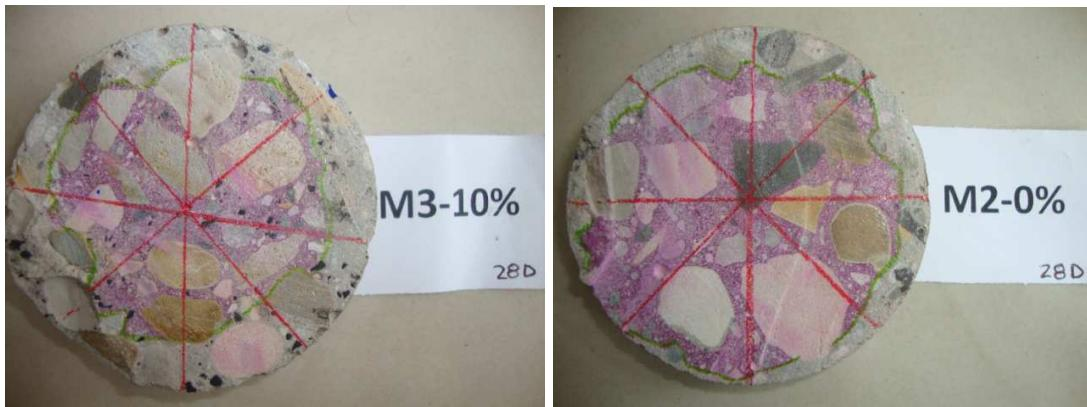
**Figura 37 Penetración frente de carbonatación.**
