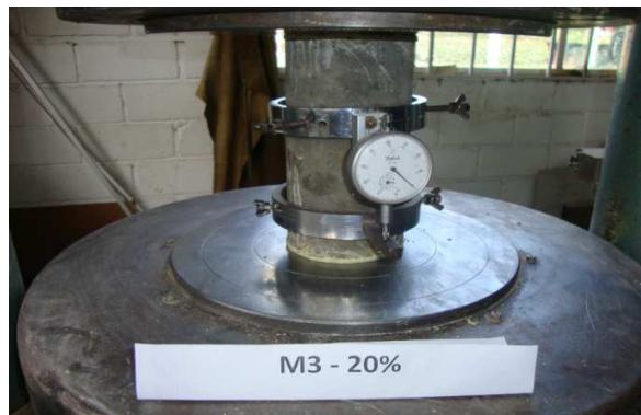
**Figura 30 Ensayo resistencia a la compresión.**
