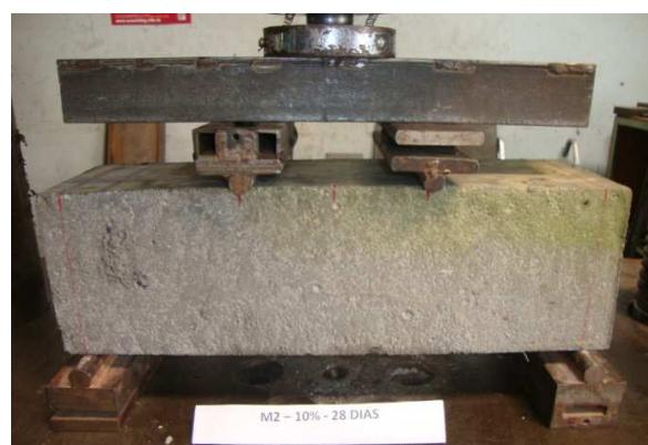
**Figura 31 Ensayo resistencia a la flexión.**
