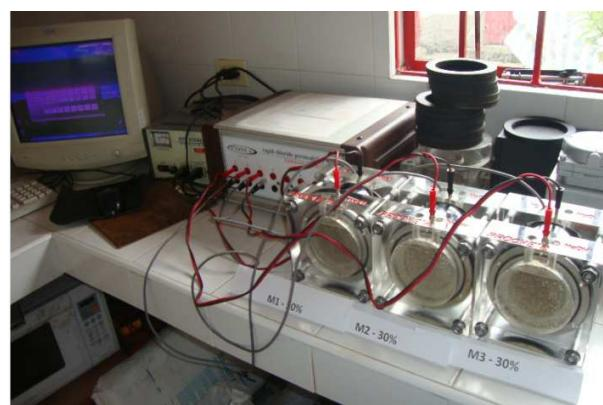
Figura 33 Ensayo de absorción ISAT.
