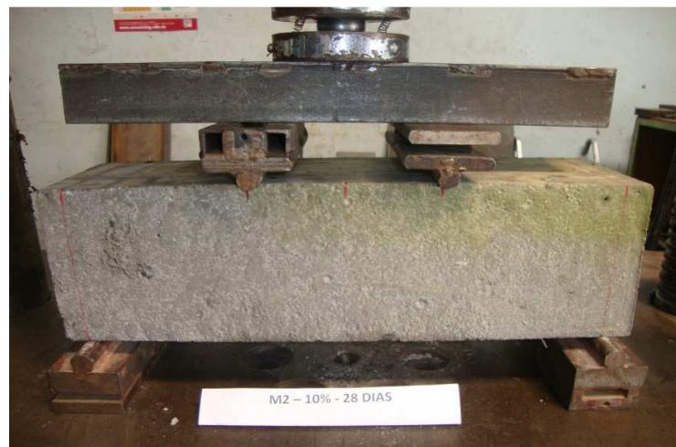
**Figura 4 Ensayo de resistencia a flexión.**
