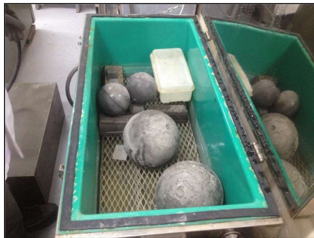
Figura 9 Esferas de concreto que simulan rocas para prueba experimental del tiempo de impacto. Tomado de (Rivero Galvis y Mayorga Morales, 2013).
