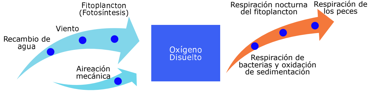
Figura 2.3: Factores que contribuyen con las variaciones de OD en un estanque de piscicultura continental. Fuente: Boyd C. y Lichtkoppler F., Water quality managment in Fish culture , 1979.
