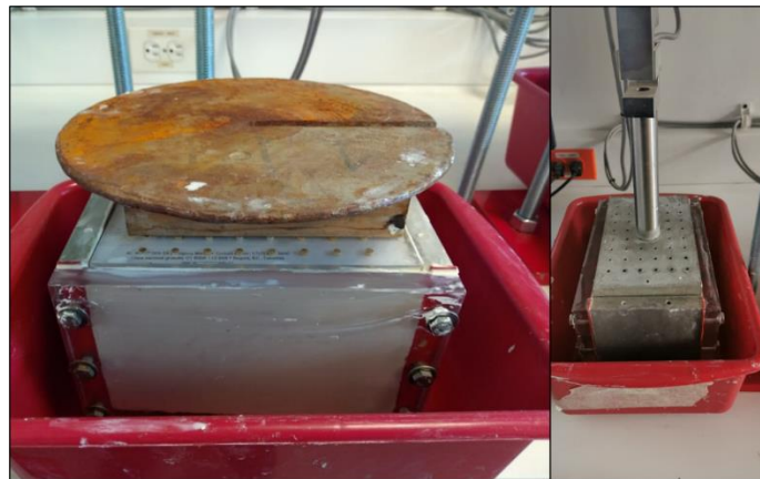
Figura 5.3. Fotografía de la reconstitución del suelo en los consolidómetros electrónicos.
