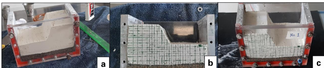
Figura 5.17. Proceso de formación del talud de suelo de prueba; a) Corte de material para la formación del talud; b) Trazado de la cuadrícula en la pared del talud; c) Ensamble de la caja con el talud y la cuadrícula.
