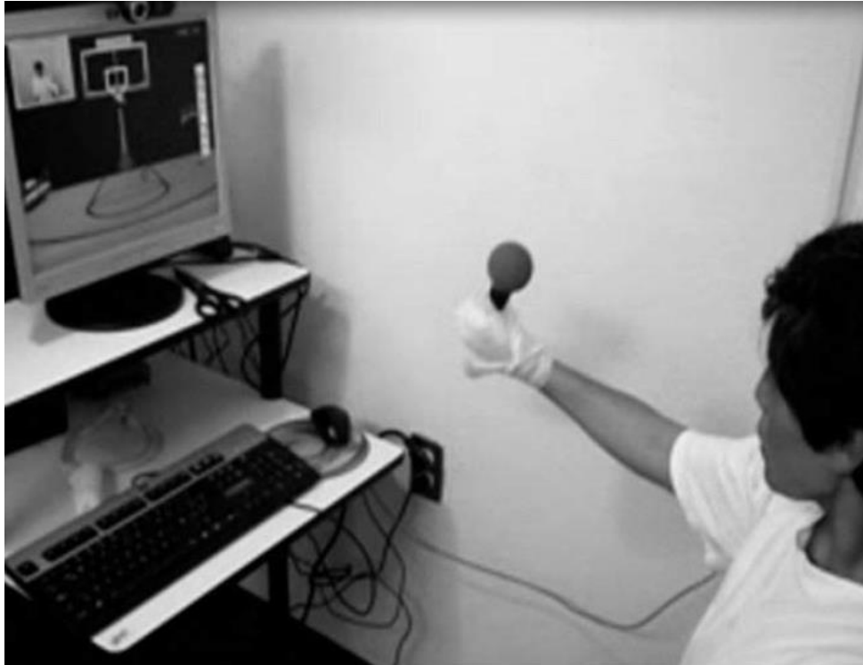
Figura 7. Sistema Gesture Therapy, la imagen muestra la colocación del paciente frente al sistema de cómputo, el diseño del joystick y cámara que realiza el seguimiento de los desplazamientos que realiza el paciente.
