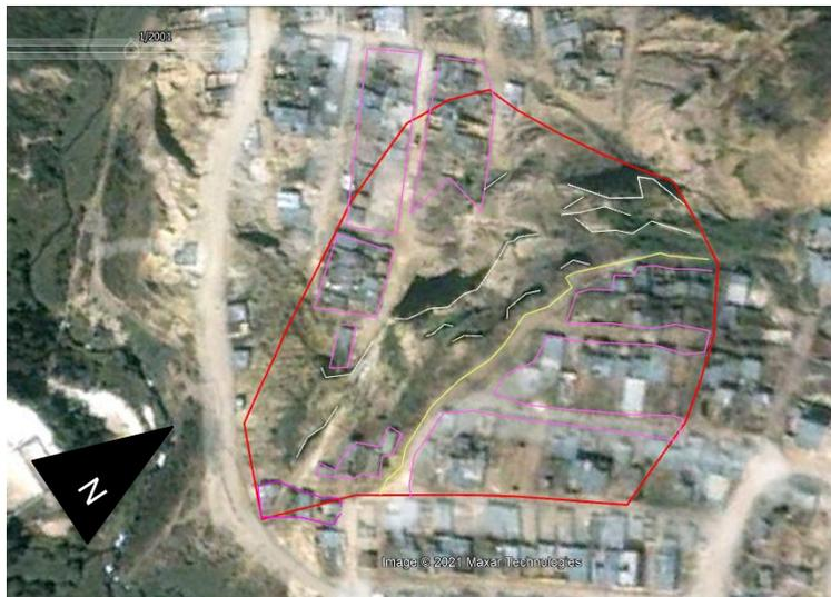
*Ilustración 1514, 2001. Fuente: Google Earth. Descripción Se evidencian dos terrazas localizadas entre la parte alta y baja del talud, posiblemente construidas una vez finalizada la extracción de material con el fin de estabilizar la zona de alta pendiente.*
