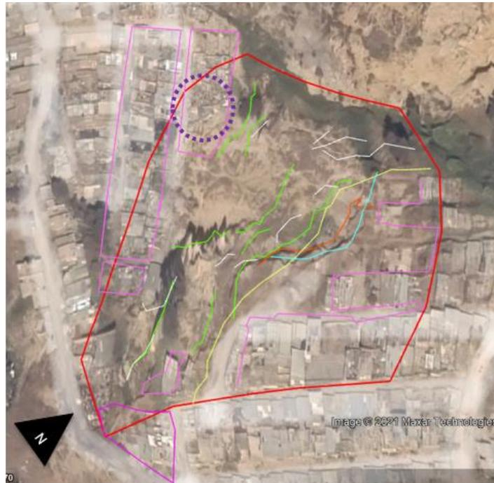
*Ilustración 2019. Enero 2016. Fuente: Google Earth. Descripción Color purpura: reasentamiento de viviendas en la parte baja del talud, los escarpes no presentan cambios considerables*
