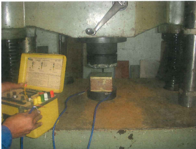
FIGURA 7. Conexión de las galgas extensiométricas al puente de Wheatstone.
