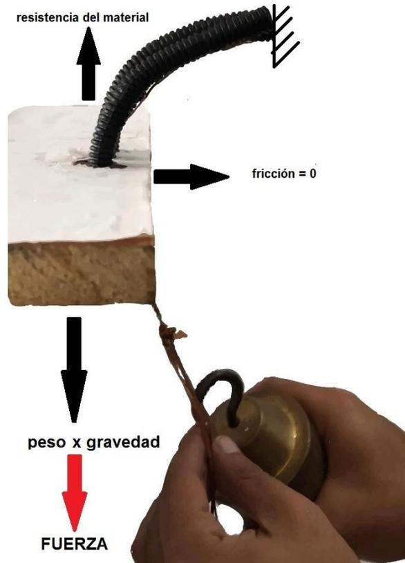
Figura 3.2: Prueba de fuerza, colocación de peso muerto en el hilo de cáñamo (sistema tendones), con el objetivo de identificar la fuerza necesaria de activación y máxima soportada, los resultados se observarán en el capítulo 4
