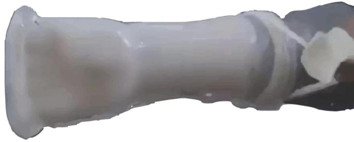
Figura 3.4: Encaje protésico realizado mediante termoformado con las medidas del paciente
