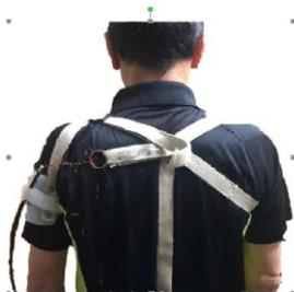
Figura 3.12: Ensamblaje del cable al arnés por medio de un anillo.
