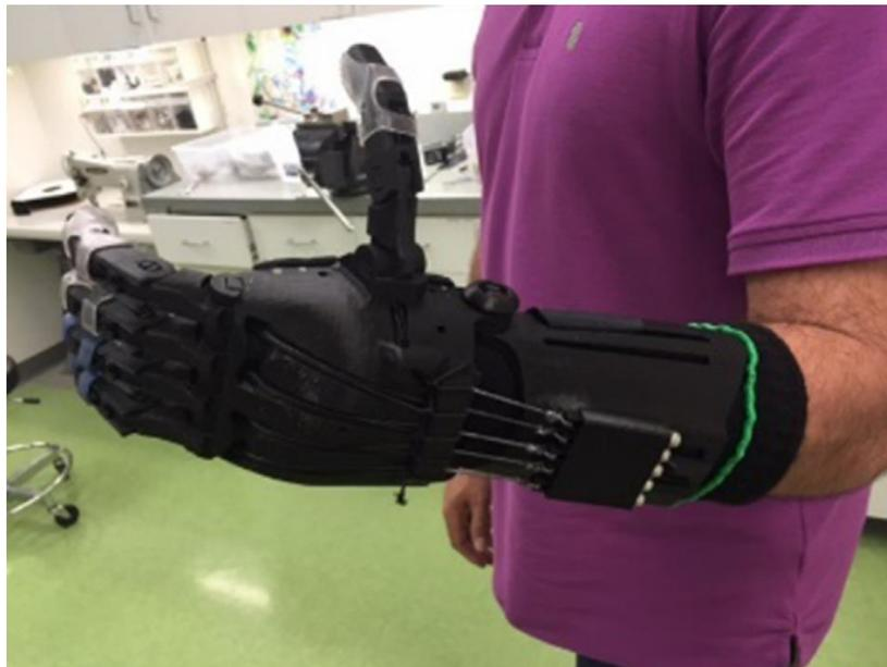
Figura 2.7: Prótesis impresa en tercera dimensión la cual es activada mediante el movimiento de la muñeca [66].
