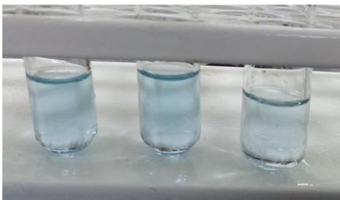
Figura 25. Alícuotas finales de experimentos 4, 5 y 6 con 2,058 mM (70 mg/L) de H<sub>2</sub>O<sub>2</sub>
