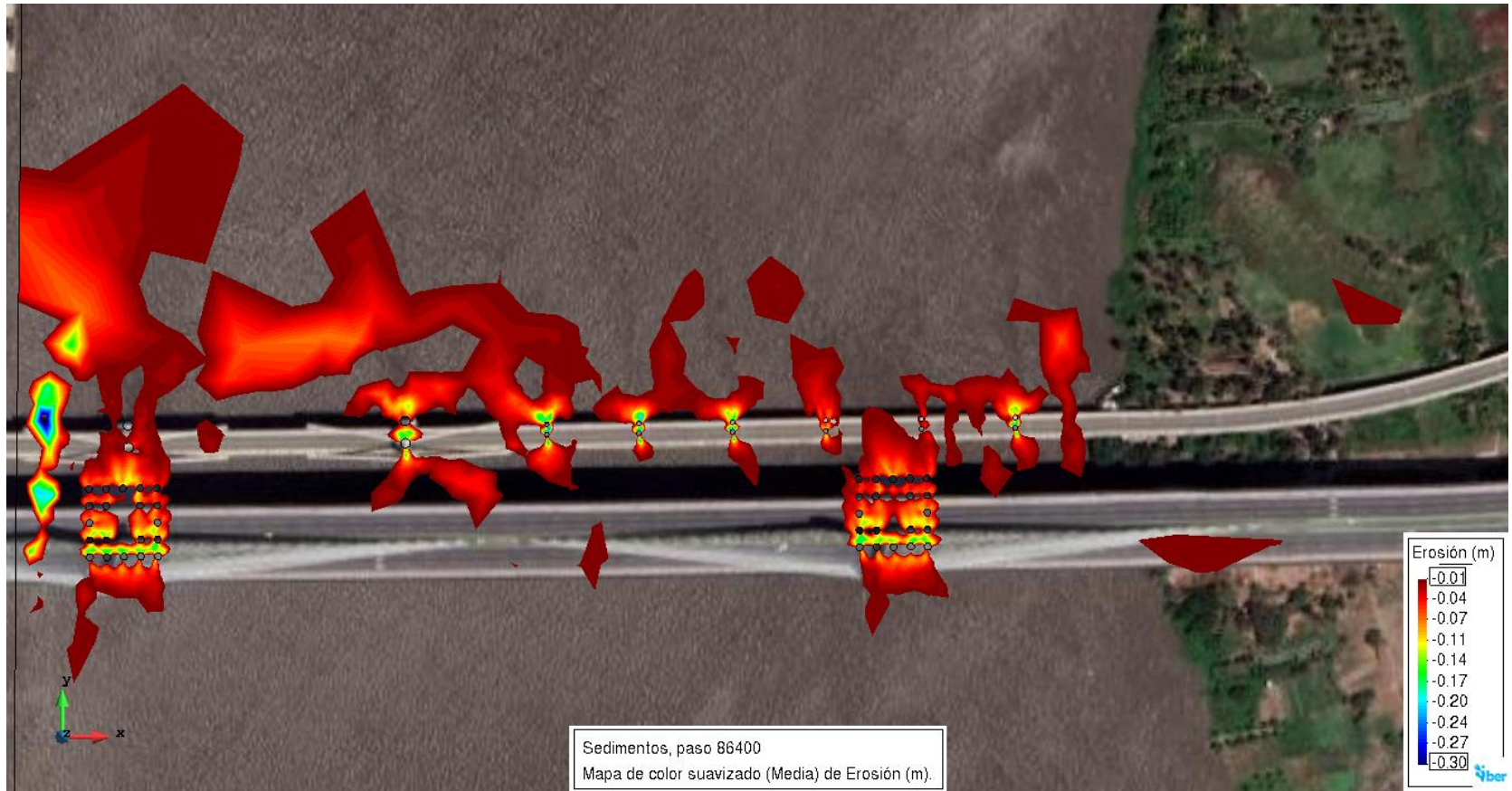
Figura 62. Resultados sedimentación rango -0.01 – -0.30 m Escenario 2 Fuente: Elaboración propia
