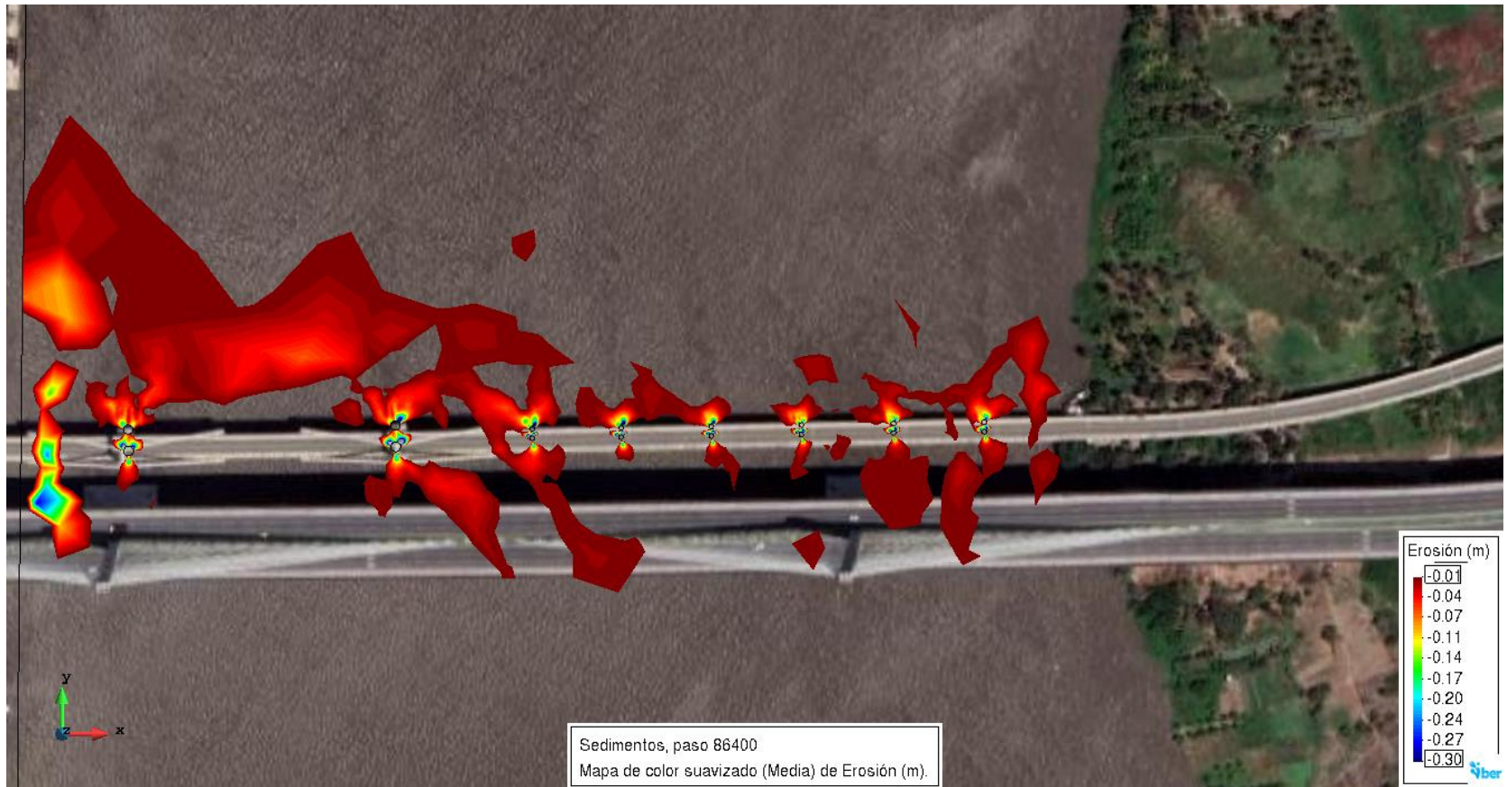
Figura 61. Resultados sedimentación rango -0.01 – -0.30 m Escenario 1 Fuente: Elaboración propia
