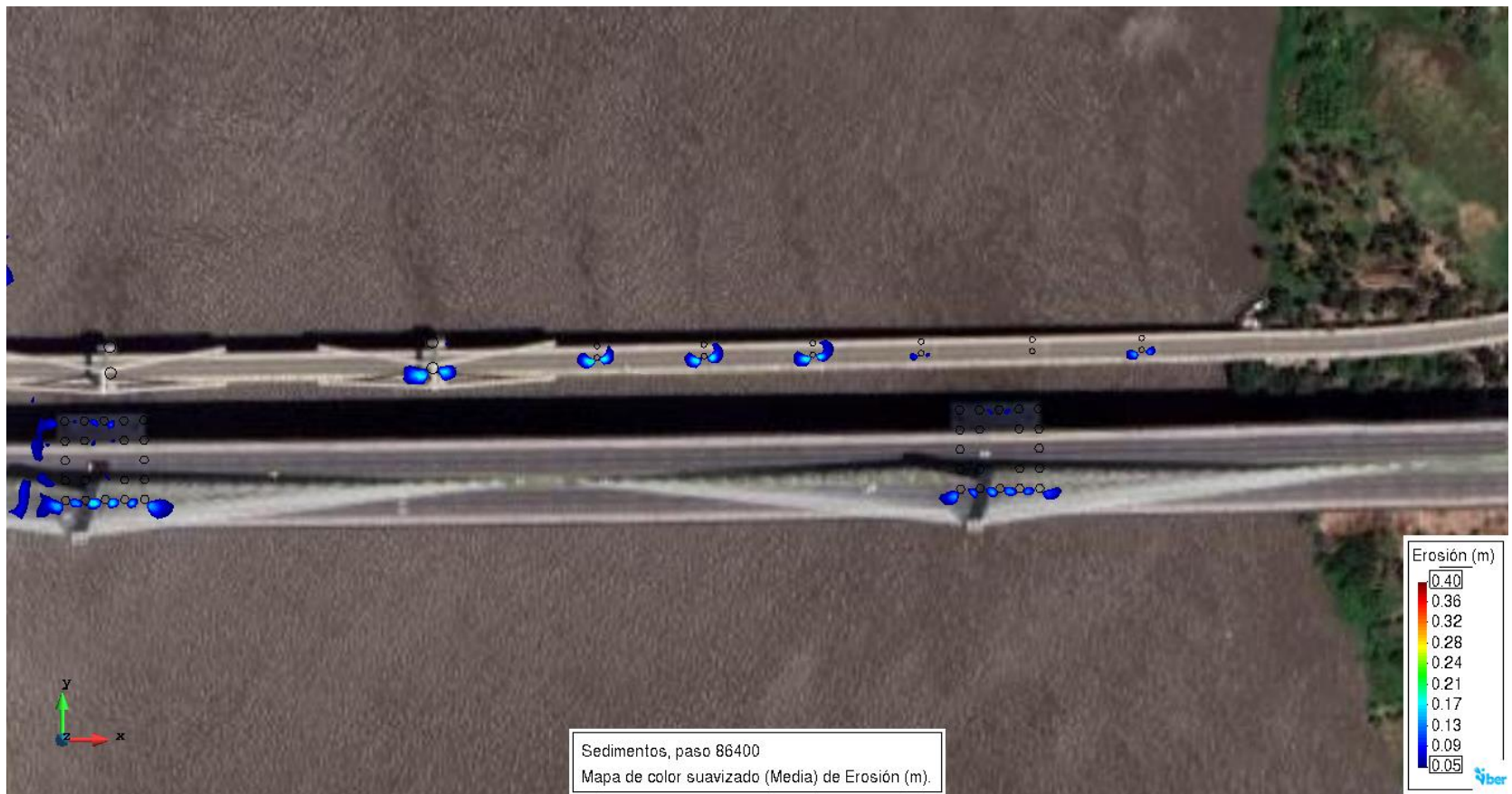
Figura 60. Resultados erosión rango 0.05 – 0.40 m Escenario 2 Fuente: Elaboración propia
