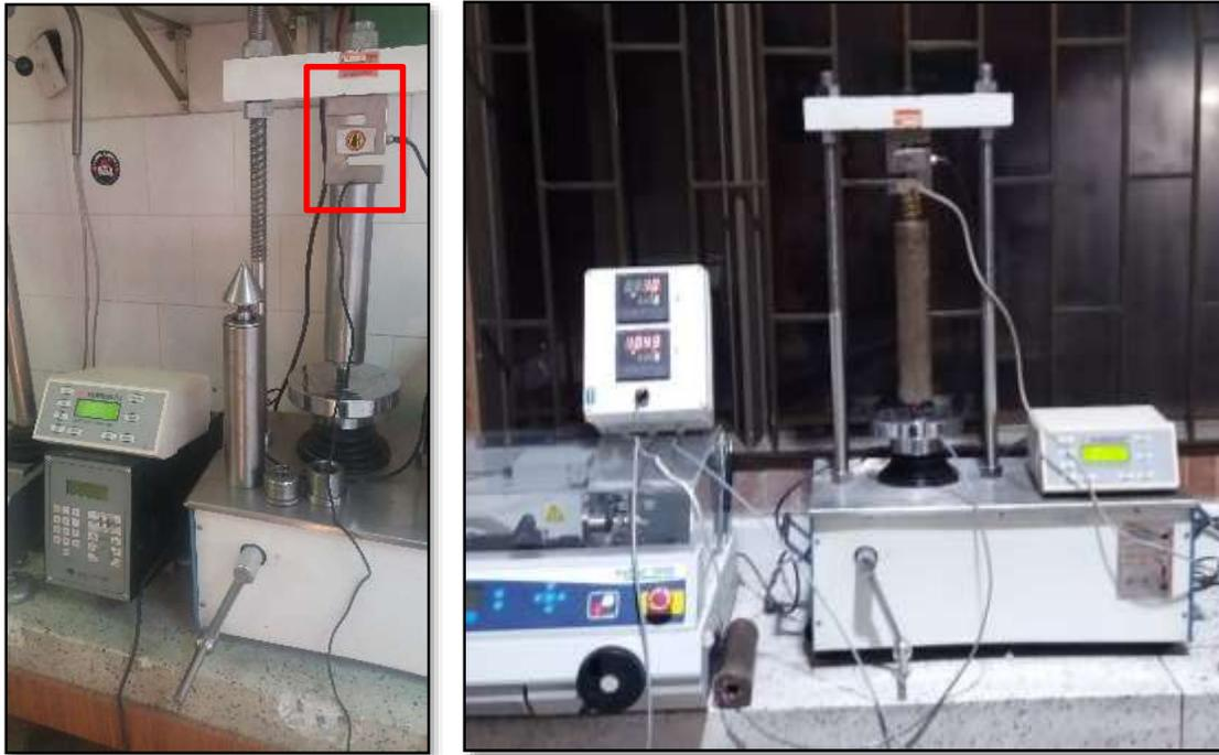
Figura 5-5. Calibración del cono instrumentado con celda de carga tipo S (Laboratorio de Ingeniería Civil de la Universidad Distrital Francisco José de Caldas). Fuente: propia.
