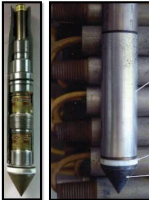
Figura 2-35. Corte de piezocono con visualización de galgas extensométricas. Fuente: Robertson P. k. (2015).
