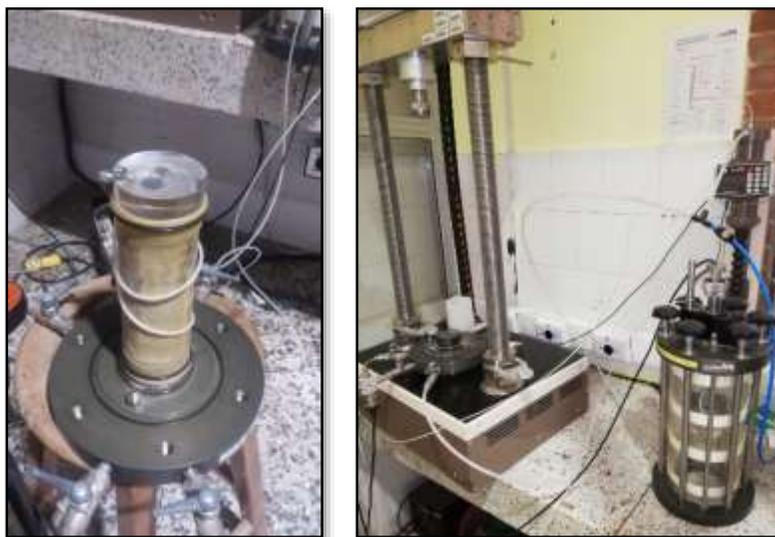
Figura 6-11. Ensayo triaxial UU (Laboratorio de ingeniería Civil de la Universidad Distrital).
