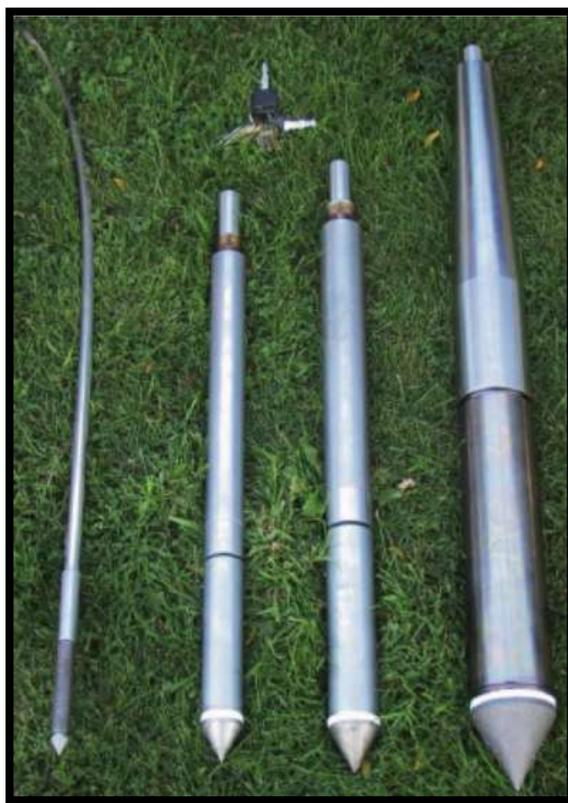
Figura 4-6. Rango de tamaños de conos en el ensayo CPT (2 cm<sup>2</sup>, 10 cm<sup>2</sup>, 15 cm<sup>2</sup>, 40 cm<sup>2</sup>). Fuente: Robertson & Cabal (2010).
