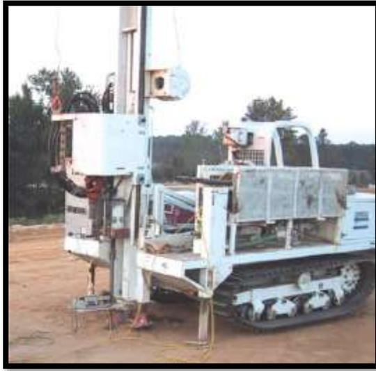
Figura 2-9. Máquina de empuje hidráulico anclado. Fuente: Robertson & Cabal (2010).
