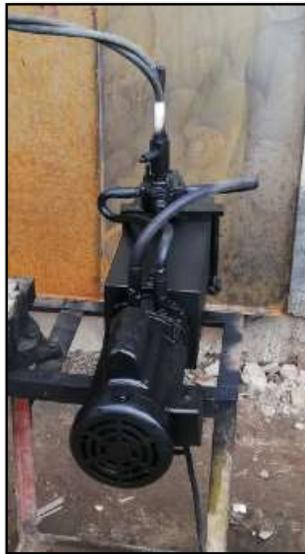
Figura 5-1. Unidad hidráulica. Fuente: propia.
