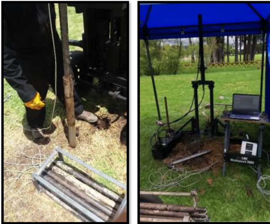
Figura 7-1. Penetración con el cono propuesto en el Sitio de Investigación 1 (ECI). Fuente: propia.
