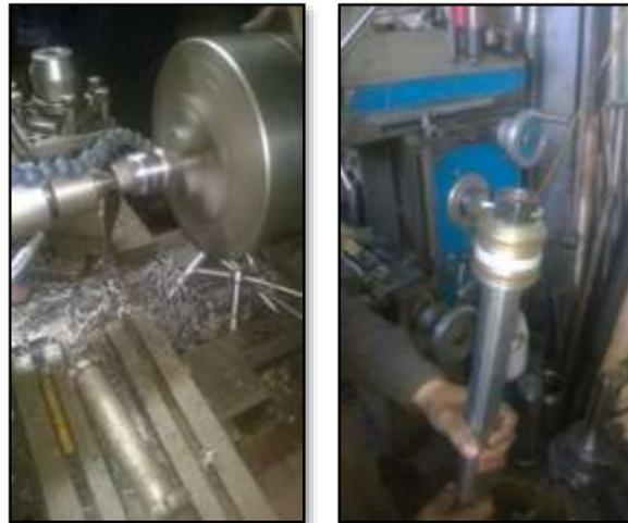
Figura 5-2. Fabricación cilindro hidráulico. Fuente: propia.
