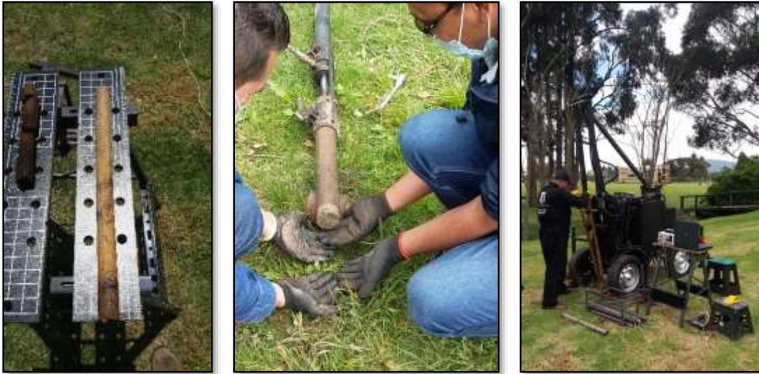
Figura 6-6. Exploración en la ECI por el método convencional (muestras tipo Shelby). Fuente: propia.
