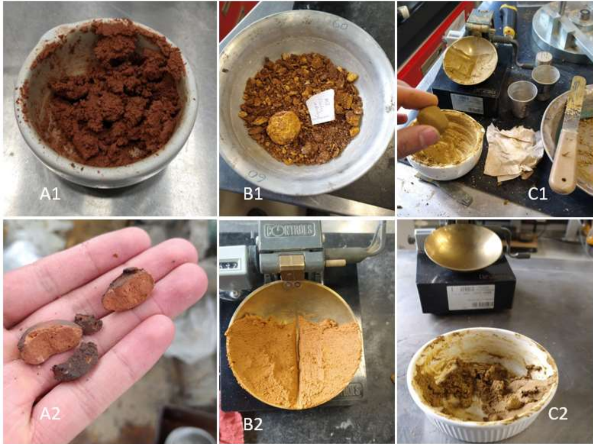
Imagen 16. Ensayo límite líquido sobre muestras alteradas e inalteradas: A1 y A2) Muestra 4 (Tierra Negra): hidratación y muestra seca límite líquido; B1 y B2) Muestra 4 (SIL): secada al aire y ejecución ensayo en cazuela Casagrande; C1 y C2) Muestra 6 (SIL): ejecución ensayo límite líquido y plástico e hidratación muestra.
