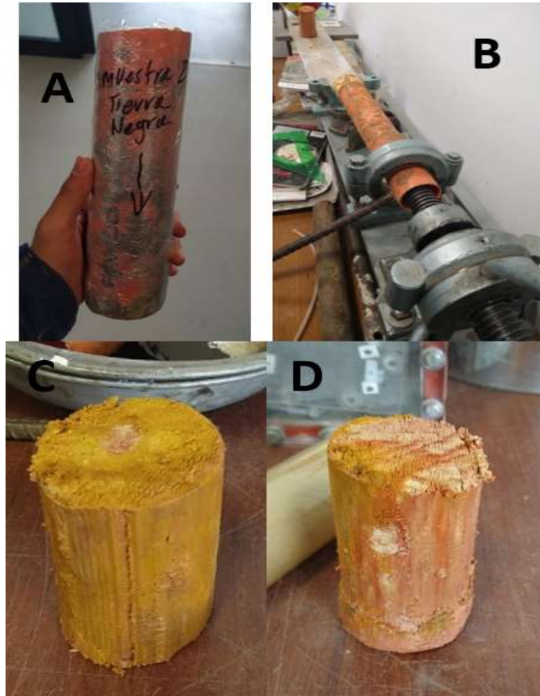
Imagen 9. Apariencia típica muestras sector de Tierra Negra, Ventaquemada, Boyacá para la visita No. 1, en A) Embalaje de muestras para conservar sus propiedades, B) mecanismo para la extracción de muestras (de tubo Shelby), C) y D) muestras típicas encontradas en la localidad de Tierra Negra, arcilla gris amarillenta y arcilla gris rojiza respectivamente.
