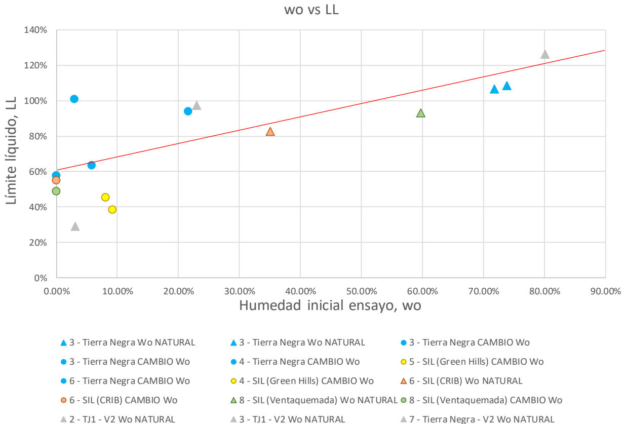
Figura 65. Relación de proporcionalidad entre la humedad inicial del espécimen y su límite líquido.
