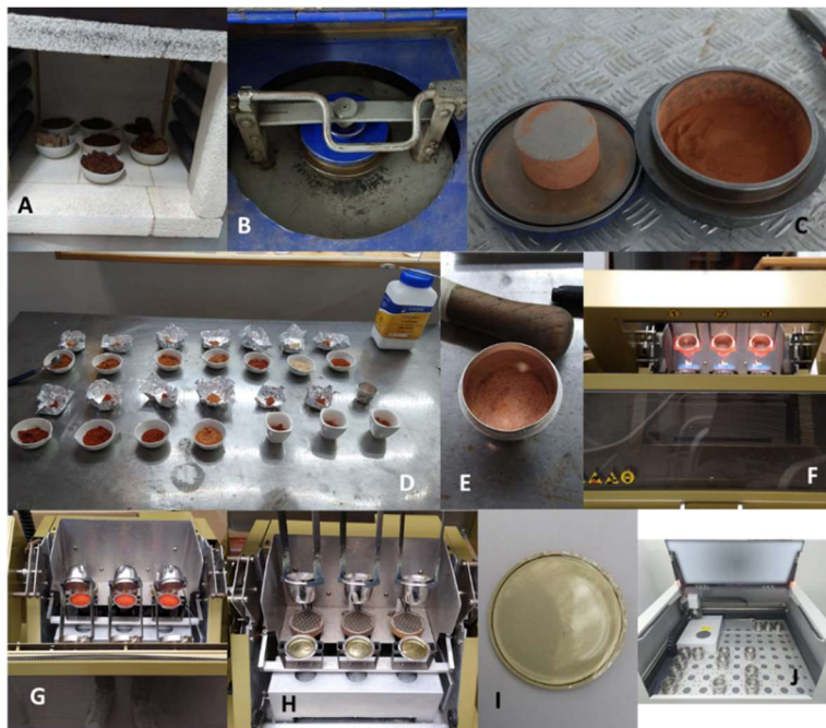
Imagen 11. Preparación de muestras para análisis de fluorescencia de rayos X; A) muestra secada al horno para determinación de humedad y pulverización; B) equipo para pulverizar muestras; C) muestra pulverizada (muestra 7); D) separación de 1 gramo de muestra calcinada; E) mezcla homogénea de fundente y material; F) fusión de mezcla para producción de perlas; G), H) e I) perlas para análisis de fluorescencia de rayos X; y J) espectrómetro para XRF. Fuente: propia.
