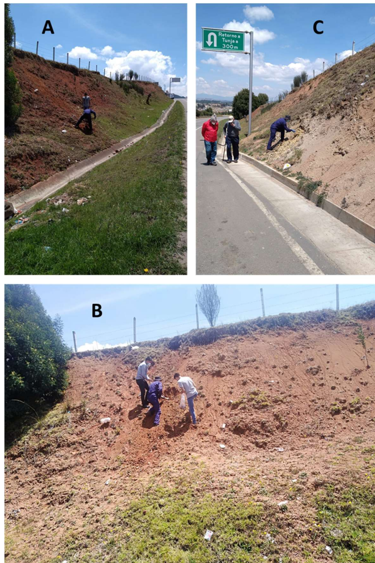
Imagen 6. Recolección de muestras en perfil TJI-V2. A) Toma de muestras en el mismo perfil muestreado durante visita No.1 (K6+200), se presenta la recolección de estas sobre la pendiente de 26° del talud; B) Toma de muestras en la pendiente de 34° del talud ubicado en el K6+200, a la izquierda Yeison Pérez Aguirre; y C) Toma de muestras superficiales sobre talud situado en el K6+100, a la izquierda los profesores José María Jaramillo Mejía y Manuel García López.
