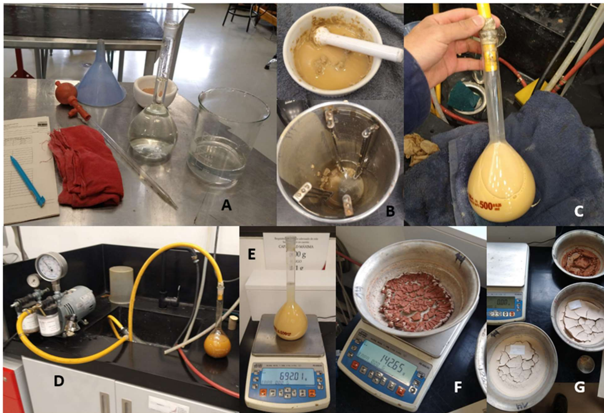
Imagen 17. Procedimiento para la ejecución del ensayo de gravedad específica de las partículas sólidas (Gs); A) instrumentos necesarios para el desarrollo del ensayo; B) preparación de la lechada, se usa vaso de dispersión para homogeneizar la mezcla; C) lechada puesta en picnómetro previo a la extracción de aire; D) configuración bomba de vacío para la extracción de aire al interior de la mezcla dispuesta en el picnómetro de 500 mL; E) medición de masa de picnómetro con suelo y agua; F) y G) medición de masa de suelo proveniente de mezcla en picnómetro, secada al horno a 110 °C durante aproximadamente 24 horas.
