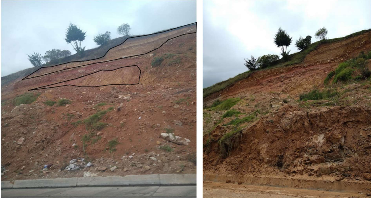
Imagen 24. Movimiento complejo correspondiente a un deslizamiento rotacional retrogresivo en el municipio de Ventaquemada, en la fotografía de la izquierda se puede identificar un escarpe de menor magnitud, al fondo se identifica el flanco derecho y escarpe principal del deslizamiento. La fotografía derecha fue tomada tiempo después, en el mismo lugar, mostrando el avance del deslizamiento; el material situado en la parte superior se transporta sobre el deslizamiento más antiguo, por tal razón, no es posible identificar el escarpe de menor magnitud. Fuente propia.
