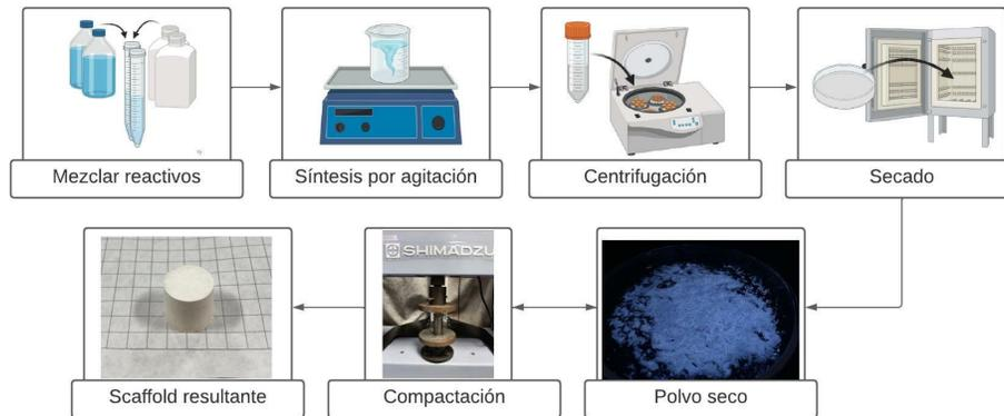
Figura 3.4: Diagrama del proceso de síntesis de *scaffold* de PEG-nHa-PC con variaciones en la composición.
