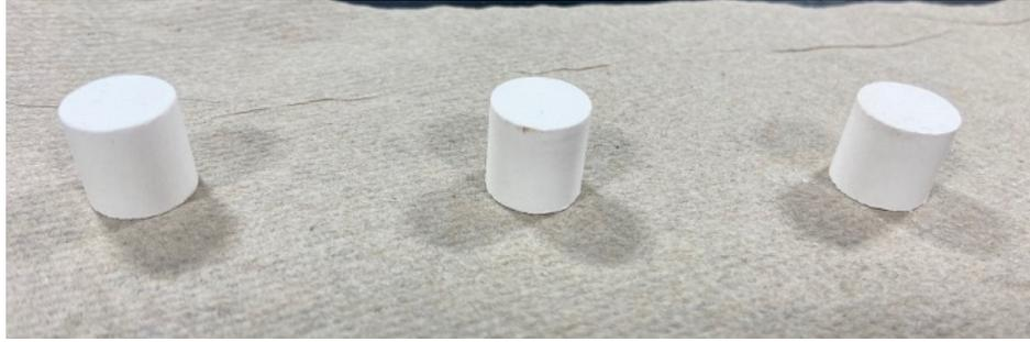
Figura 4.9: Probetas obtenidas después de compactar los polvos de PEG-nHA-PC.
