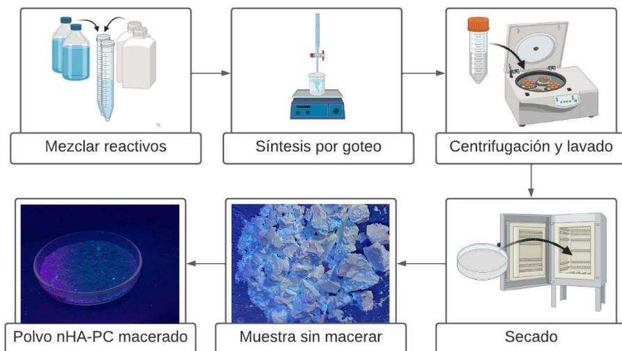
Figura 3.3: Diagrama del proceso de síntesis de nHA-PC.
