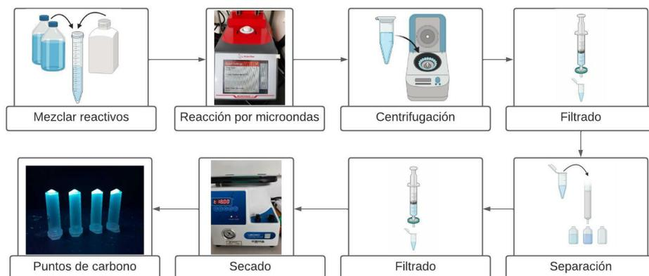
Figura 3.2: Diagrama del proceso de síntesis de PC.
