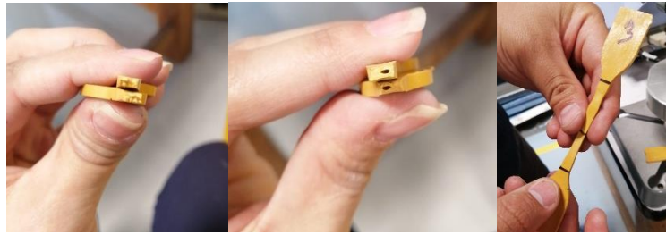
Figura 28 Figura de la falla de las muestras 90-10
