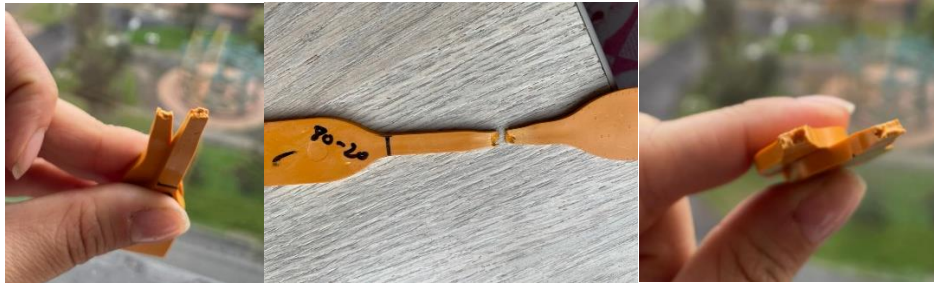
Figura 29. Figura de la falla de las muestras 80-20
