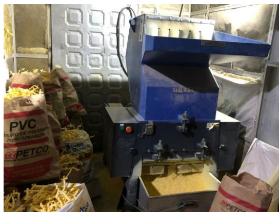
Figura 3. Subproducto y peletizadora
