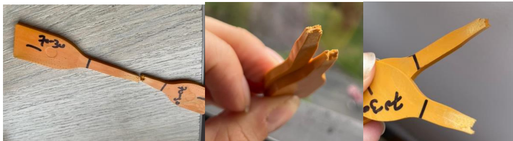
Figura 30. Figura de la falla de las muestras 70-30
