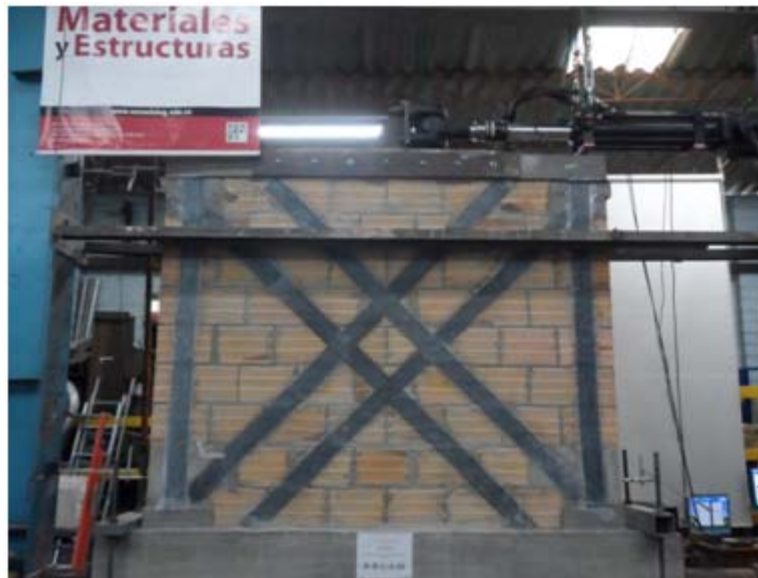
Figura 5-26 Montaje del ensayo dinámico del espécimen R-D-L-2-DI. Fuente: El autor
