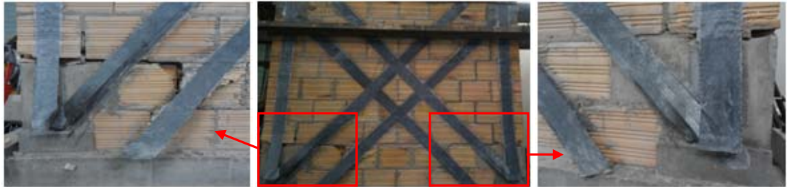
Fallas en unidades y material de refuerzo del espécimen R-D-L-2-DI
