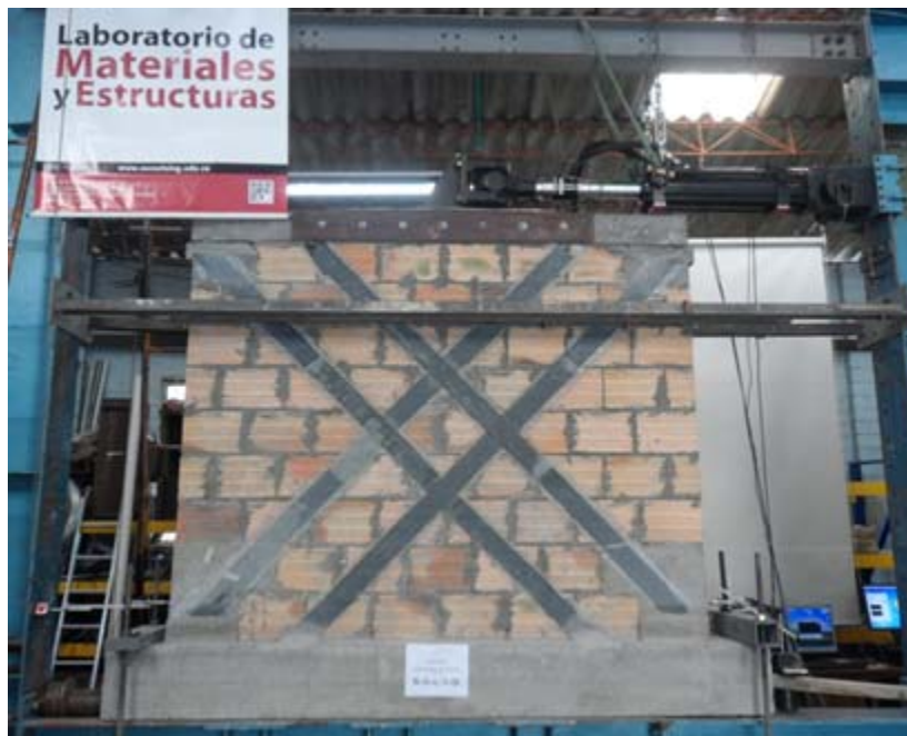
Figura 5-24 Montaje del ensayo dinámico del espécimen R-D-L-1-DI.
