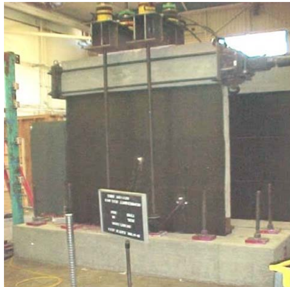
Figura 2-28 Montaje del ensayo de muro reforzado completamente. Fuente: Tomado de Mosallam & Banerjee (2011). p. 1659.
