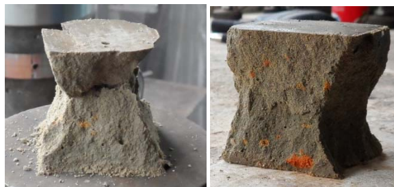
Figura 5-3 Falla de un cubo de mortero durante el ensayo de resistencia a la compresión
