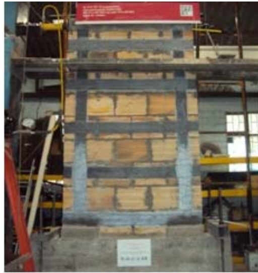
Figura 5-15 Montaje del ensayo monotónico del espécimen R-G-C-2-ES. Fuente: El autor.
