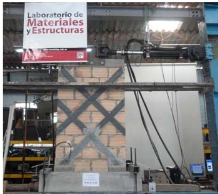
Figura 5-18 Montaje del ensayo dinámico del espécimen R-D-C-1-DI. Fuente: El autor.
