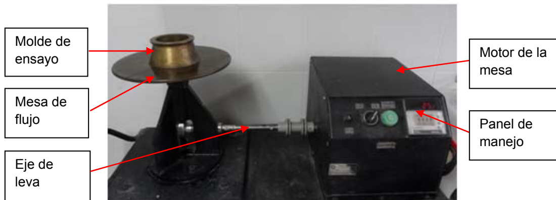
Figura 4-6 Montaje del ensayo de fluidez en morteros Fuente: El autor
