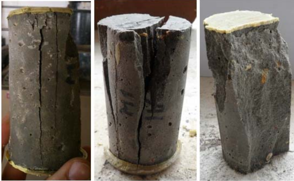
Figura 5-6 Modos de falla obtenidos en los cilindros de mortero en el ensayo de resistencia a la compresión Fuente: El autor
