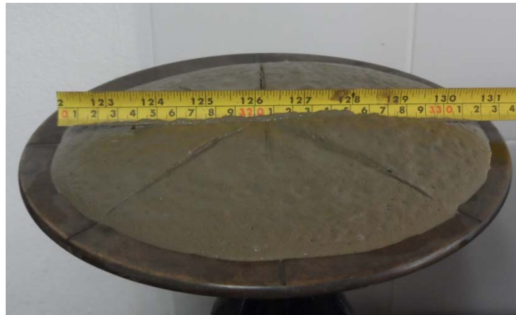
Figura 5-7 Realización del ensayo de fluidez en morteros a) Montaje general b) Detalle de las medidas de los diámetros.
