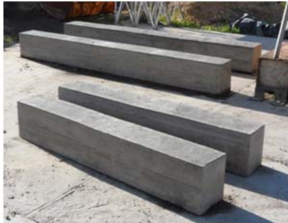
3) Producto final una vez fraguado y desencofrado
