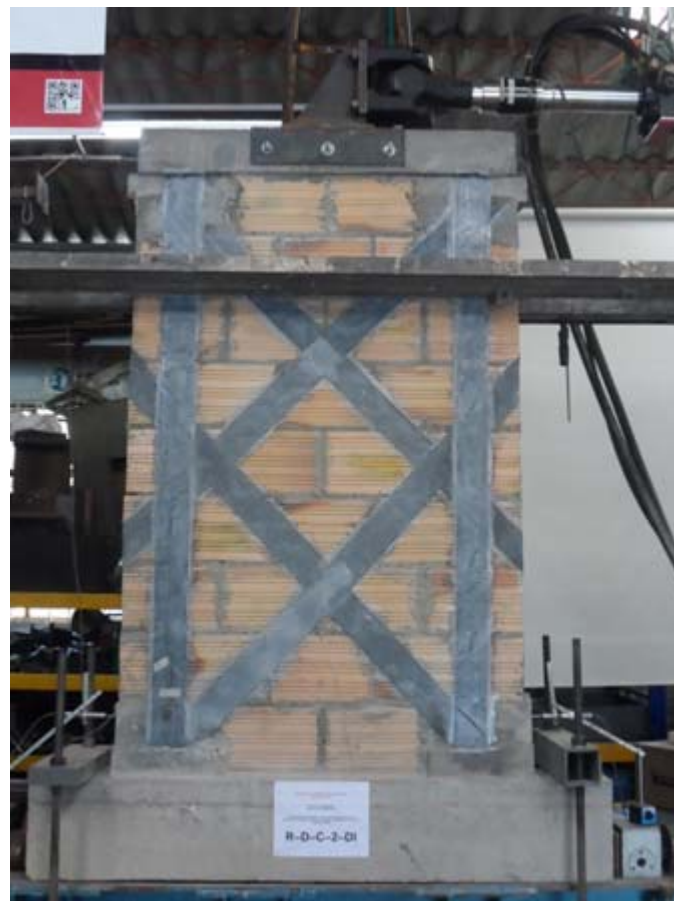
Figura 5-20 Montaje del ensayo dinámico del espécimen R-D-C-2-DI. Fuente: El autor
