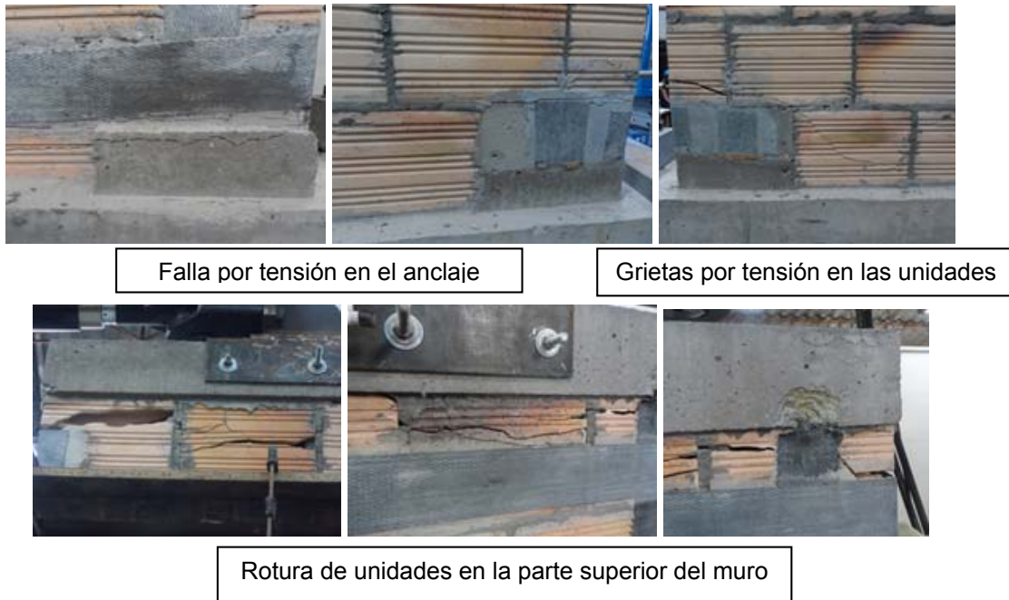
Figura 5-23 Fallas del espécimen R-G-C-1-DI
