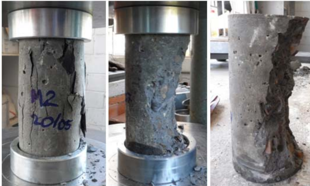
Figura 5-8 Fallas de los cilindros de concreto durante el ensayo de resistencia a la compresión. Se destaca la falla cónica. Fuente: El autor
