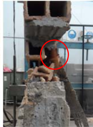
Fractura de unidades por la adherencia con la fibra
