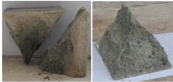
Figura 5-4 Modos de falla obtenidos en los cubos de mortero en el ensayo de resistencia a la compresión
