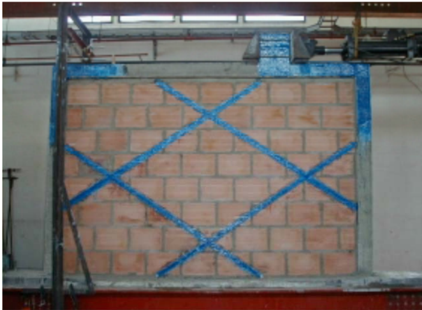
Figura 2-31 Montaje de muro a escala real
