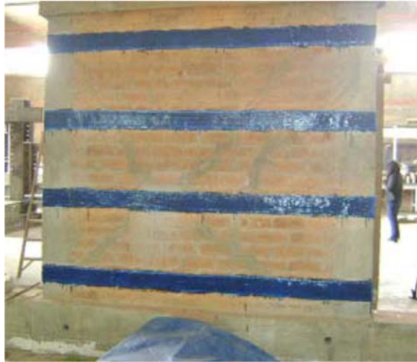
Figura 2-29 Muro resanado y reforzado con fibra de carbono Fuente: Tomado de San Bartolomé & Coronel (2011). p. 6.
