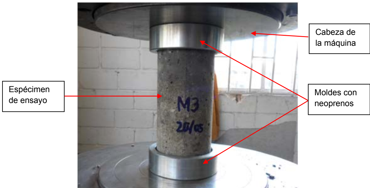
Figura 4-7 Montaje del ensayo de resistencia a la compresión en cilindros de concreto
