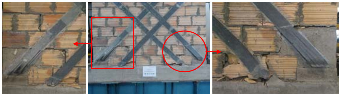
Fallas en unidades y material de refuerzo del espécimen R-D-L-1-DI
