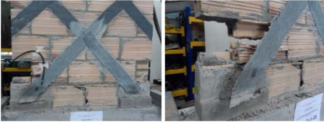
Rompimiento de unidades de mampostería, desprendimiento y rotura de la fibra
