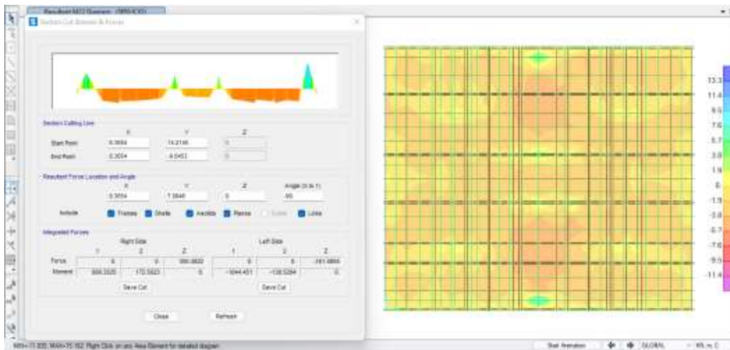
Figura 39: Diagrama de momentos en kN\ m\ M^2\ (YY) eje F – método Winkler
