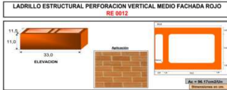
Figura 13: Esquema dimensiones de ladrillo estructural (fuente propia)
