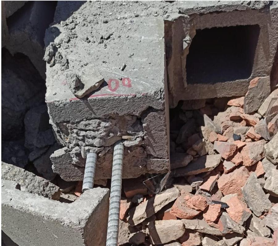
*Foto 8. Posición de la barra de refuerzo dentro de la celda.*
