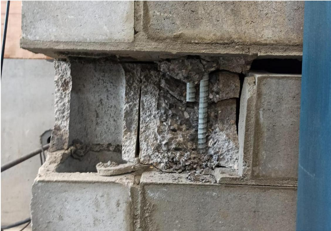
*Foto 7. Falla explosiva del muro 5-2500-C-T-1.23B*
