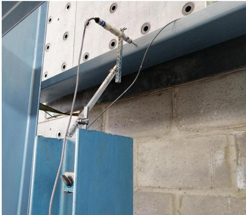
*Foto 5. LVDT ubicado en el apoyo superior para medir desplazamientos del perfil de apoyo.*
