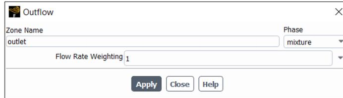
**Figura 58.** Configuración del Outlet o salida.
