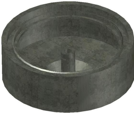
**Figura 34.** Estructura sedimentador primario
