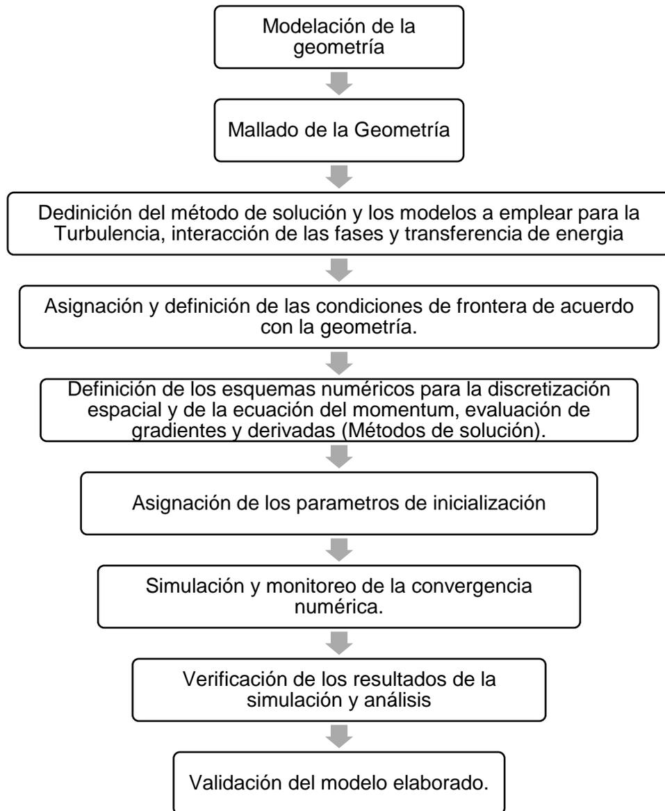
**Figura 15.** Pasos metodológicos para la modelación del sedimentador primario.
