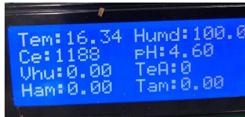
Figura 13 Medición del sensor MEL-10 A para solución calibradora a 1413 \mu\text{S}/\text{cm}
