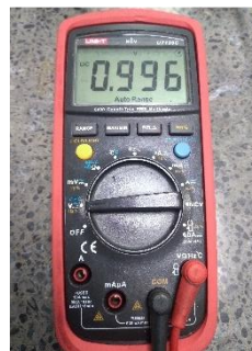
Figura 20 Voltaje de salida sensor capacitivo de humedad V1.2
