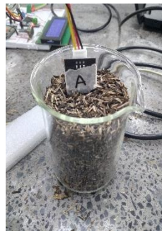
Figura 19 Sensor capacitivo de humedad V1.2 en sustrato seco
