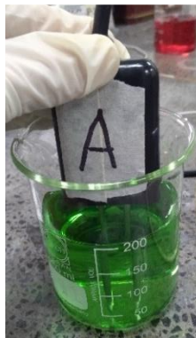
Figura 15 Sensor pH Soil A en solución tampón pH 7.00
