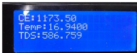
Figura 18 Medición del sensor TDS Meter para solución calibradora a 1413 \mu\text{S}/\text{cm}
