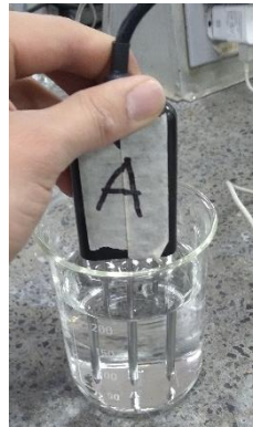
Figura 12 Sensor MEL-10 A en solución calibradora a 1413 \mu\text{S}/\text{cm}
