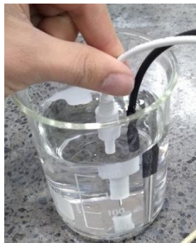
Figura 17 Sensor TDS Meter y sonda en solución calibradora a 1413 \mu\text{S}/\text{cm}
