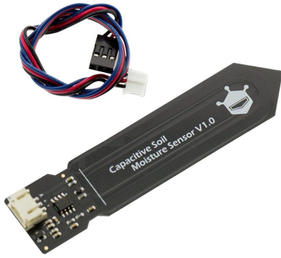
Figura 5: Sensor capacitivo, anticorrosivo.
