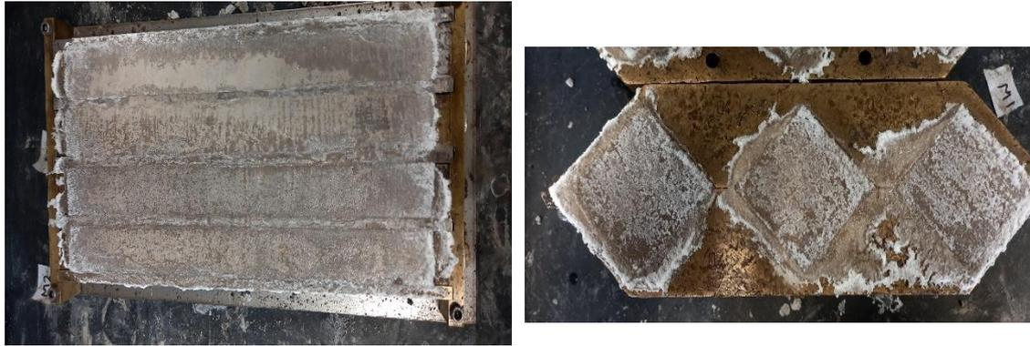
**Figura 28. Eflorescencia. Concentración 20,000 mg/L (derecha) y 30,000 mg/L (izquierda)**
