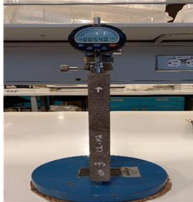
**Figura 11. Ensayo de expansión en barras de mortero**
