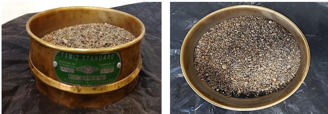
**Figura 3. Arena, material retenido en tamiz No. 16**
