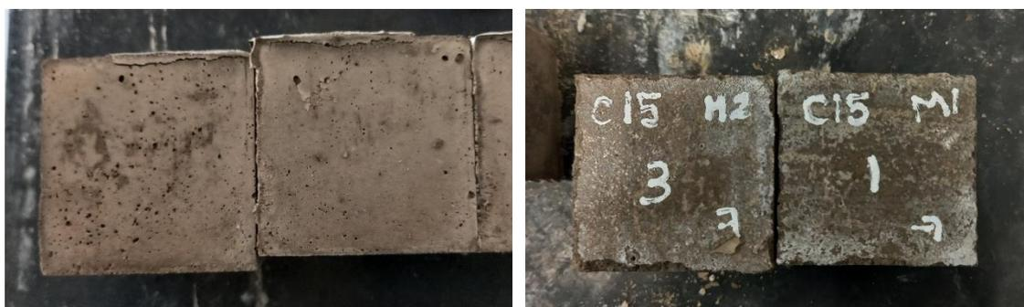
Figura 27. Desprendimiento de material. Concentración 10,000 mg/L (izquierda) y 20,000 mg/L (derecha)
