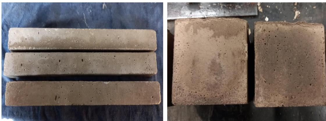
Figura 26. Porosidad en los especímenes. Concentración 10,000 mg/L (derecha) y 15,000 mg/L (izquierda)
