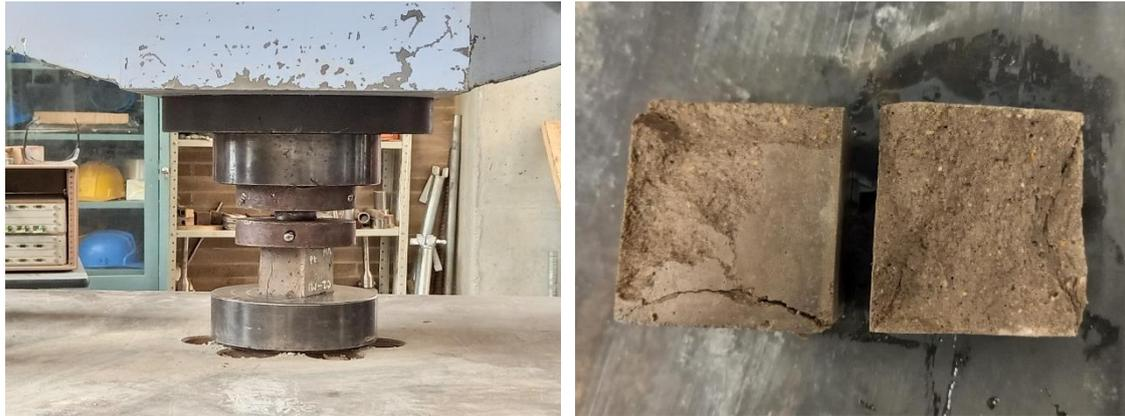
**Figura 10. Ensayo de resistencia a la compresión**
