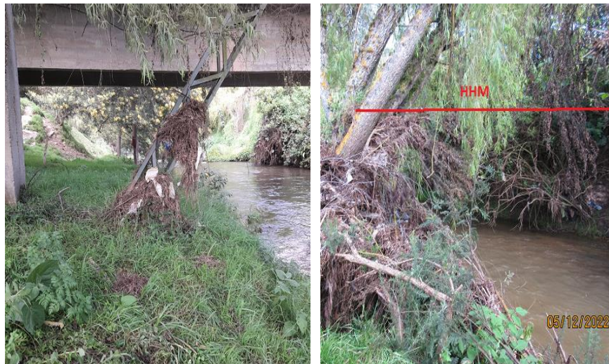
Fotografía 6. Huella de la creciente máxima Fuente: Elaboración propia con suministro del Ing. Abraham Salazar Hernández
