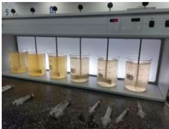
Imagen 24 Ensayo de Jarras mezcla rápida y floculación. Fuente: Autor
