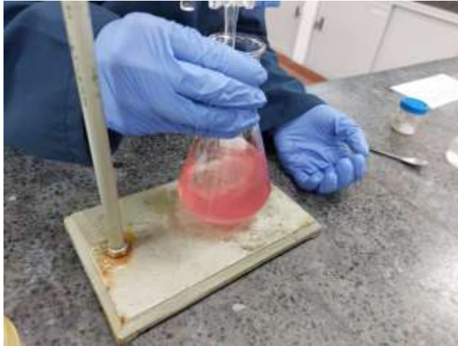
Imagen 6 Determinación de cloro residual y demanda de cloro. Fuente: Autor
