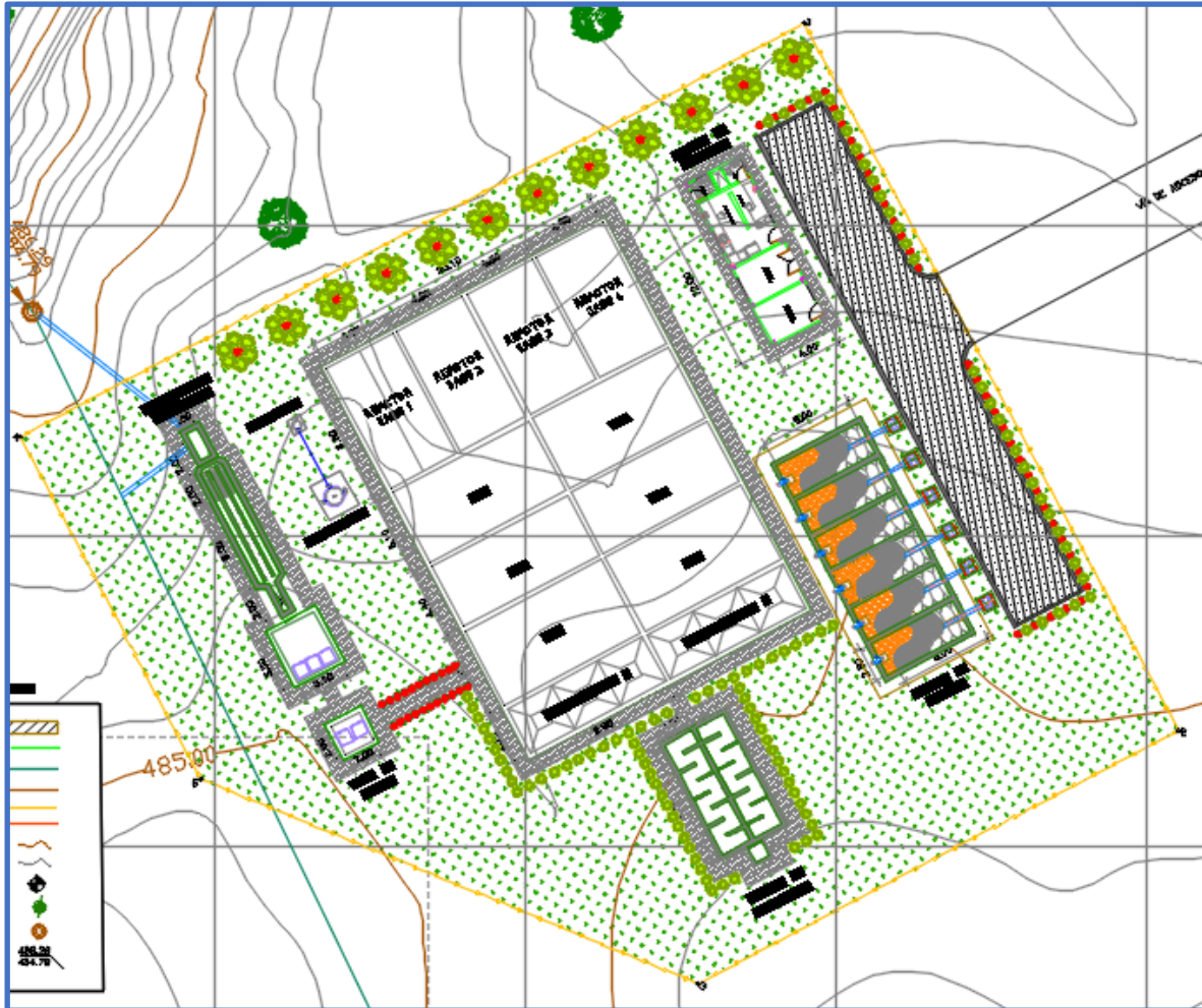
Ilustración 12 Planta General alternativa 3 UASB + RAP
